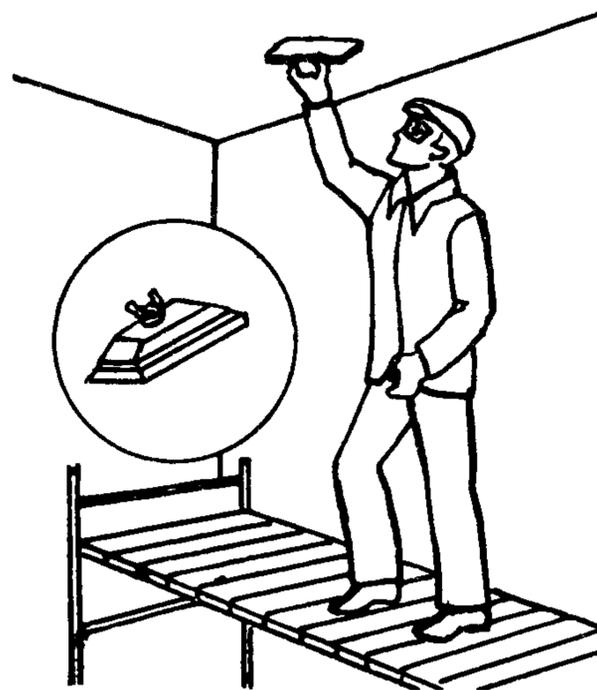
7 СПЛОШНАЯ ШПАКЛЕВКА ПОВЕРХНОСТИ; 540 мин;  $M_1$ ,  $M_2$ ; шпатели, ящики со шпаклевкой, столики-подмости
