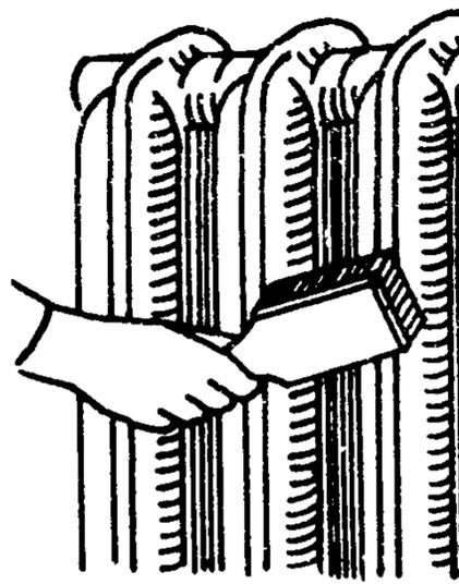
Маляр, работая шпателем как скребком, легкими скользящими ударами снимает с металлических поверхностей отвердевшие брызги раствора и окалину.
