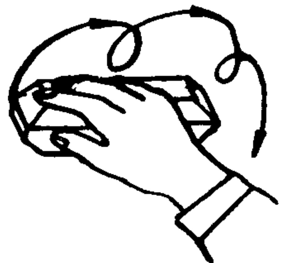
Высохшие подмазанные места маляр шлифует шкуркой, закрепленной в колодке. Шлифовку он выполняет круговыми движениями колодки до полного сглаживания подмазанной поверхности
