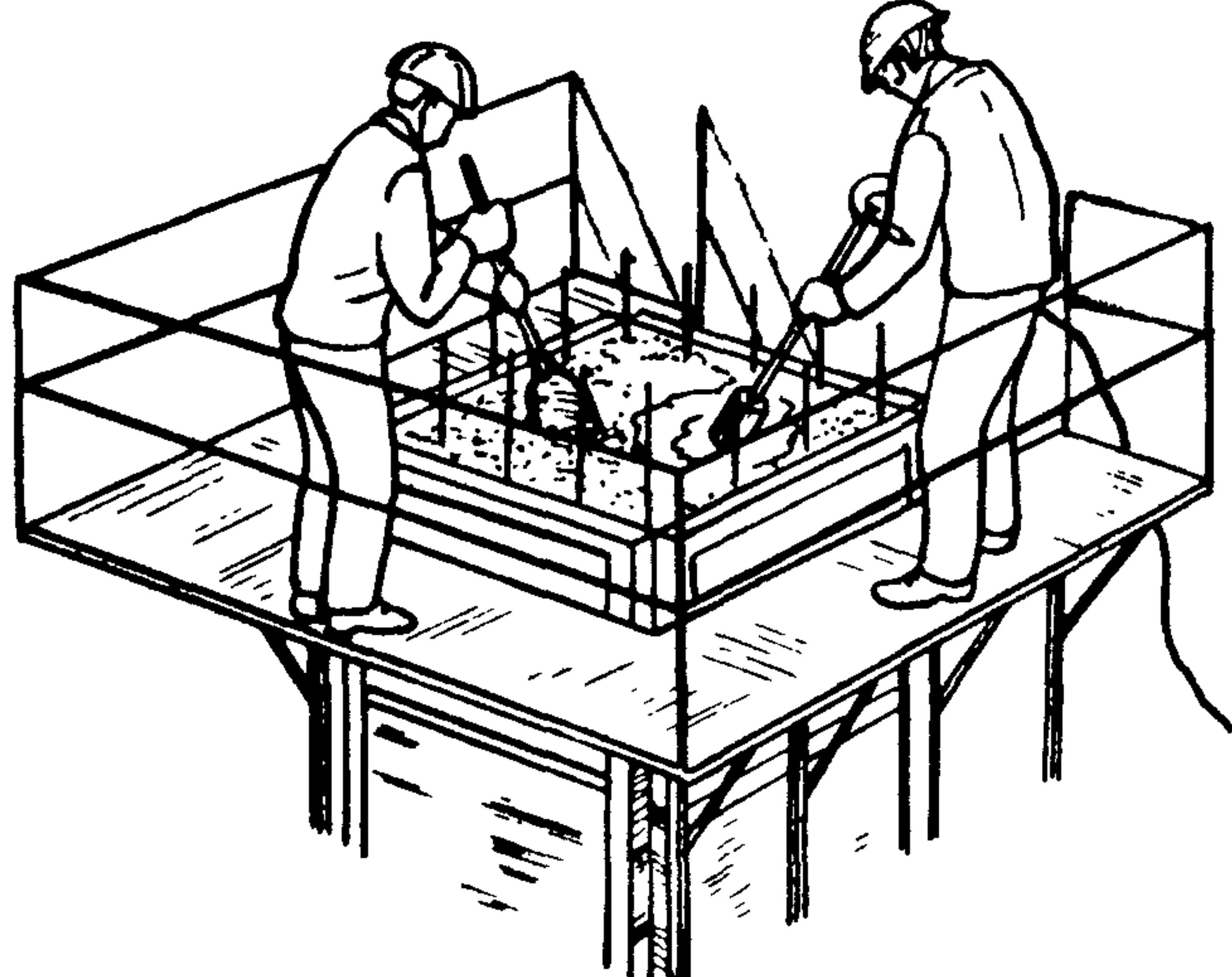
Бетонщики  $B_1$  и  $B_2$ , стоя на подмостях, погружают рабочую часть вибраторов в бетонную смесь на глубину 5–10 см и следят за тем, чтобы вибраторы не соприкасались с арматурой каркаса
