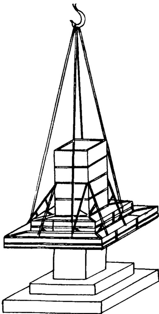
Слесари С<sub>1</sub> и С<sub>2</sub> стропят блок-форму за четыре монтажные петли и, убедившись в надежности строповки, отходят на безопасное расстояние. По их команде машинист крана осторожно снимает блок-форму с забетонированного фундамента и перемещает ее на площадку для очистки и смазки
