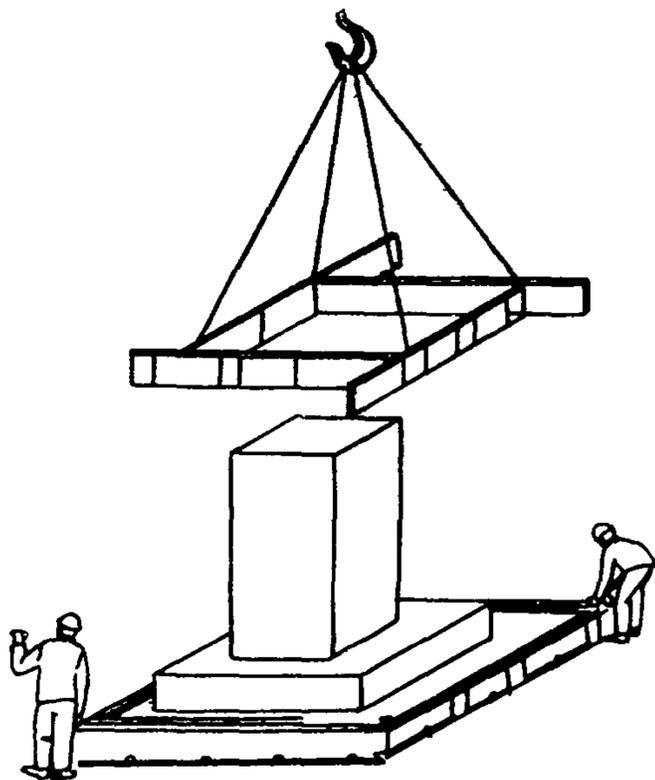
Слесари С<sub>1</sub> и С<sub>2</sub> ломами осторожно отрывают короб опалубки ступеней от бетона, строят его за четыре монтажные петли и отойдя на безопасное расстояние, подают команду машинисту крана поднять короб. Машинист поочередно снимает короба опалубки со ступеней фундамента и подает их на площадку для очистки и смазки
