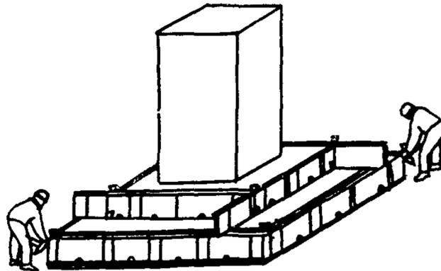
4 СТРОПОВКА И СНЯТИЕ КОРБОВ ОПАЛУБКИ СТУПЕНЕЙ; 25 мин; С<sub>1</sub>, С<sub>2</sub>; строп, ломы
