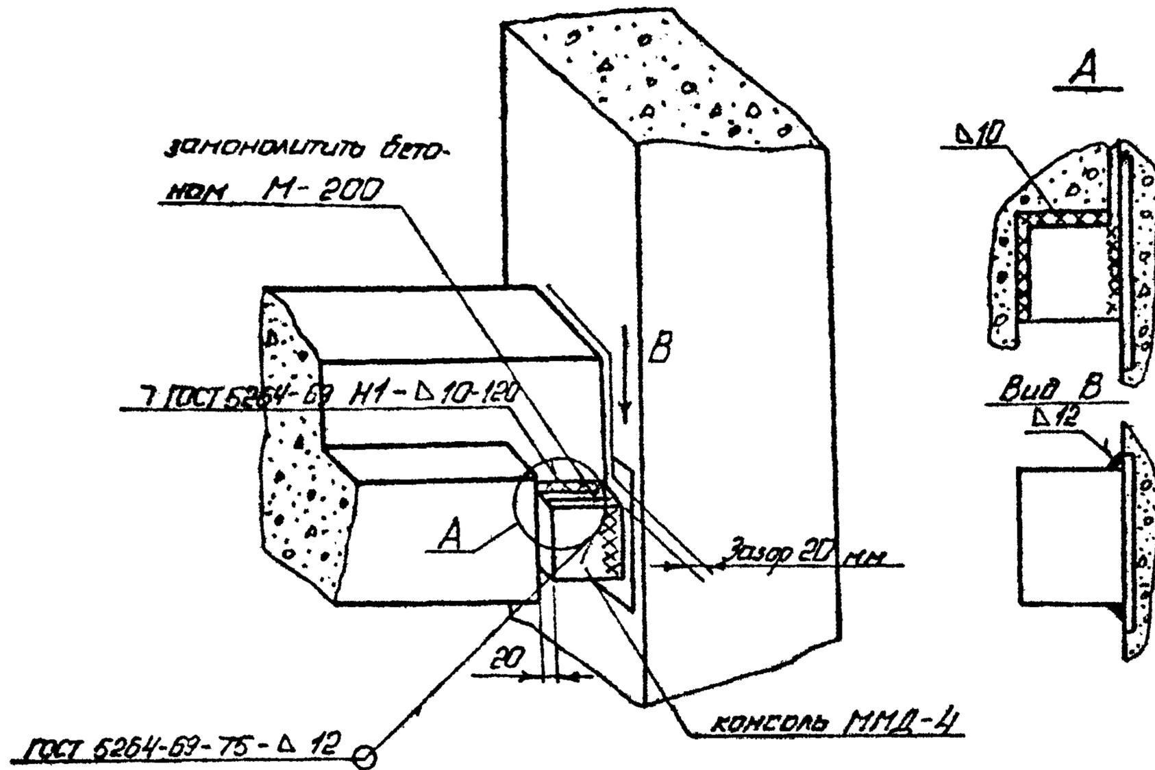
Узел сварки панелей наружных стен из легких бетонов
