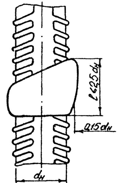
1; 2; 3; 4 - Последовательность ванной сварки стержней.
