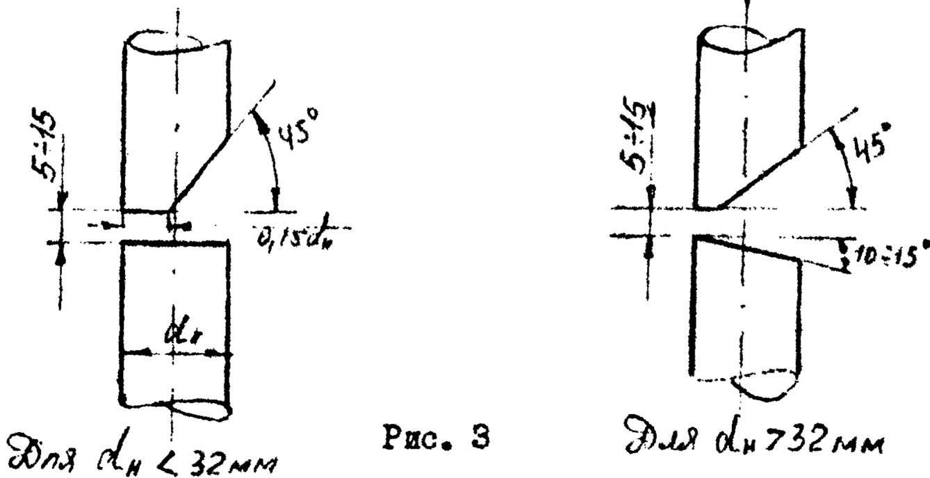
Величина зазора между торцами стержней должна быть в пределах от 5 до 15 мм. При зазоре, превышающем допустимый, сварка стержней производится с помощью арматурной вставки из той же стали, что и свариваемые стержни, длиной не менее 150 мм (см. рис. 4)
