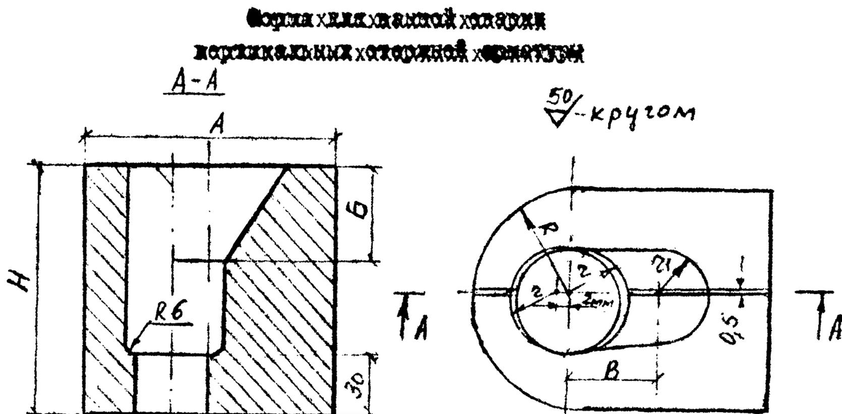
Рис. 1 Форма для ванночной сварки вертикальных стержней арматуры
