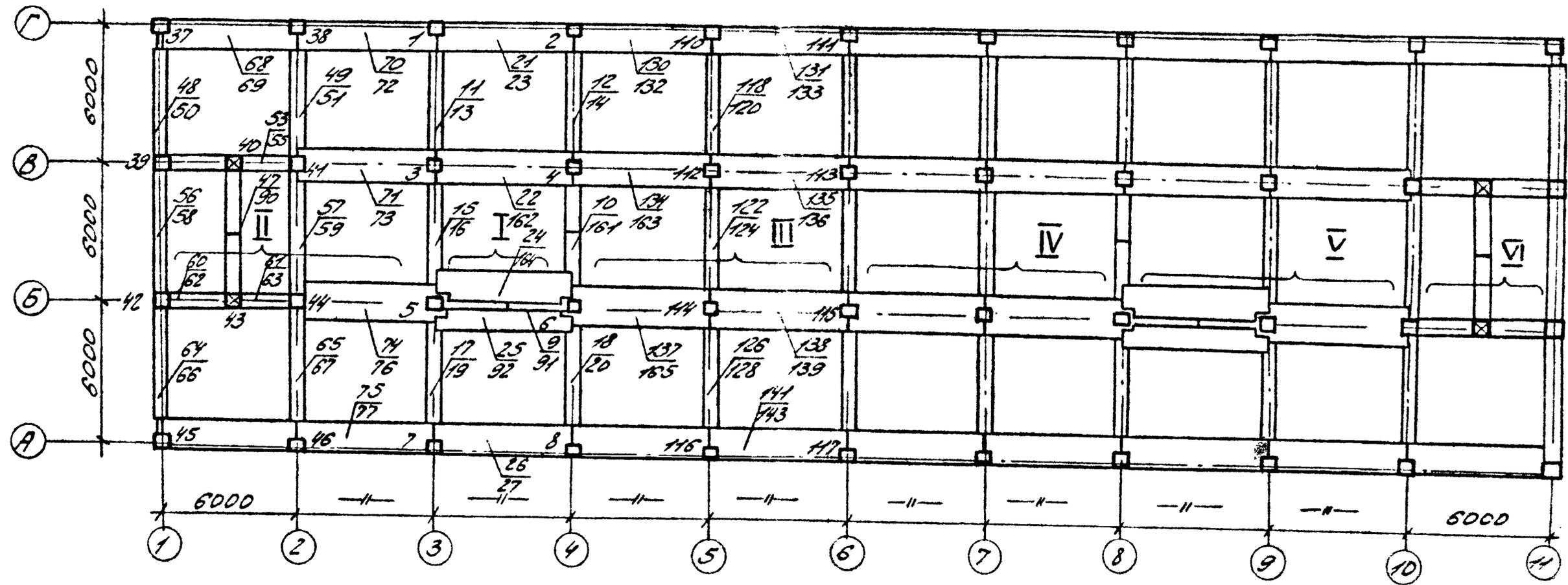
Последовательность сварки перегородок и рядовых плит
