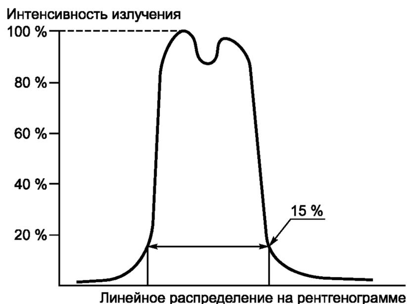
Рисунок 6 — Функция расширения линии
