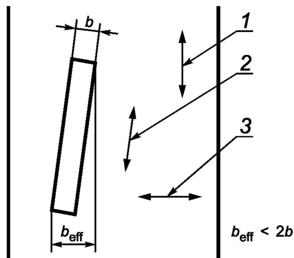
1 — направление проекции щели диафрагмы на РЕНТГЕНОГРАММУ; 2 — направление щели микроденситометра;
