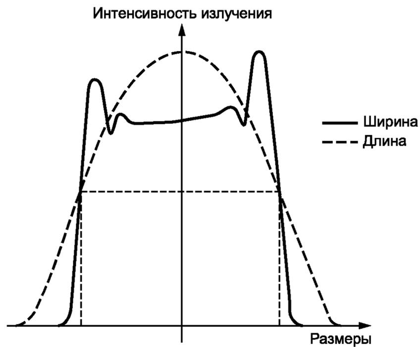
Рисунок С.2 — ФУНКЦИИ РАСШИРЕНИЯ ЛИНИИ для типичной РЕНТГЕНОВСКОЙ ТРУБКИ с большим ФОКУСНЫМ ПЯТНОМ ( $\ge 0,3 \text{ мм}$ )
