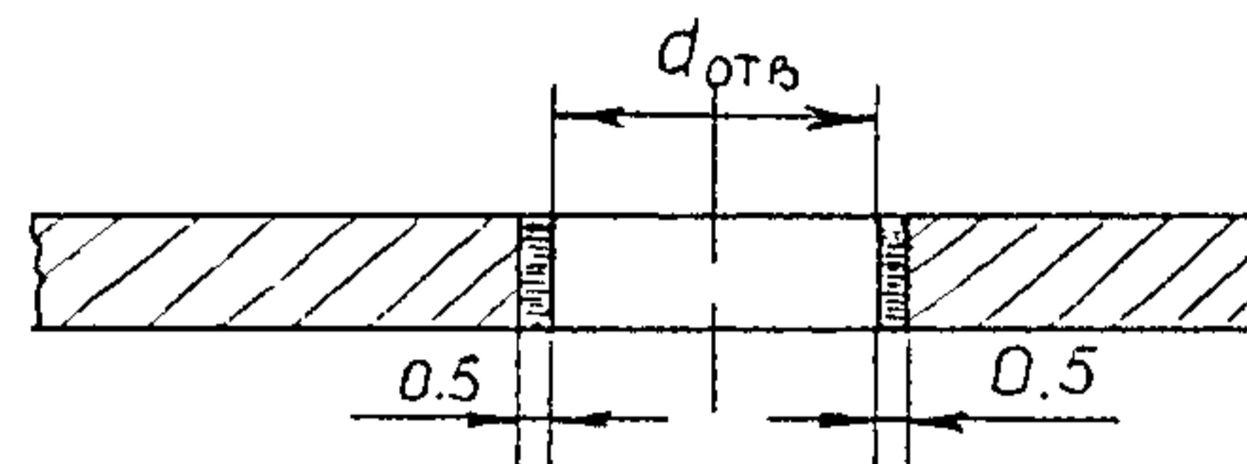
2. Для толстых листов, плит, пластин четвертькруговые уголковые трещины с двух сторон отверстия (см. эскиз)
