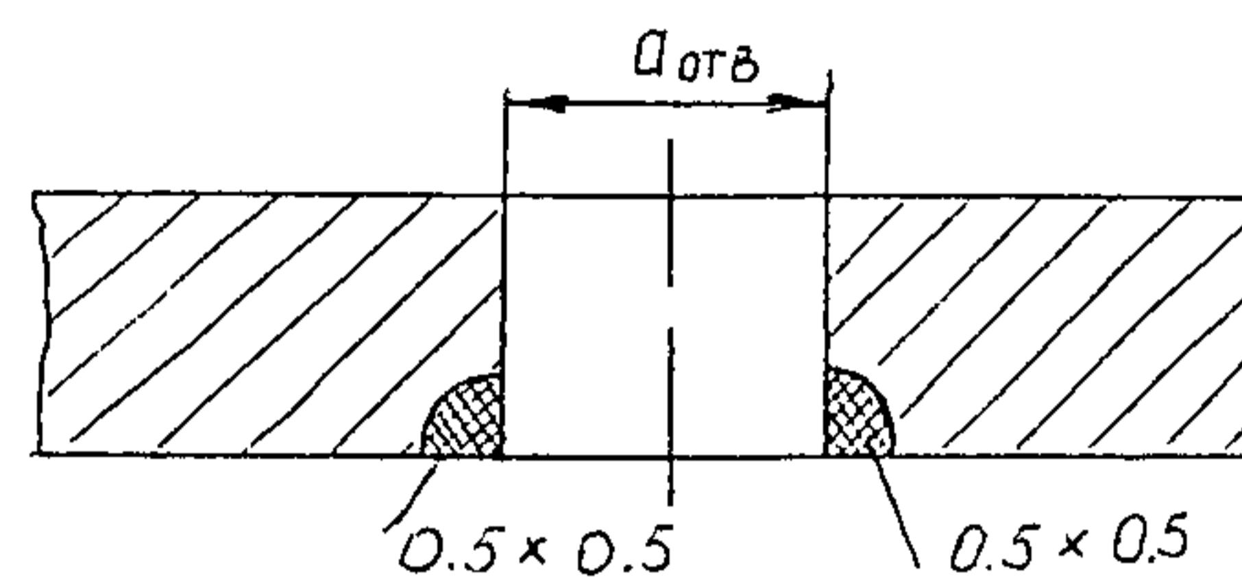
3. Для галтельных переходов поверхностная трещина (см. эскиз)
