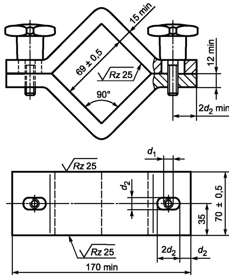
$d_1$  — диаметр резьбы;  $d_2$  — диаметр направляющей прорези
