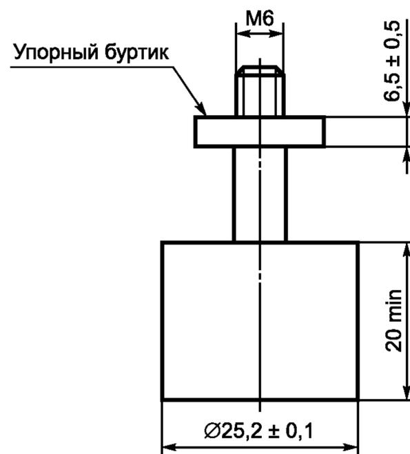
Рисунок 3 — Испытательный штамп площадью основания  $500 \text{ мм}^2$
