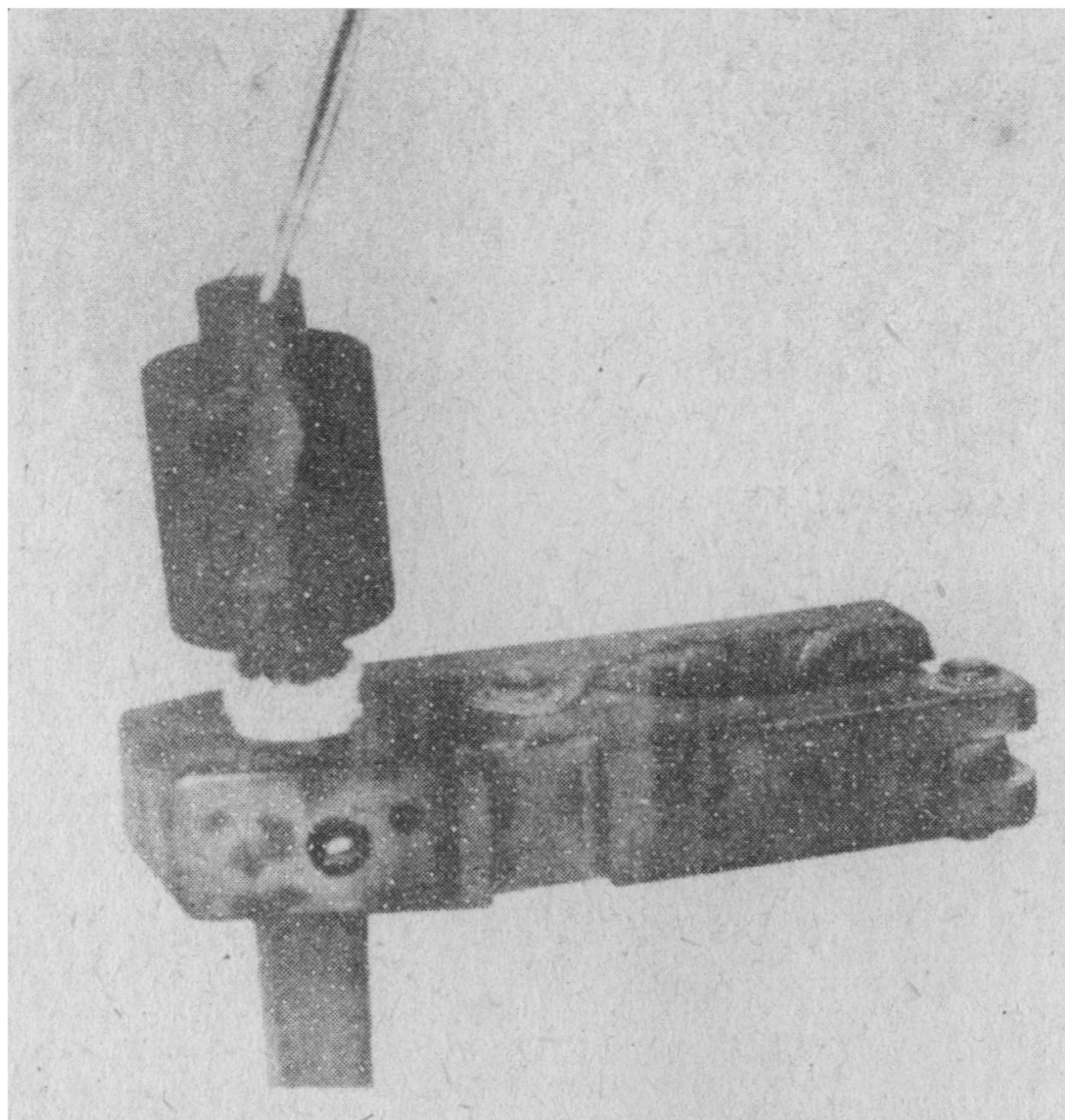
Рис. I5. Введение присадочного прутка из алюминиевой проволоки в кокиль термитного патрона марки АС при сварке алюминиевой жилы кабеля со стальным стержнем
