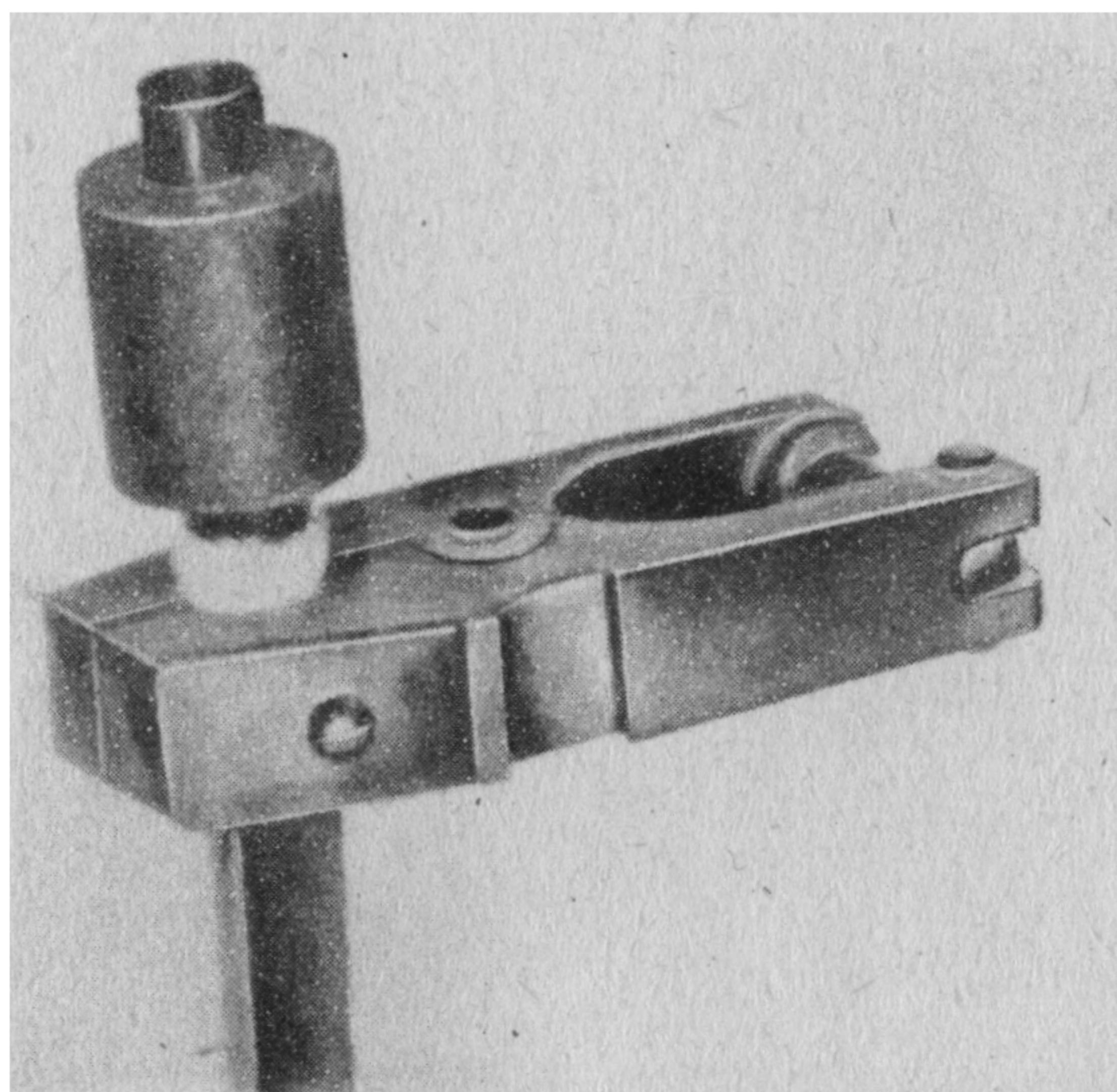
Рис.I4. Патрон марки АС с охладителем, установленный для сварки алюминиевой жилы кабеля со стальным стержнем
