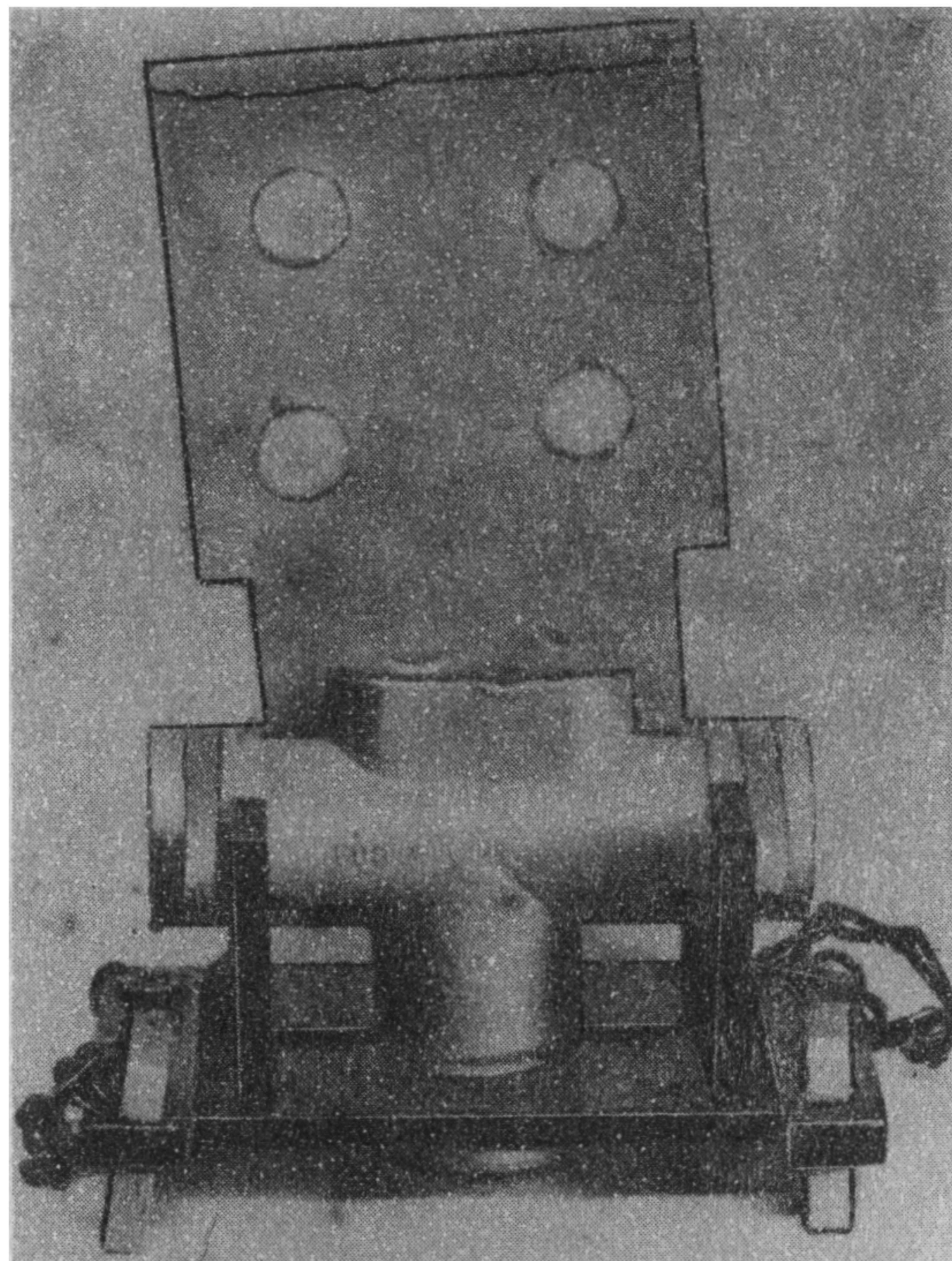
Рис.22. Контактная пластина, введенная в литниковое отверстие формы
