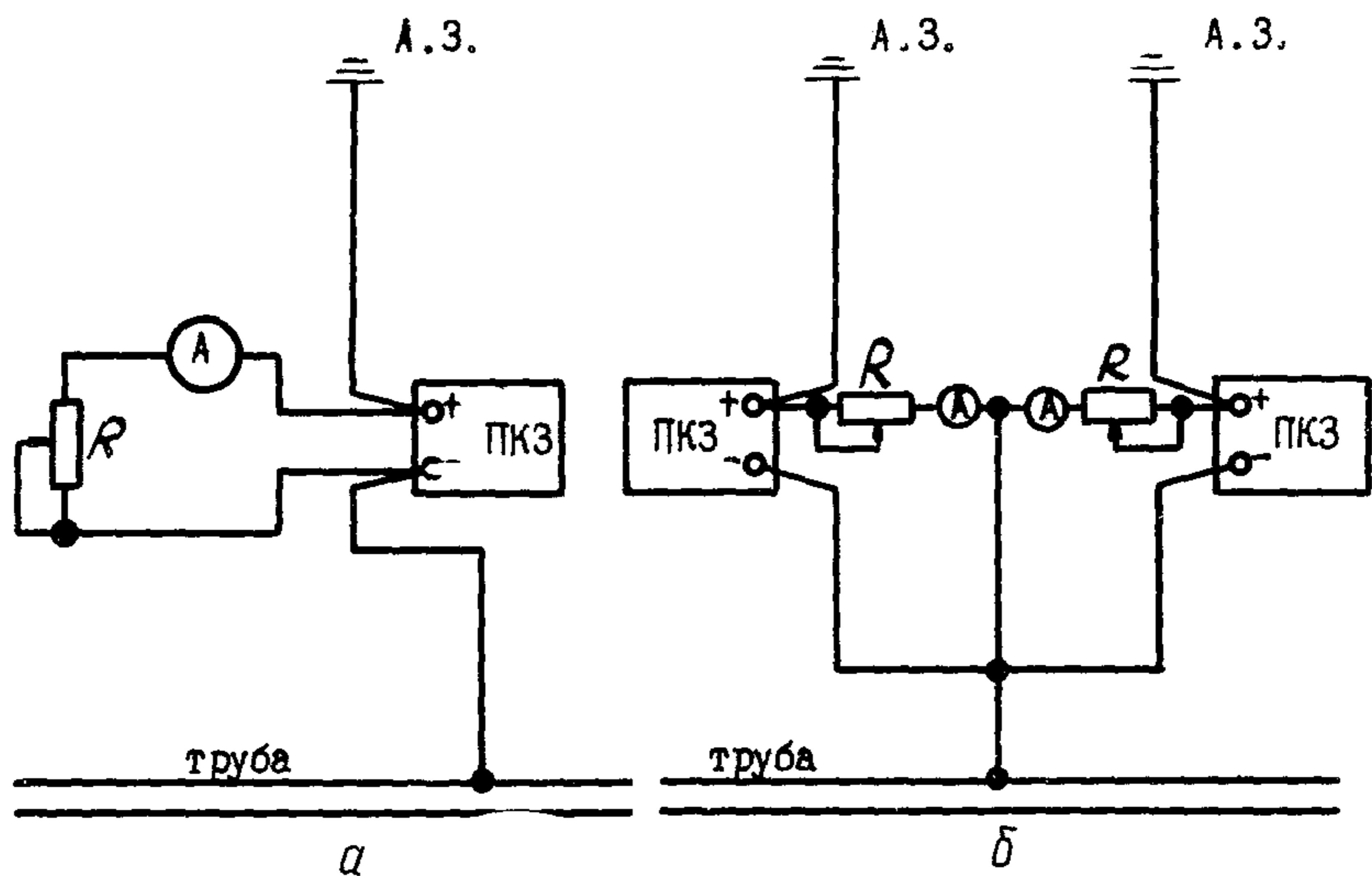
Рис.30. Схема включения приборов и устройств при испытании преобразователей катодной защиты в максимальном режиме:
