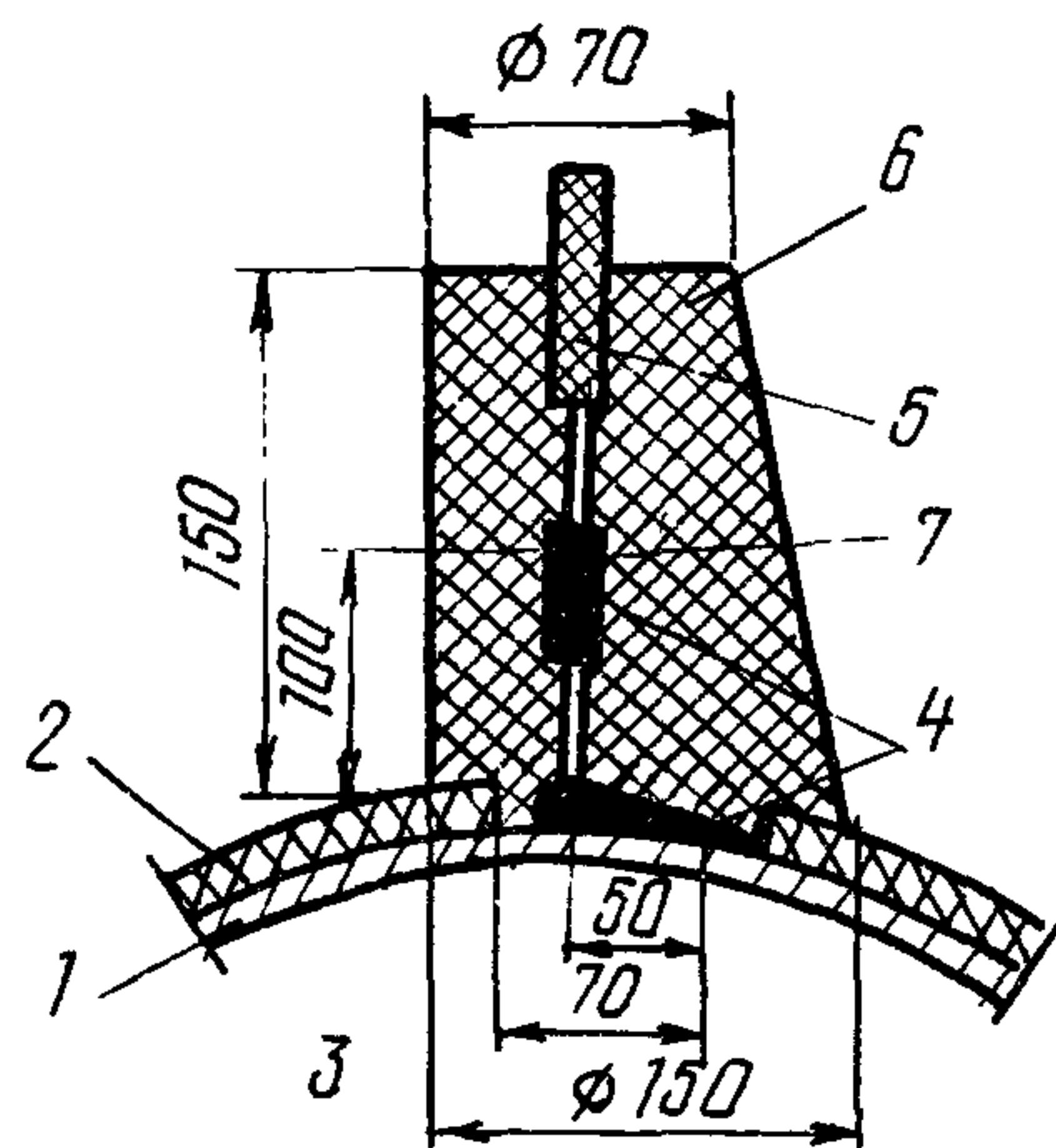
Рис.I8. Изолированное сварное соединение:
