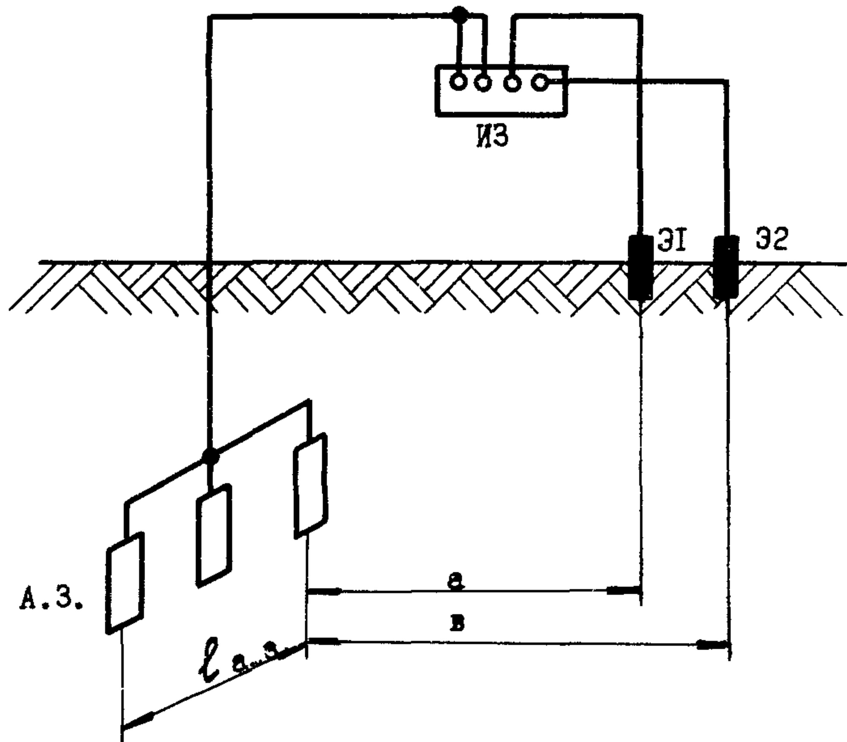
Рис.28. Схема измерения переходного сопротивления анодного заземления:
