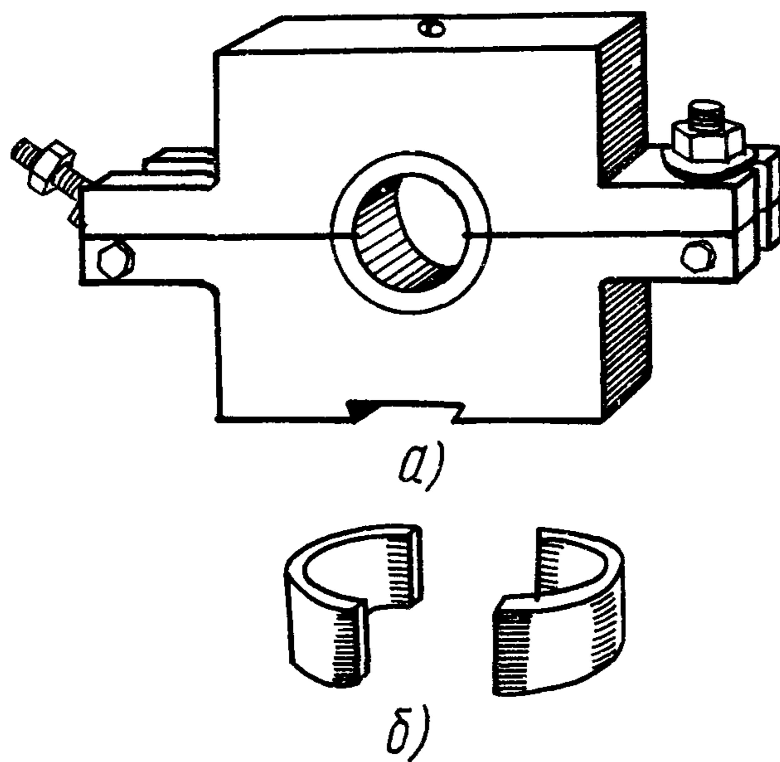
Рис.21. Охладитель со сменными вкладышами:
