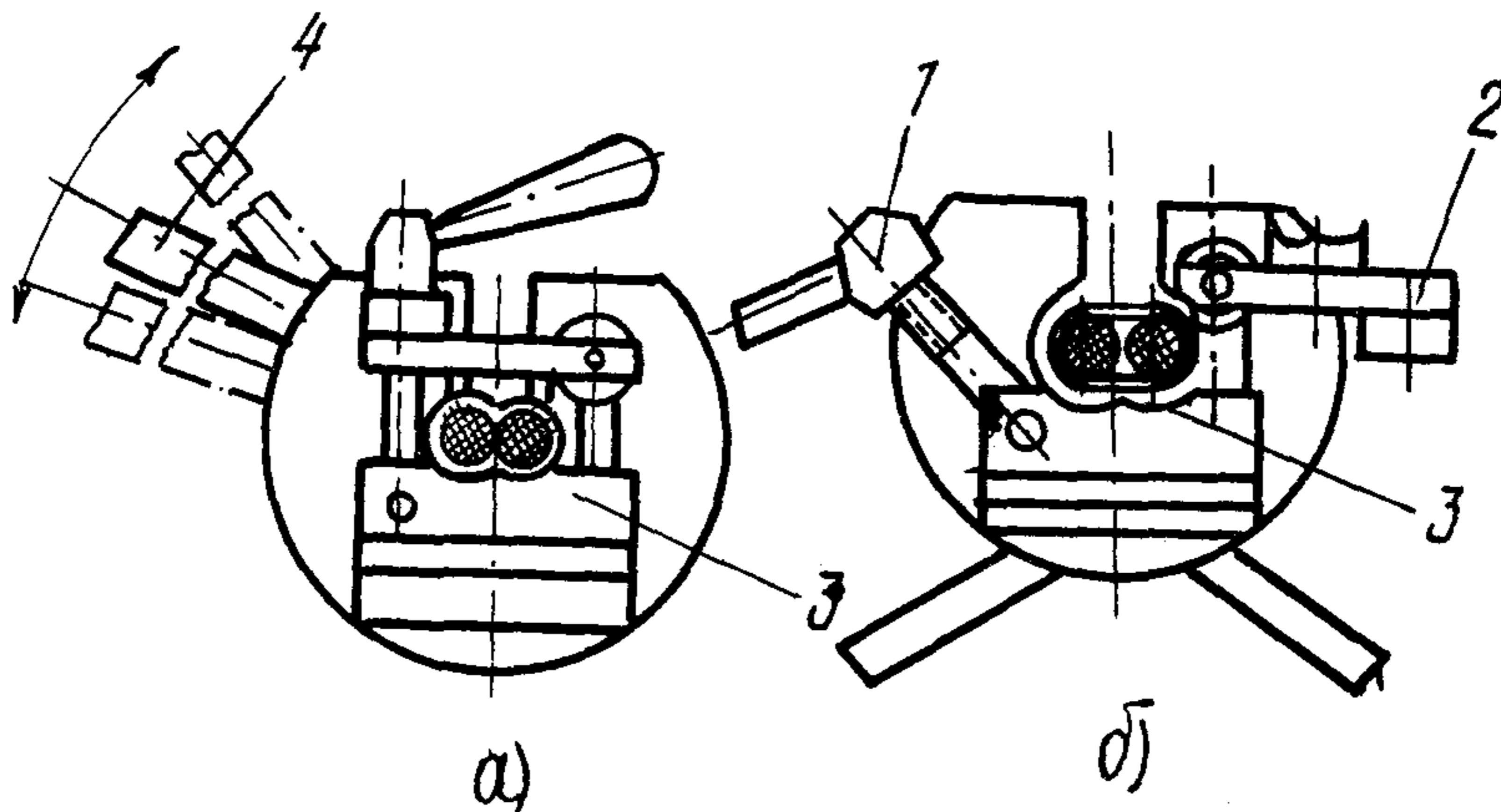
Рис.4. Зажимные узлы приспособления МИ-189А:
