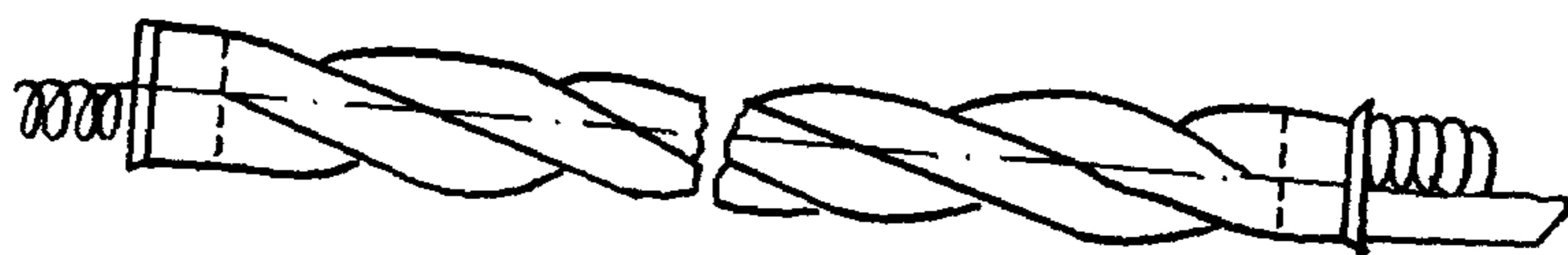
Рис.6. Соединение проволов в овальном соединителе
