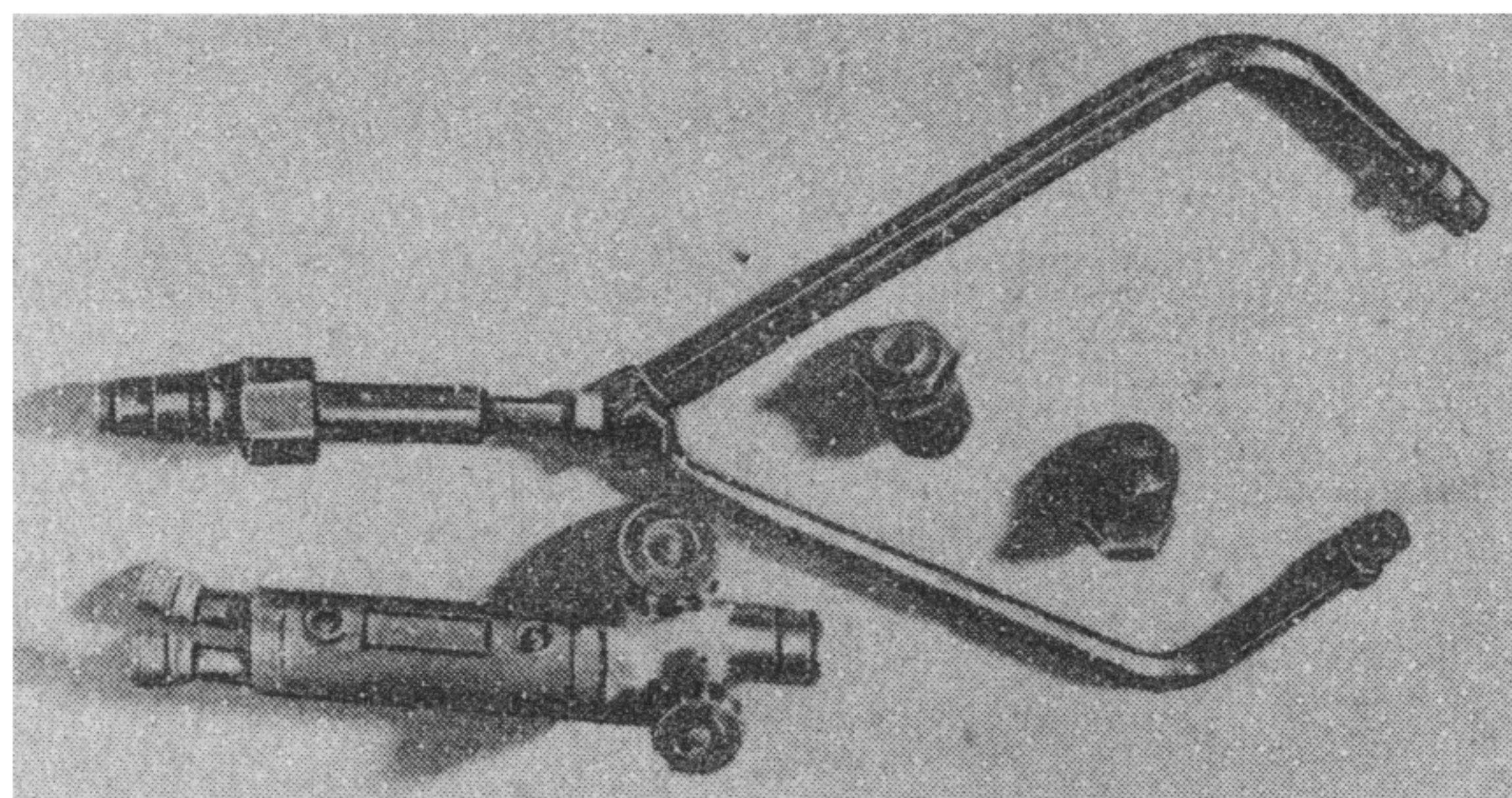
Рис. I9. Двухрежковая пропано-кислородная горелка
