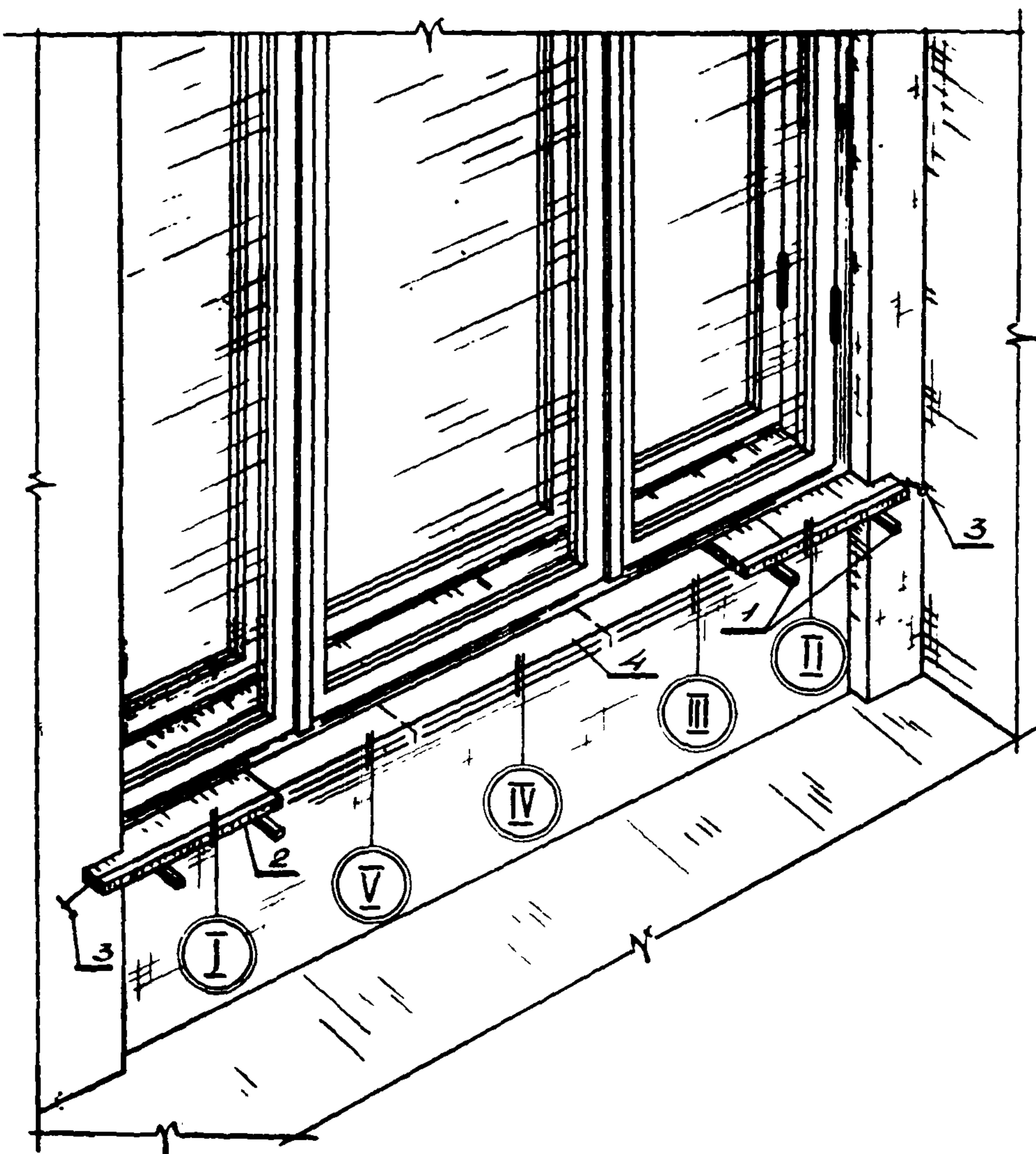
Последовательность укладки подоконных плит
