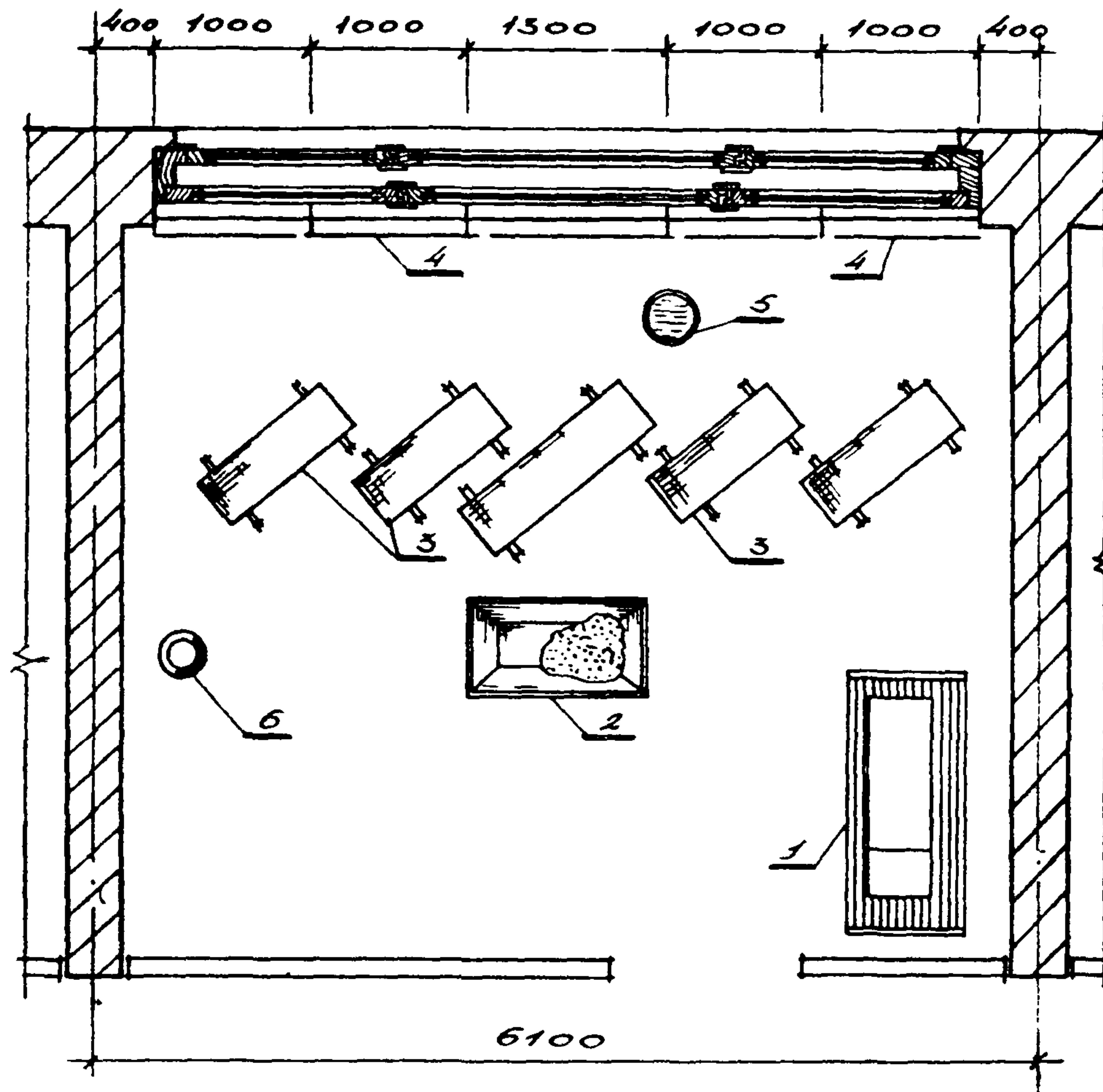
Схема организации рабочего места при укладке мраморных подоконных плит
