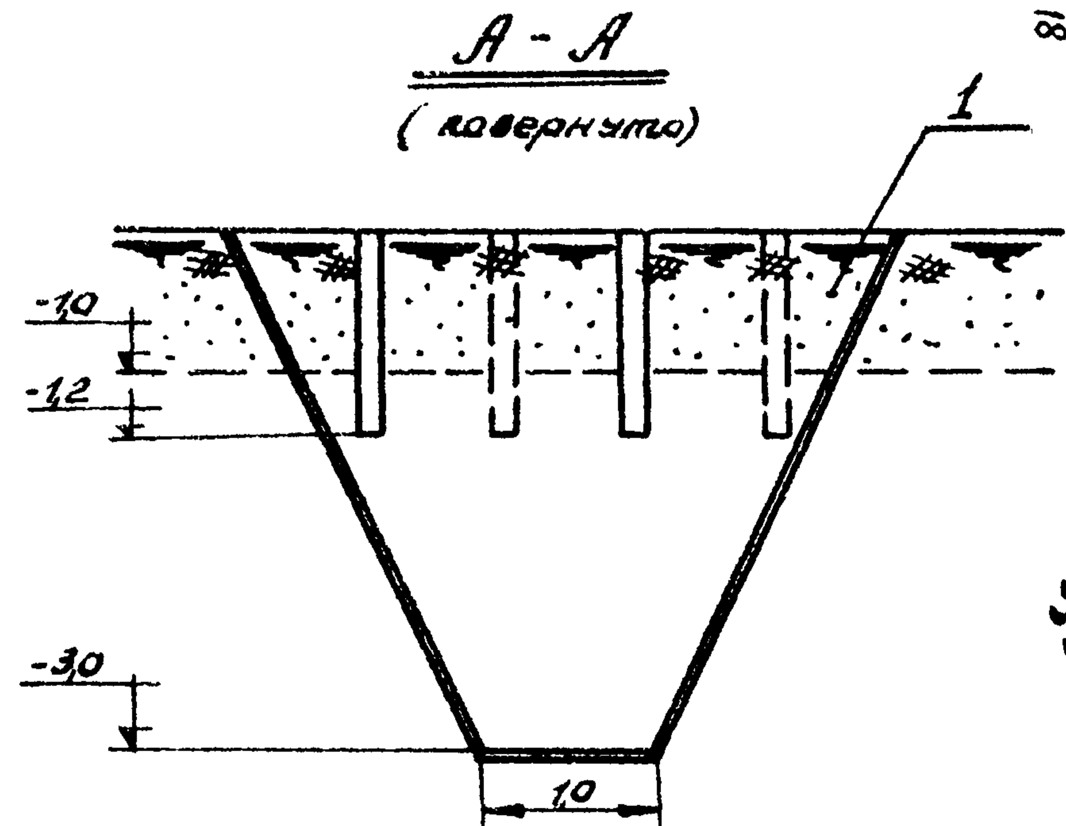
рис. 4 Схема расположения шуров при проходке траншеи
