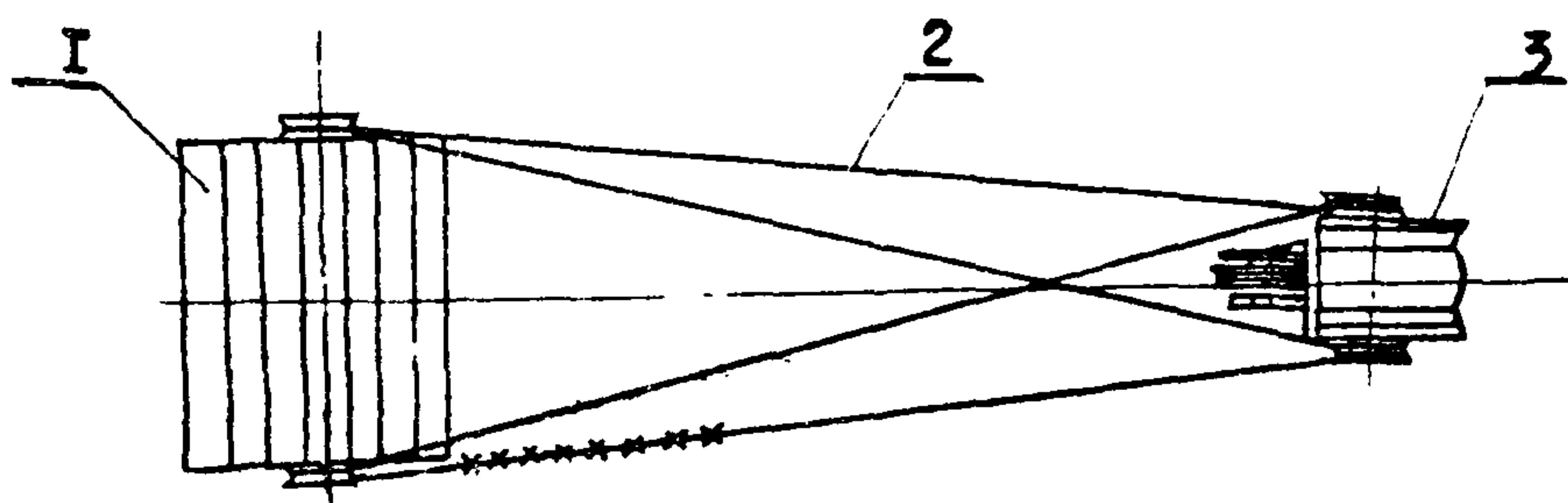
Рис. 9 Схема запасовки якорного каната
