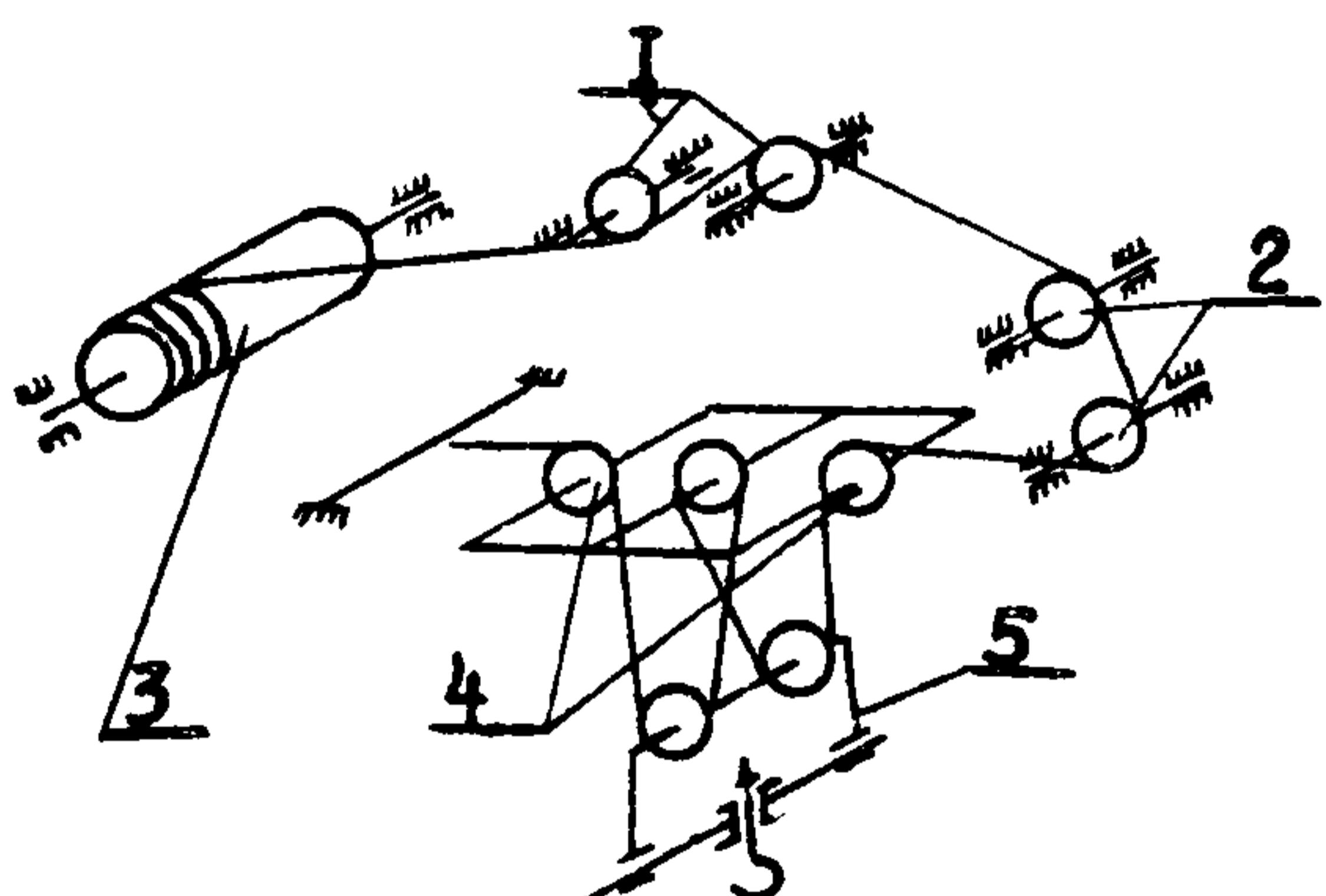
Рис. I2 Схема запасовки грузового каната.
