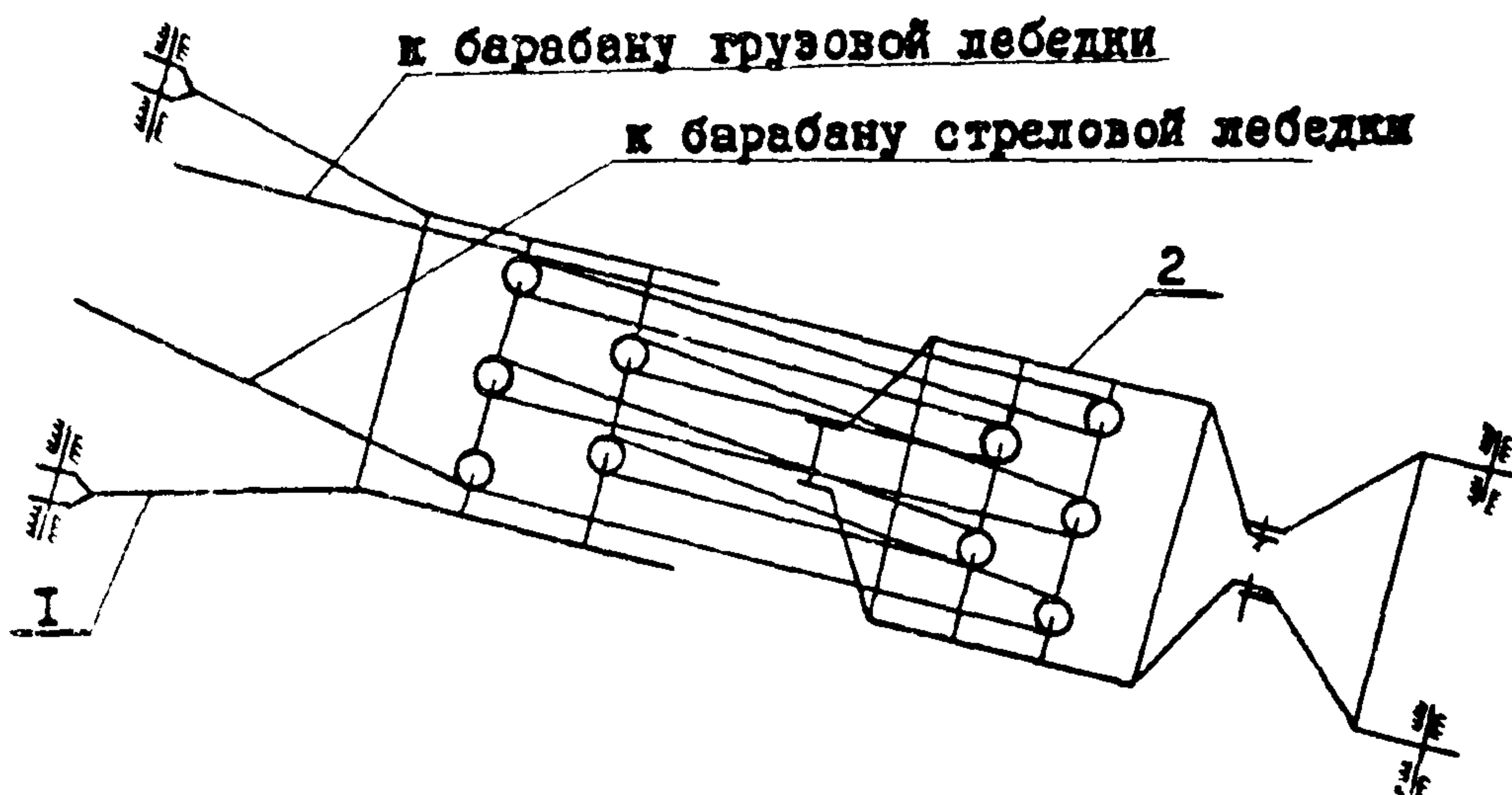
Рис. 10 Схема запасовки монтажного полиспаста.
