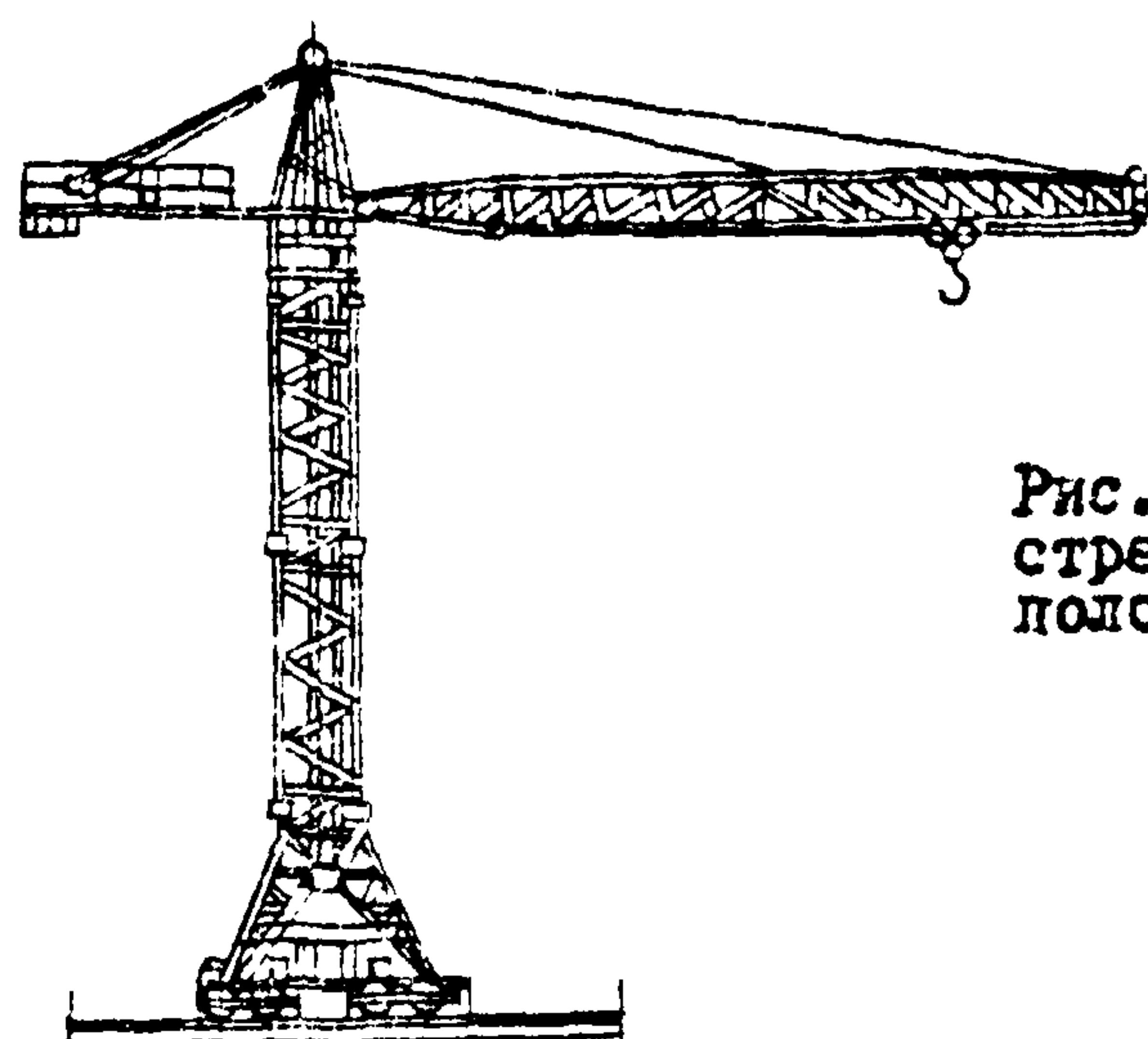
Рис. I6 Подъем стрелы в рабочее положение.
