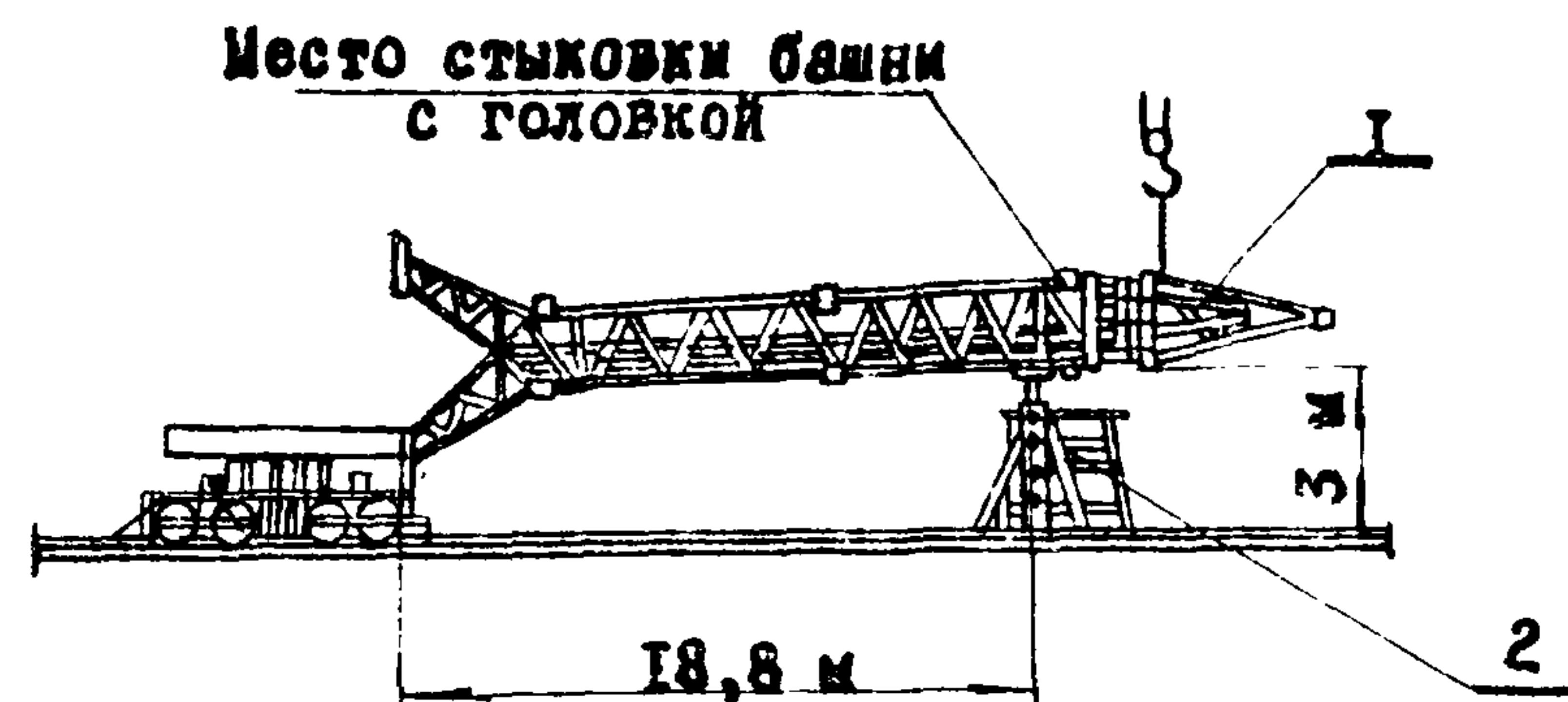
Рис. 6 Схема присоединения головки к башне.
