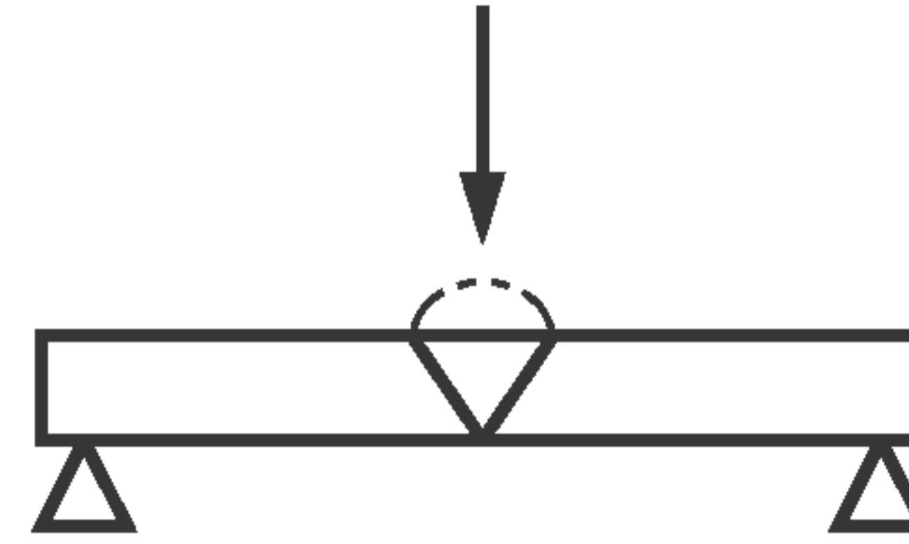
е) Испытание на разрушение с корневой стороны
