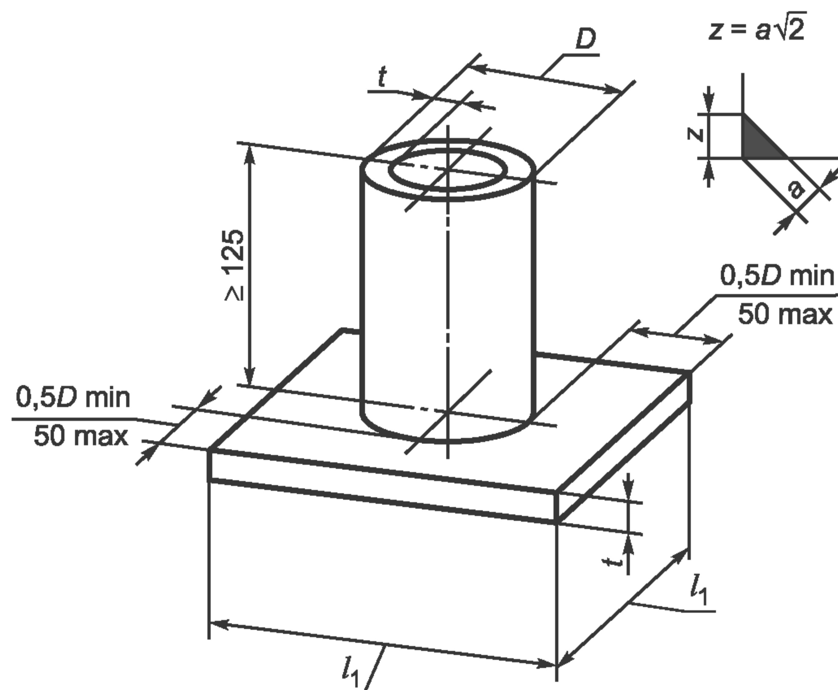
$a$  — номинальная толщина шва;  $D$  — наружный диаметр трубы;  $l_1$  — размер листа;  $t$  — толщина листа или стенки трубы контрольного сварного соединения;  $z$  — величина катета углового шва
