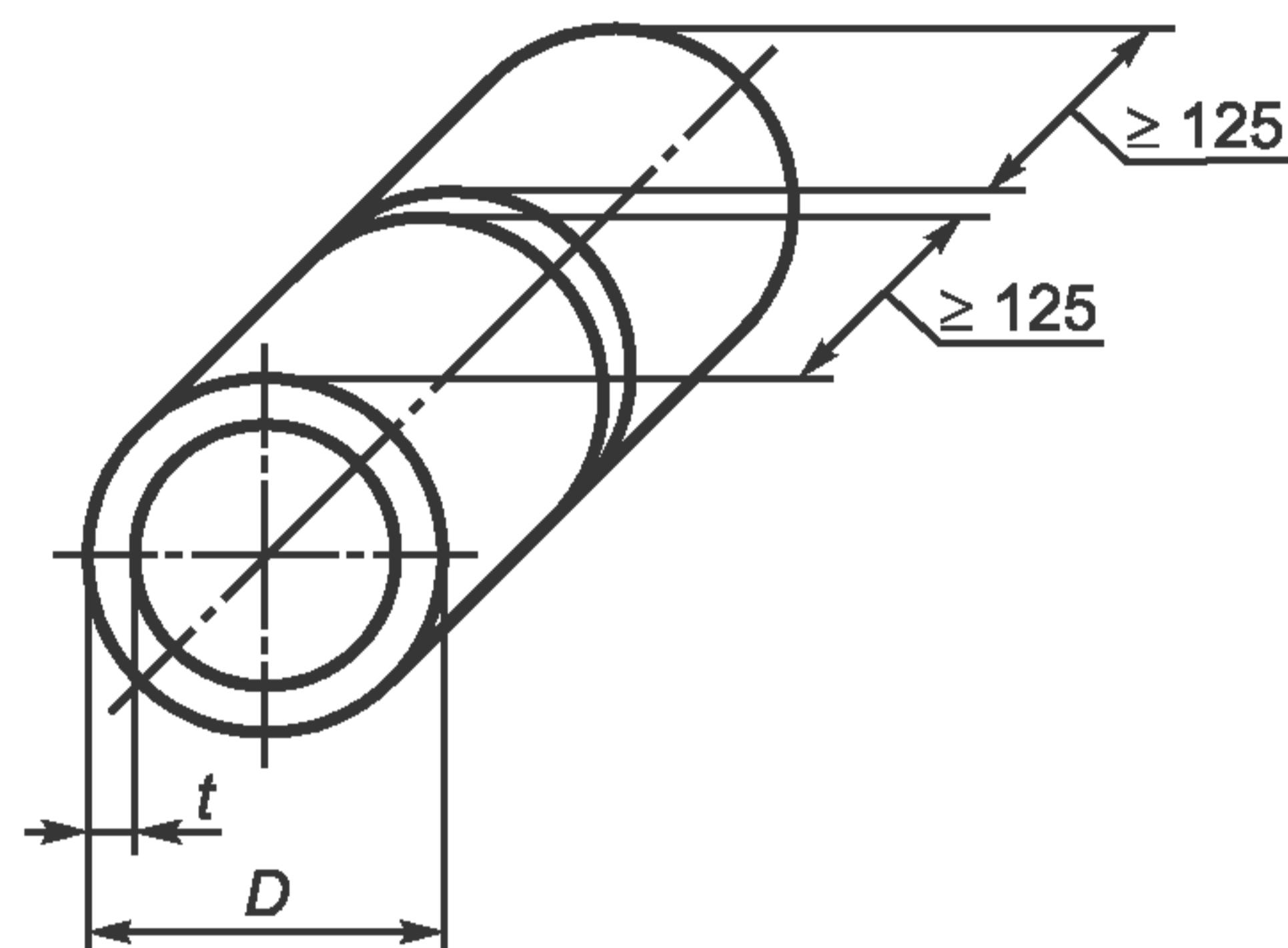
$D$  — наружный диаметр трубы;  $t$  — толщина стенки контрольного сварного соединения
