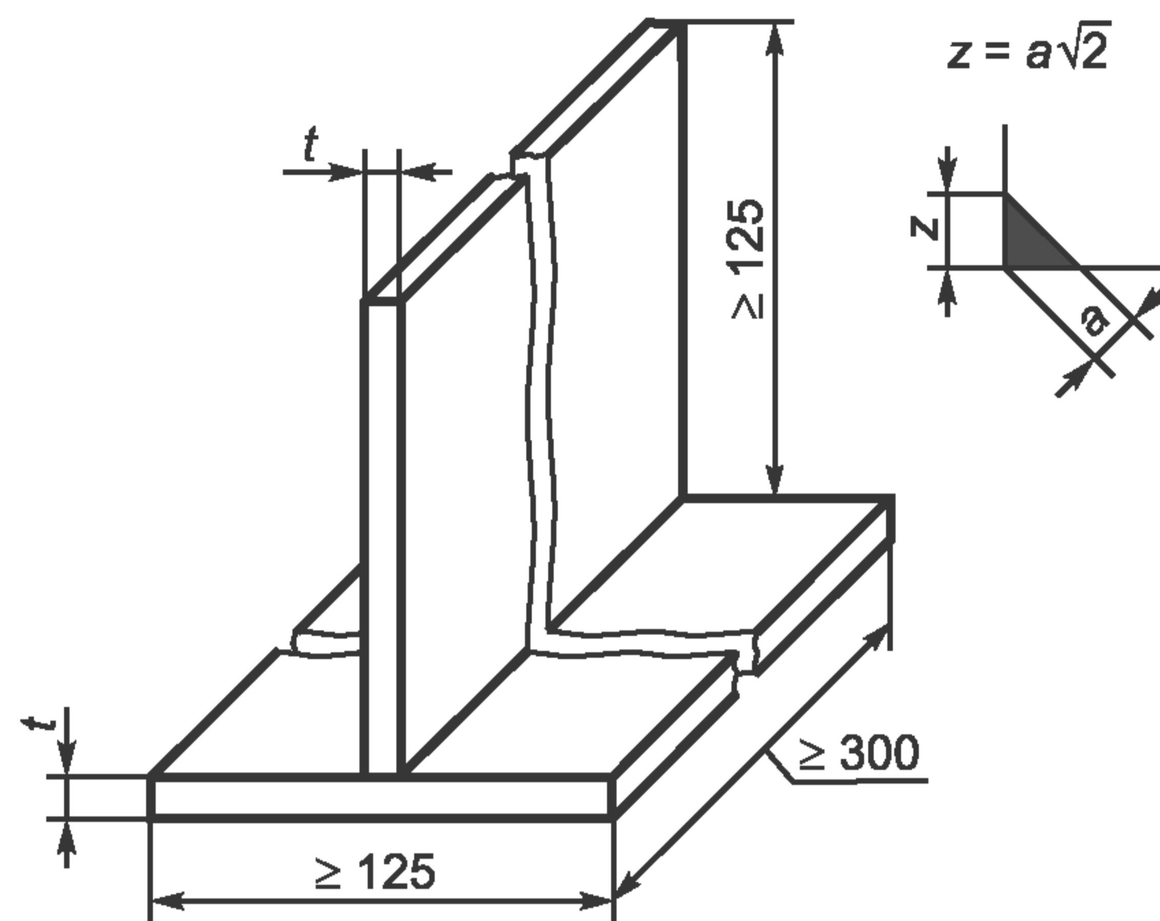
$a$  — номинальная толщина шва;  $t$  — толщина материала контрольного сварного соединения;
