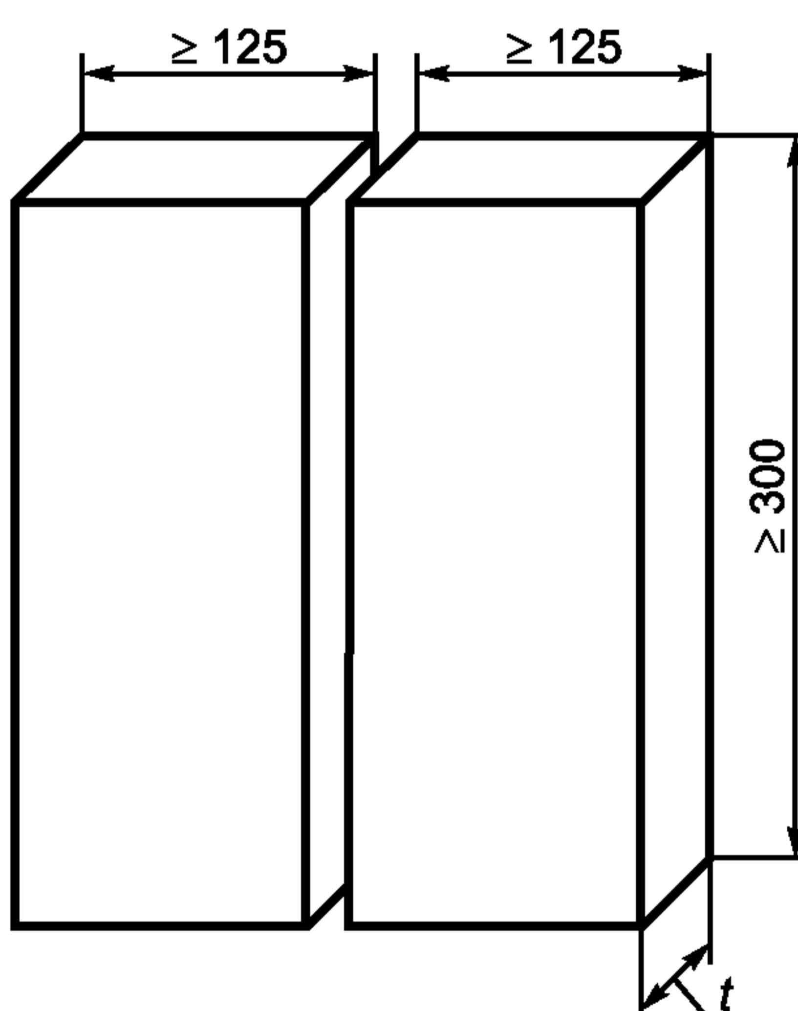
*t* — толщина материала контрольного сварного соединения
