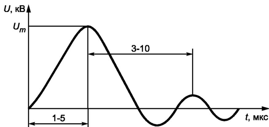
Рисунок Б.3 — Форма импульсов, характерная для точек присоединения  $f, g, n$  на рисунке Б.1
