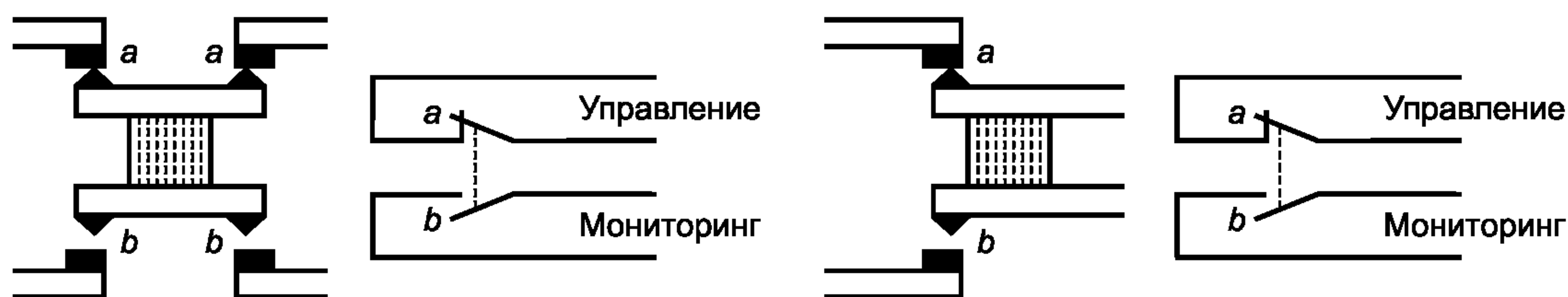
Рисунок А.1 — Контакты реле
