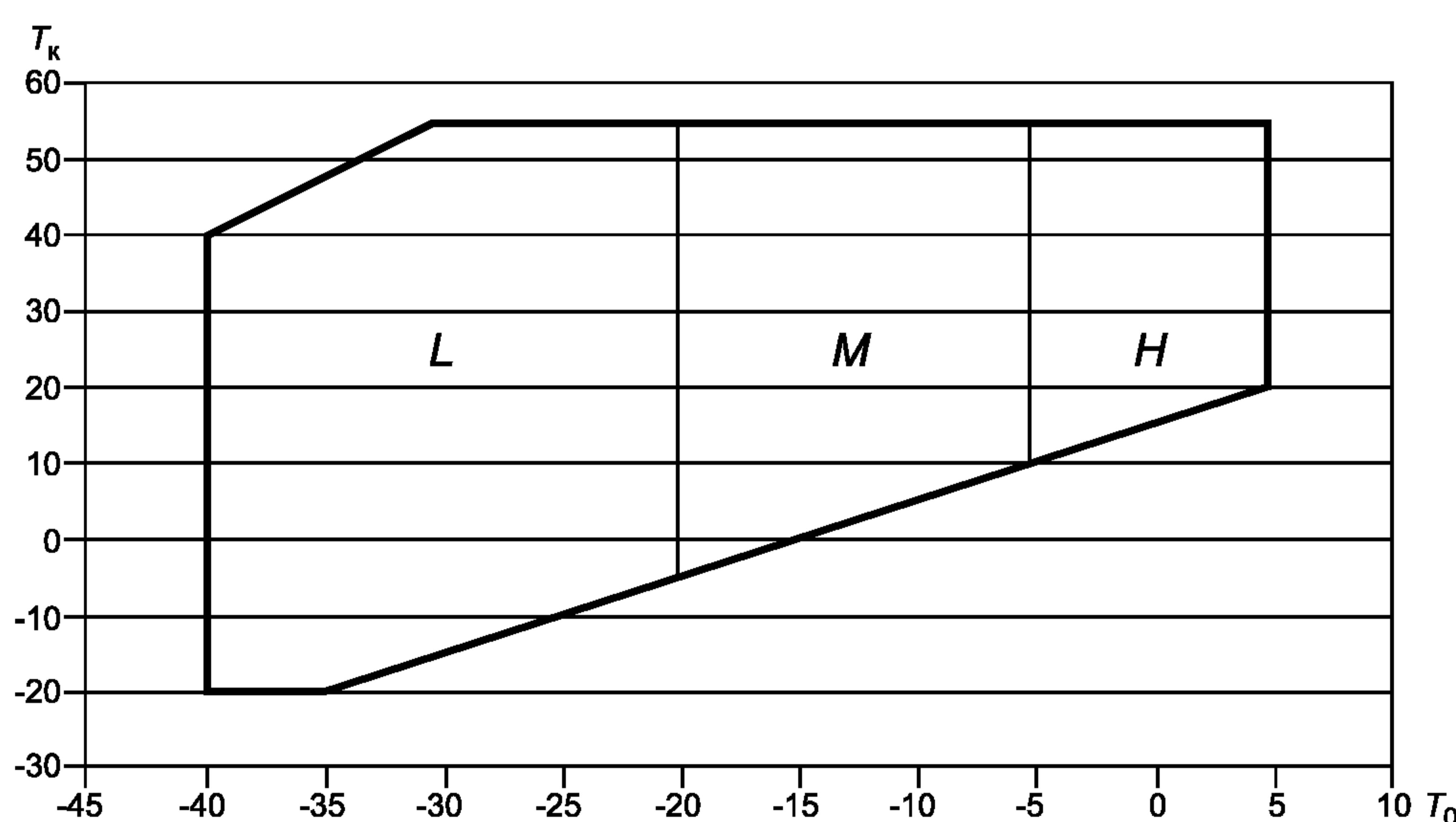
$T_0$  — температура хладагента на линии насыщенного пара при кипении, °С;  $T_k$  — температура хладагента на линии насыщенной жидкости при конденсации, °С;  $H$  — высокие температуры кипения;  $M$  — средние температуры кипения;  $L$  — низкие температуры кипения.
