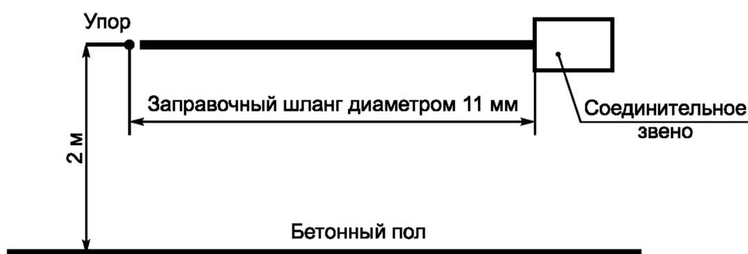
Рисунок 3 — Технологическая подготовка к испытаниям падением
