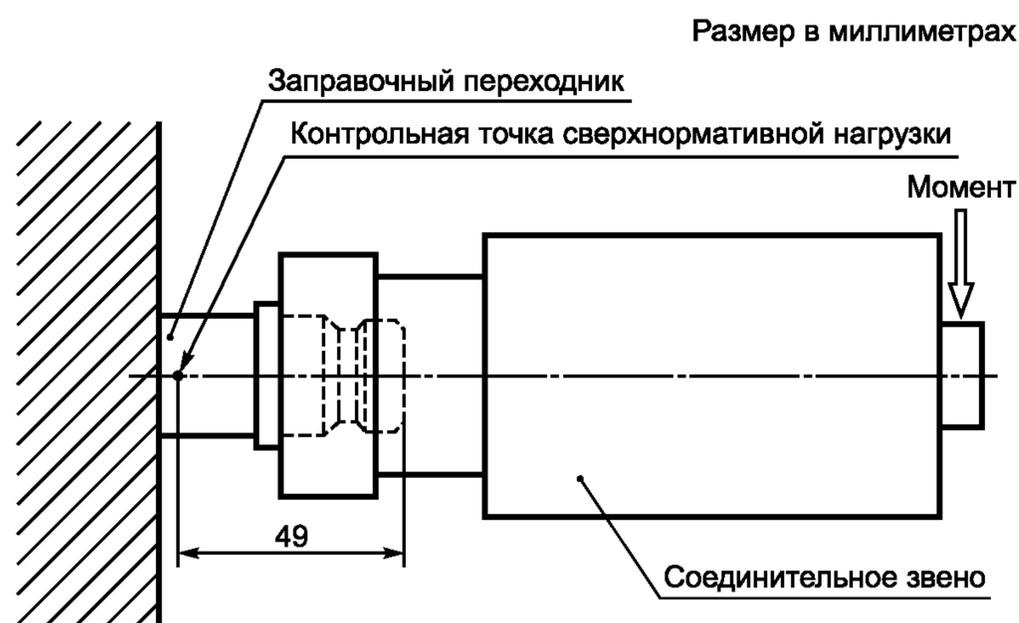
Рисунок 4 — Испытания нагрузками, превышающими нормативное значение
