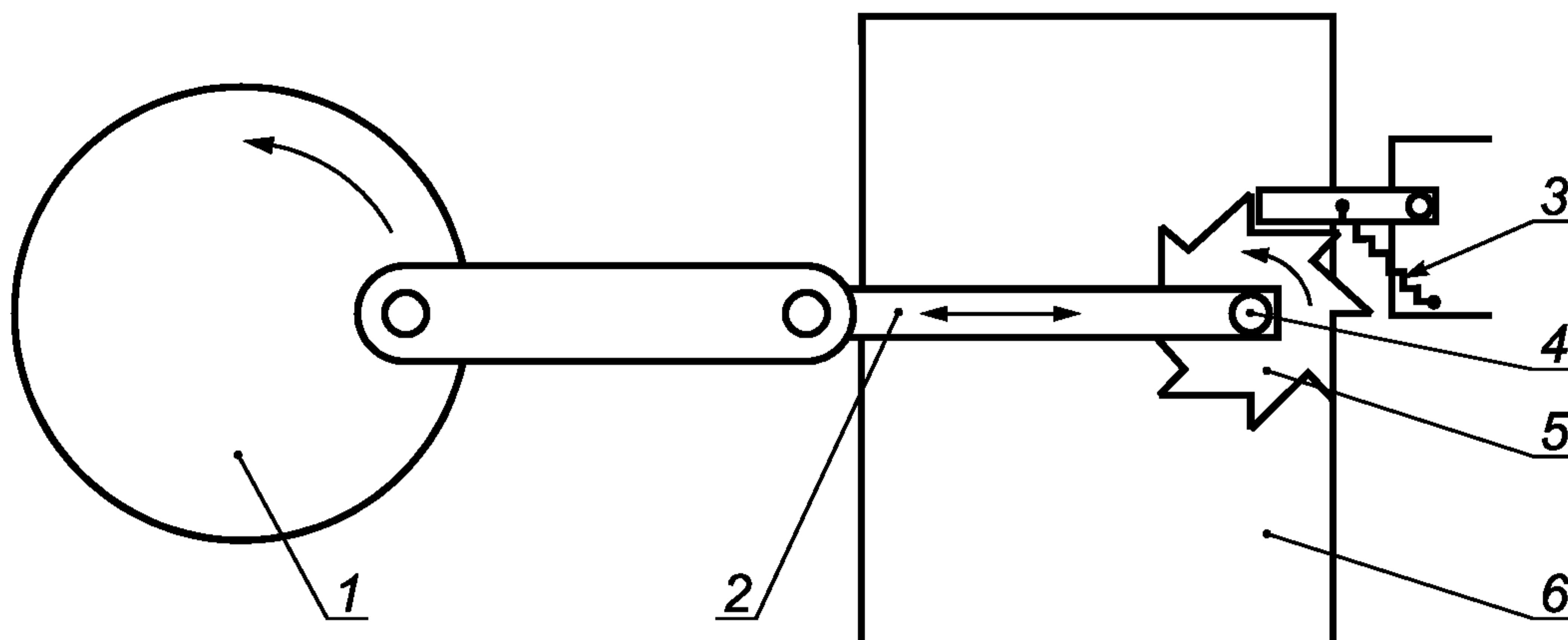
1 — маховик; 2 — рычаг; 3 — пружина; 4 — войлочная насадка; 5 — вращающееся колесо для войлочной насадки;
