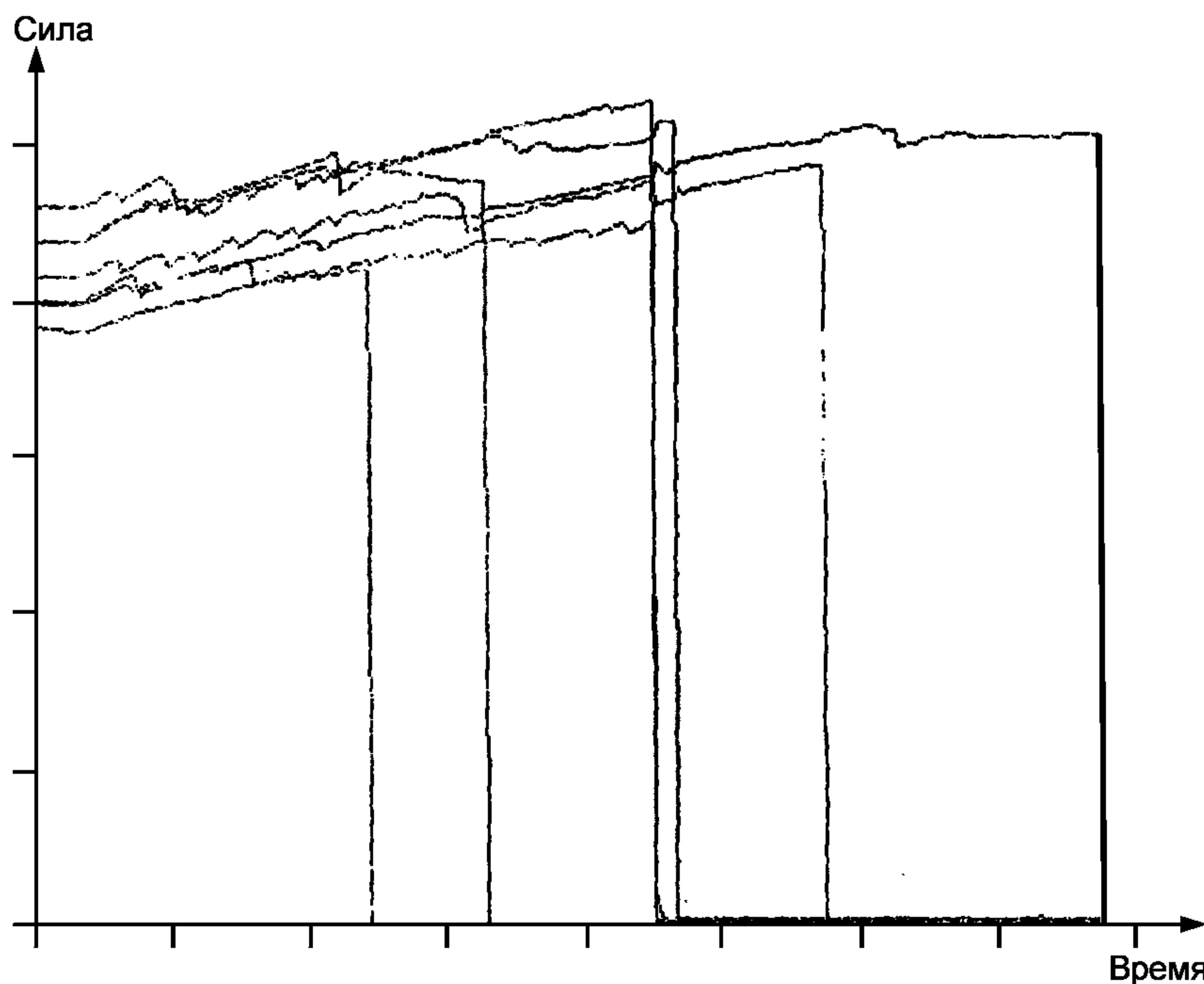
Рисунок В.2 — Неравномерное проскальзывание
