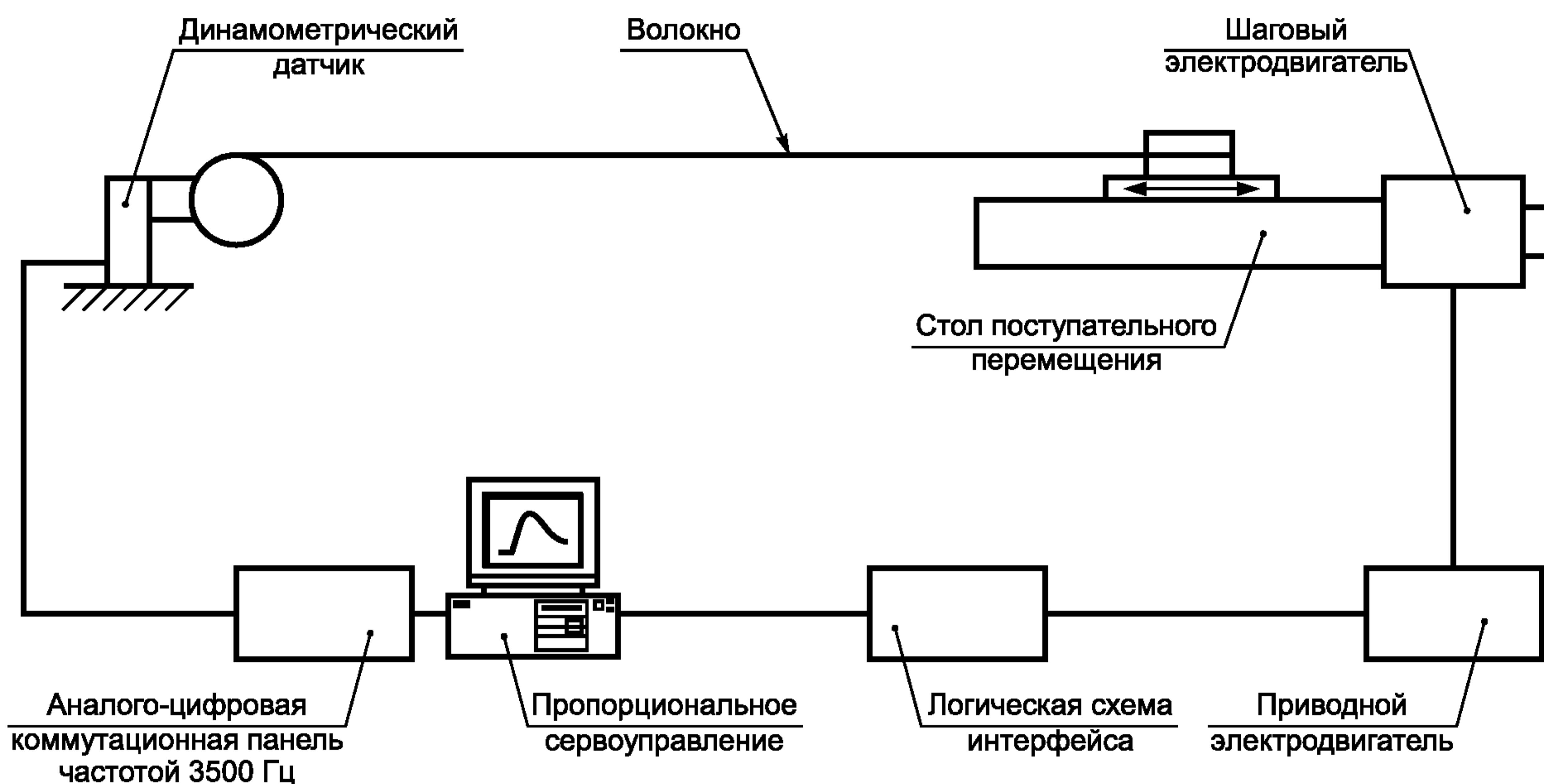
Рисунок С.1 — Система управления скоростью изменения напряжения
