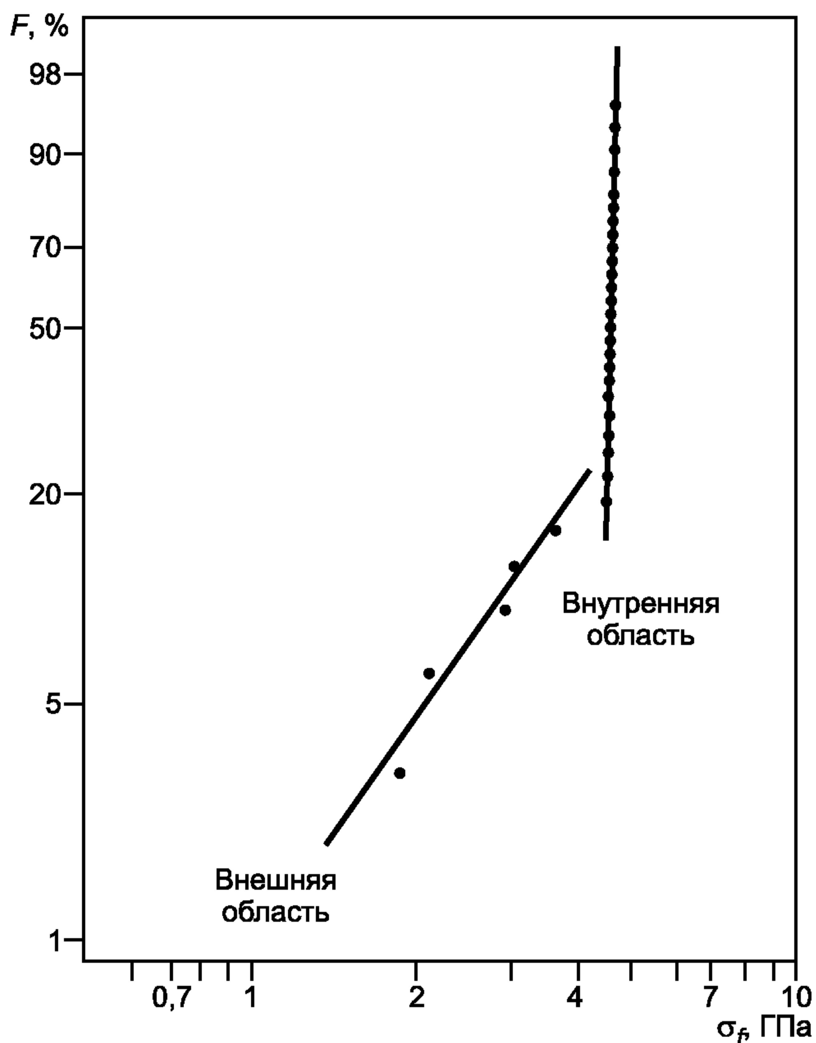
Рисунок 1 — График бимодального распределения Вейбулла для прочности при разрыве испытуемого волокна с измерительной базой 20 м при скорости растяжения 5 %/мин
