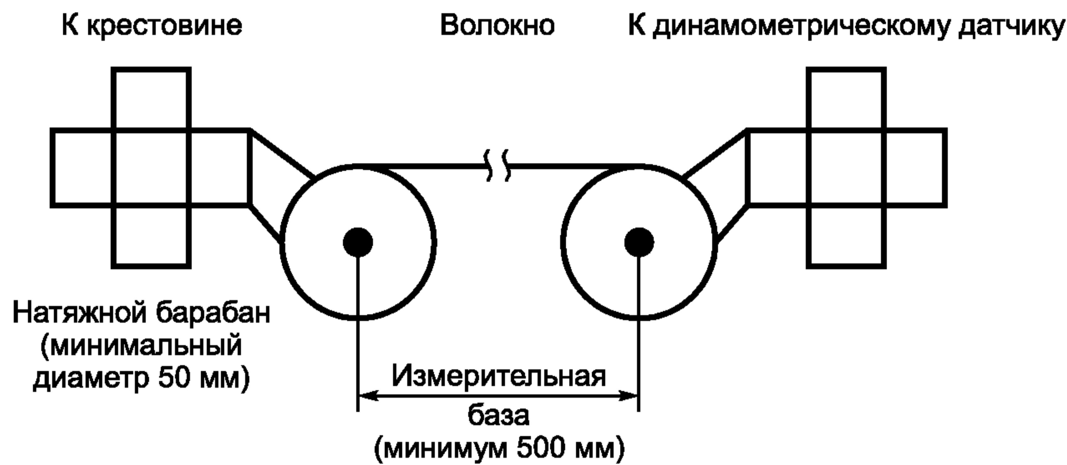
Рисунок А.1 — Конструкция устройства с натяжными барабанами
