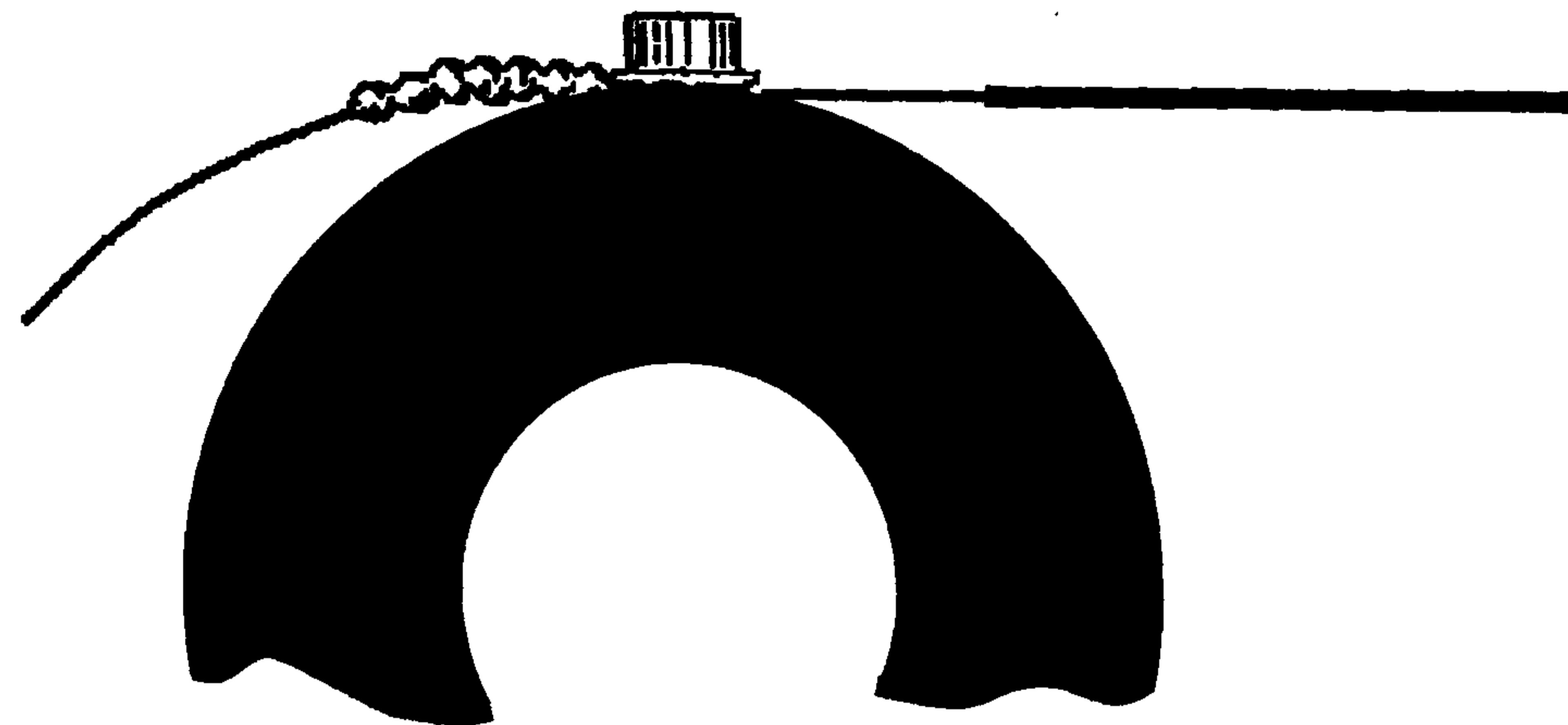
Рисунок В.5 — Типовой натяжной барабан
