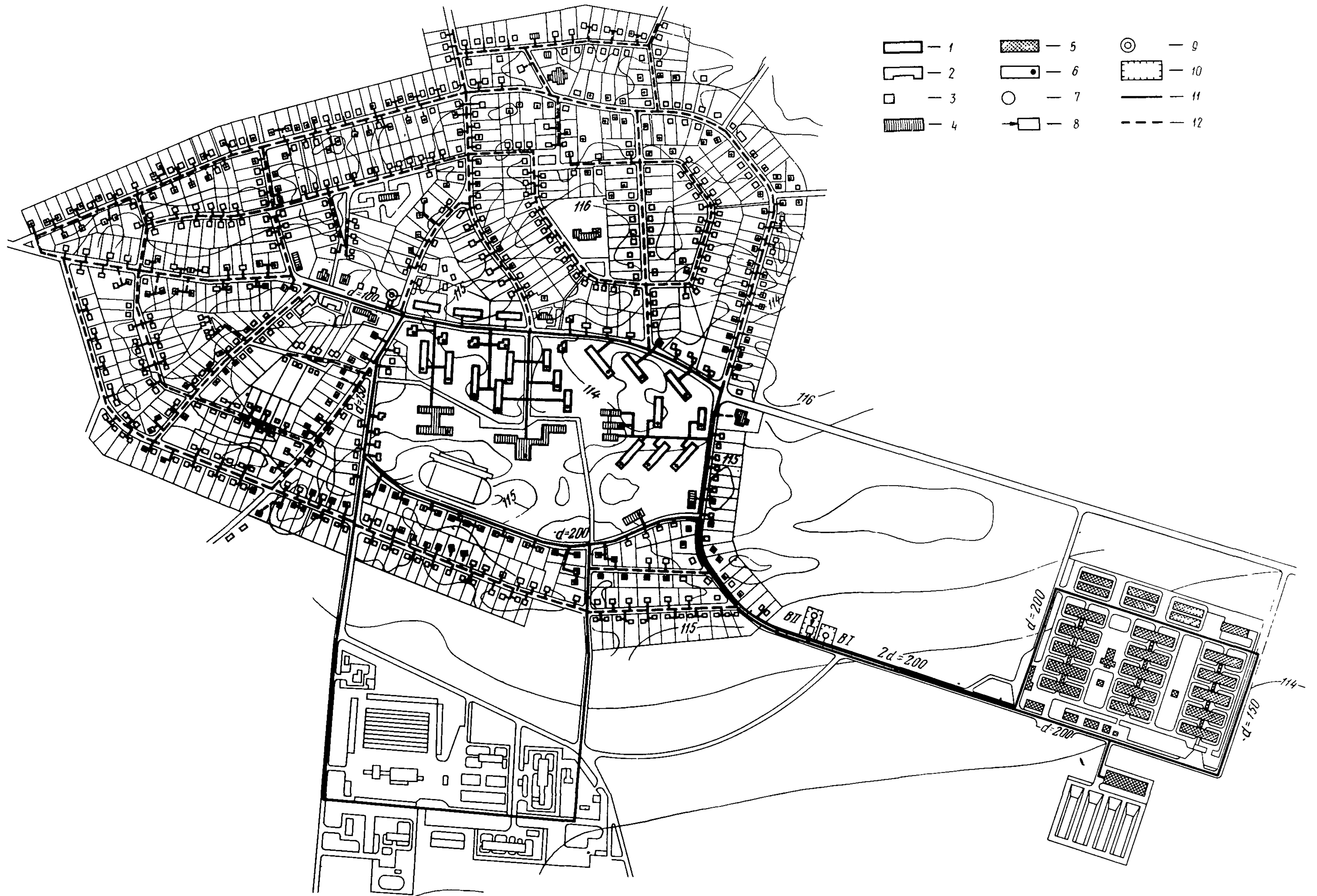
Рис. 10.24. Схема водоснабжения поселка с населением 5260 чел. (варианты 1 и П):
