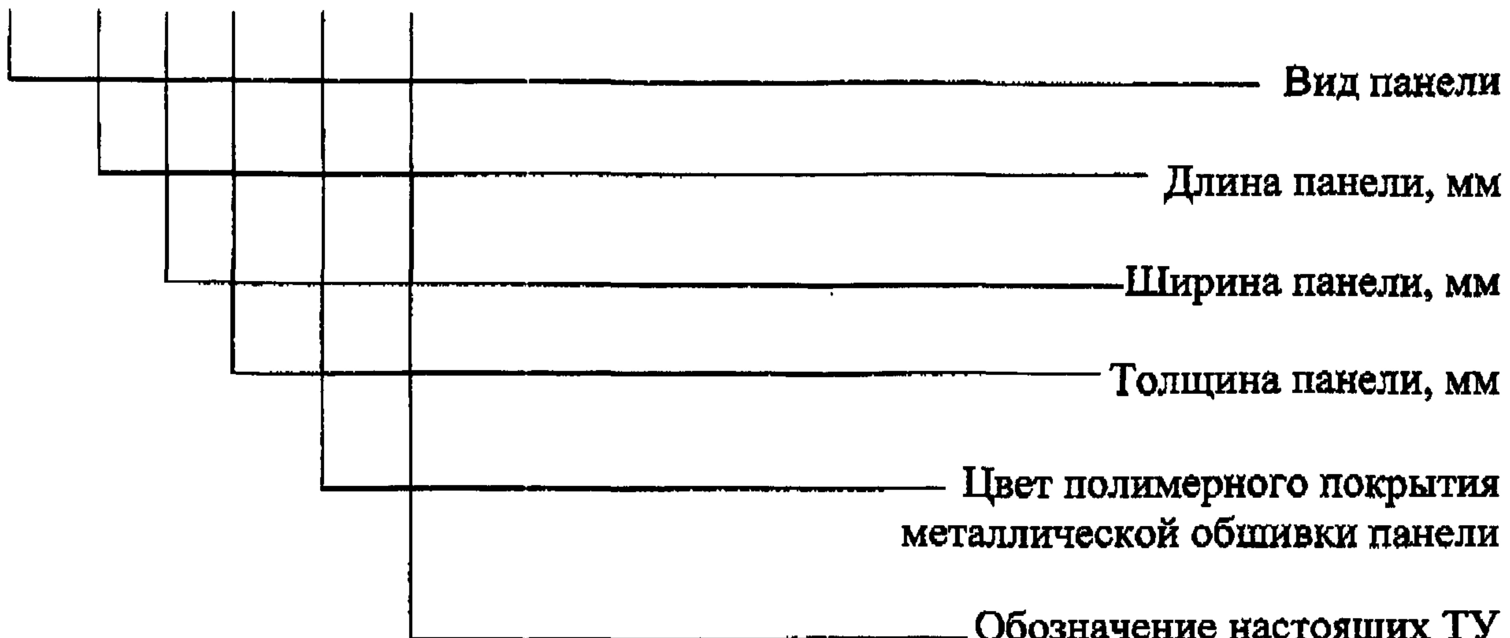
Пример условного обозначения панели кровельной металлической длиной 6м, шириной 1174мм, толщиной 180мм, цветом покрытия металлической обшивки – светло-серым RR 21.
