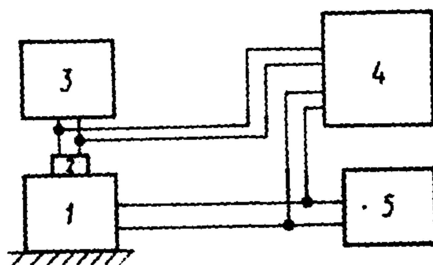
1 — вибровозбудитель; 2 — проверяемый ВИП; 3 — вольтметр; 4 — осциллограф; 5 — генератор частоты
