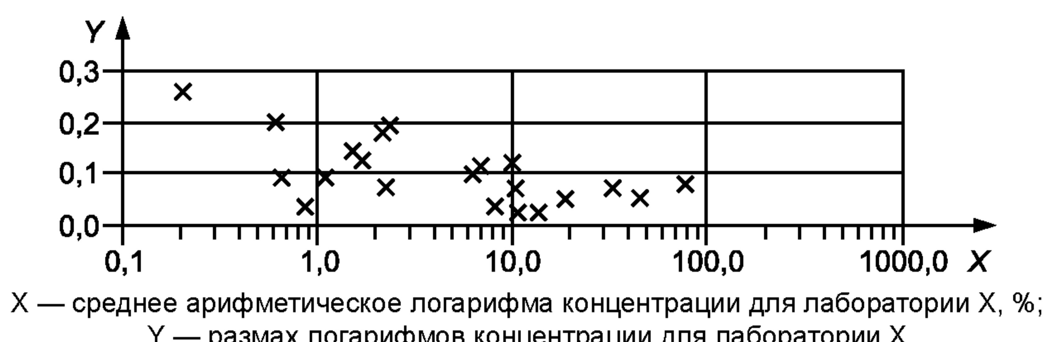
Рисунок 12 — Размах логарифмов концентраций повторных исследований лаборатории X
