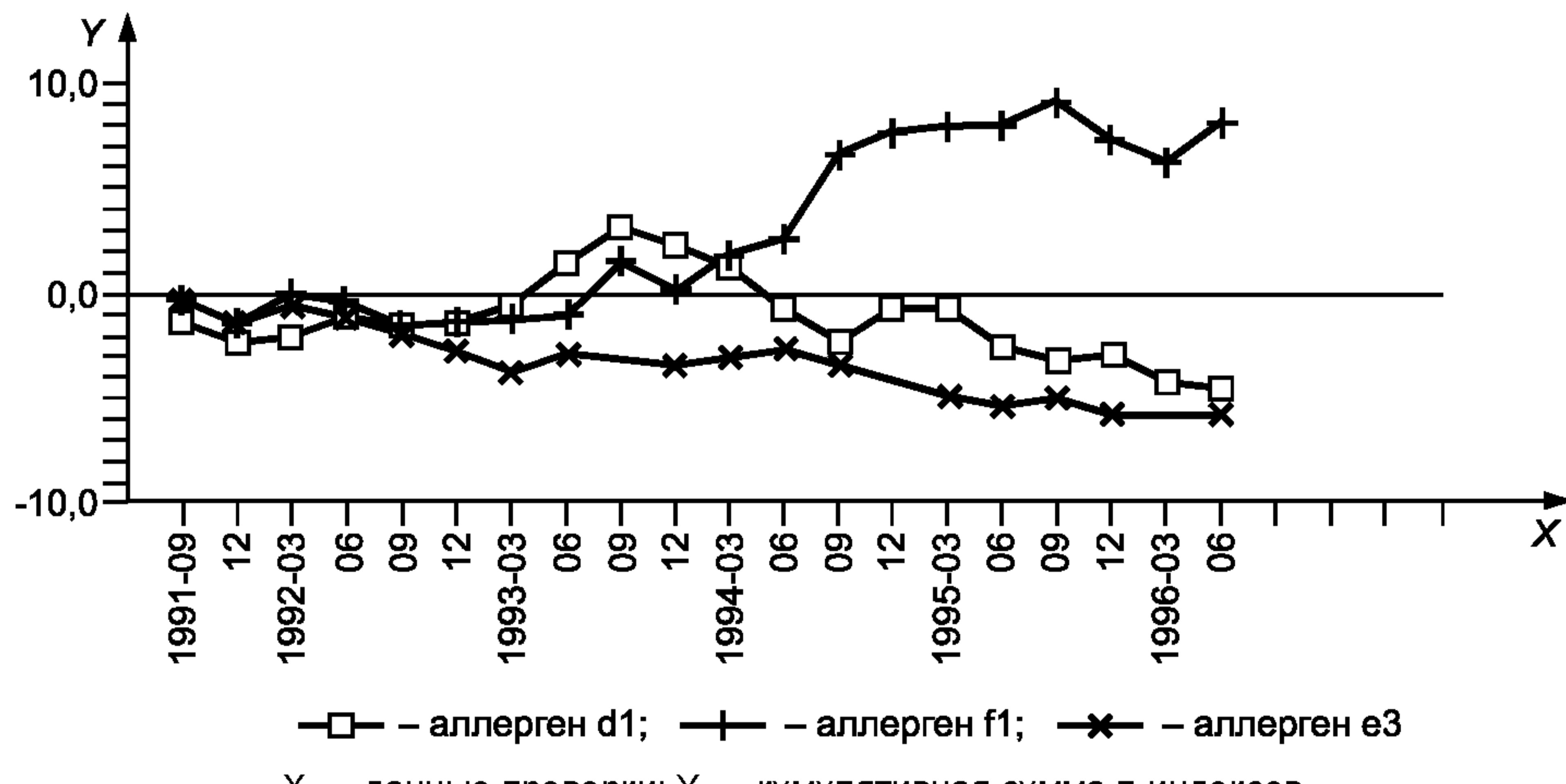
Рисунок 16 — Кусум-карта для данных одной лаборатории по 20 экспериментальным проверкам компетентности (данные таблицы 16)
