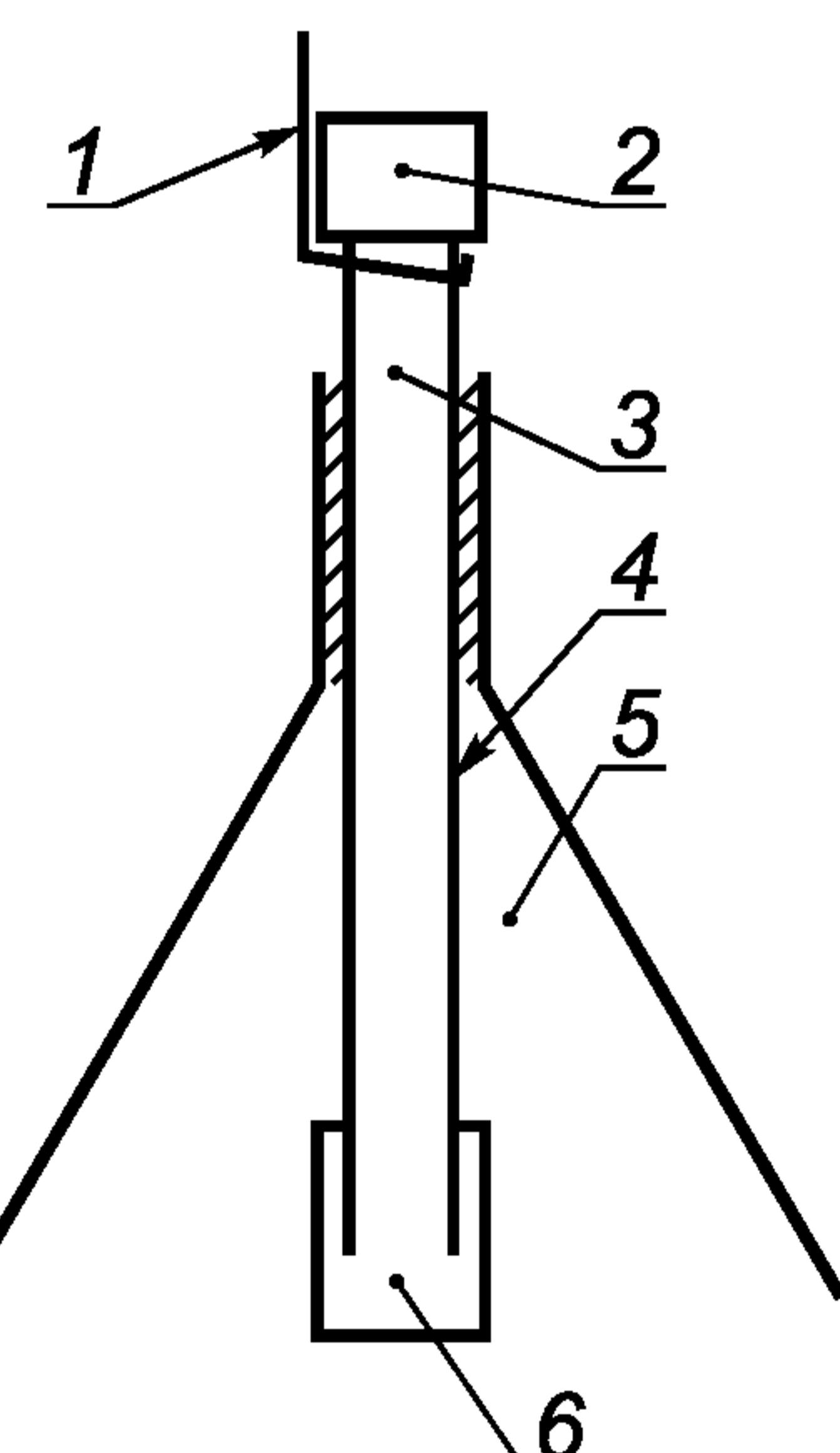
1 — нить; 2 — подходящая навинчивающаяся крышечка; 3 — сорбент; 4 — пробоотборная трубка; 5 — воронка; 6 — диффузионная крышка с сеткой на конце
