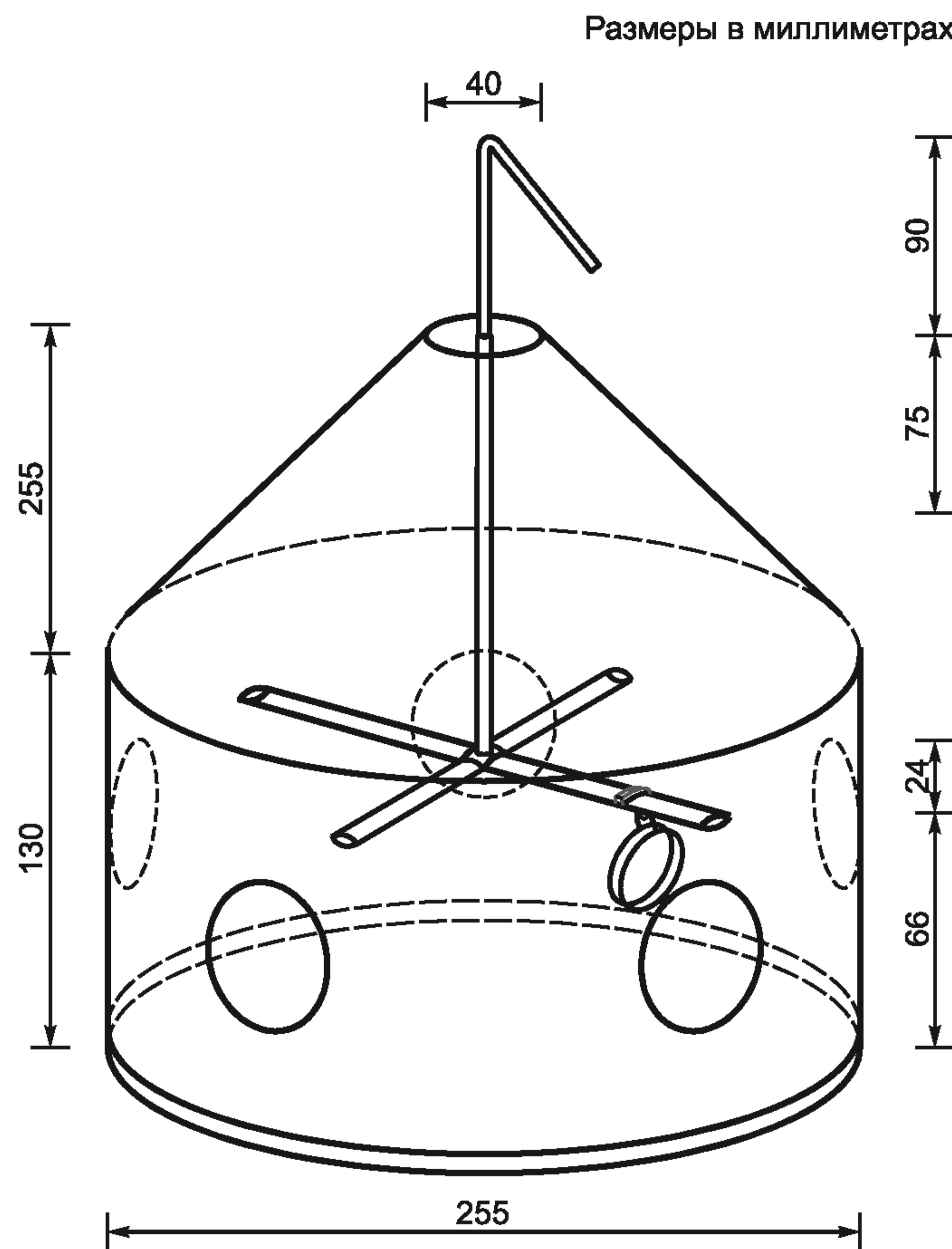
Рисунок А.3 — Эскиз защитного укрытия
