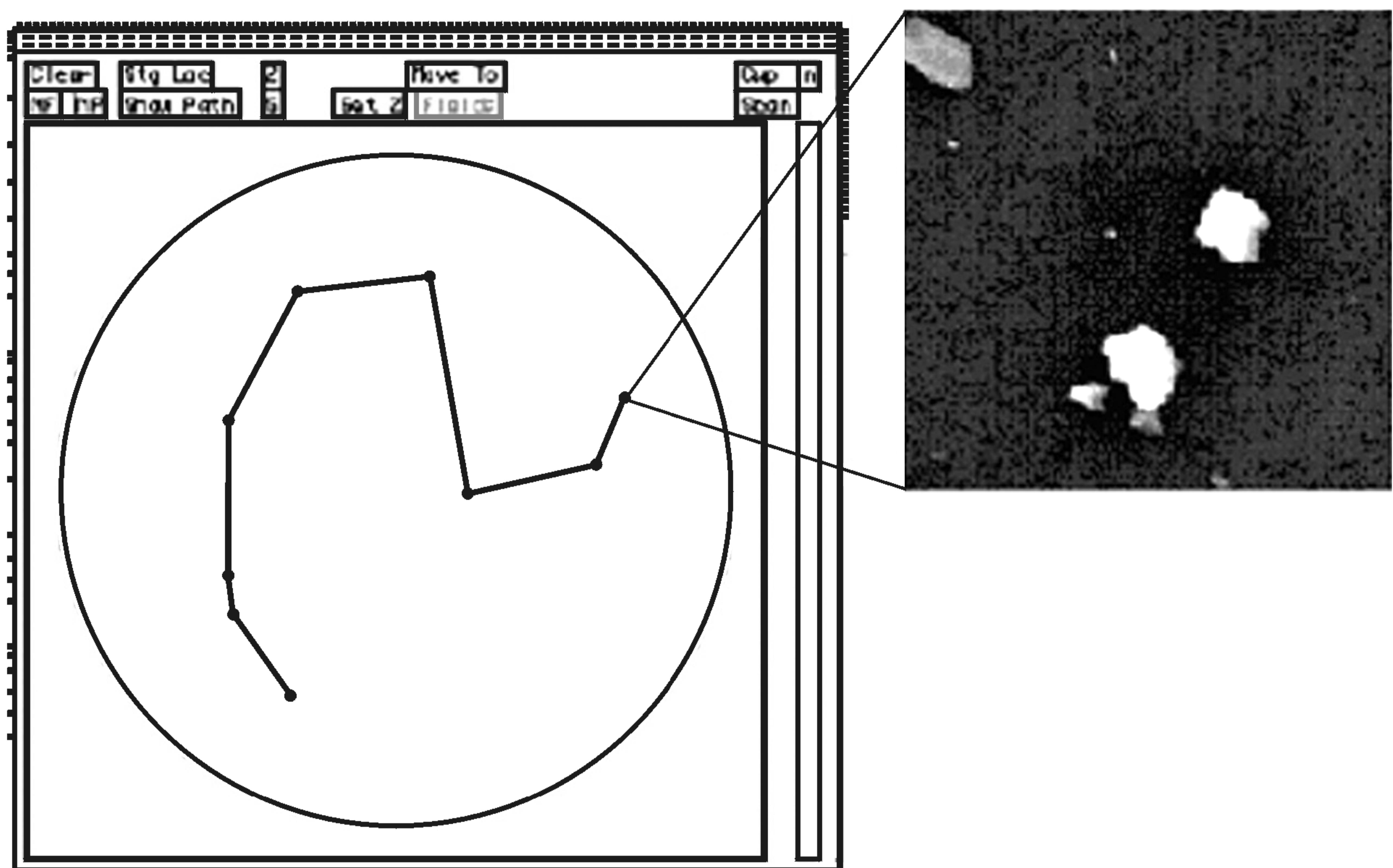
**П р и м е ч а н и е** — Программа случайным образом выбирает поля зрения и собирает микрографические изображения частиц. Здесь показано изображение частицы ISO MTD при увеличении  $\times 3300$ . Маршрут анализа не зависит от случайного выбора поля зрения.
