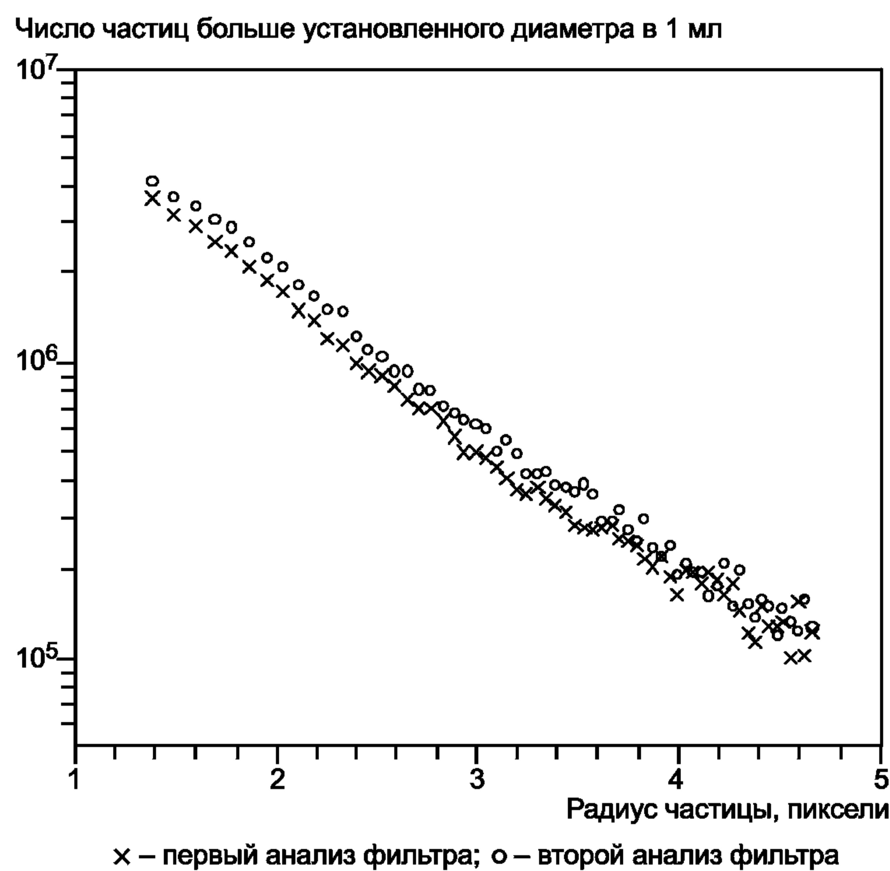
Причина — В каждом случае оптимизировали процесс создания изображения на СЭМ. Все анализы были продублированы как можно более точно, но одни и те же поля не рассматривали.
