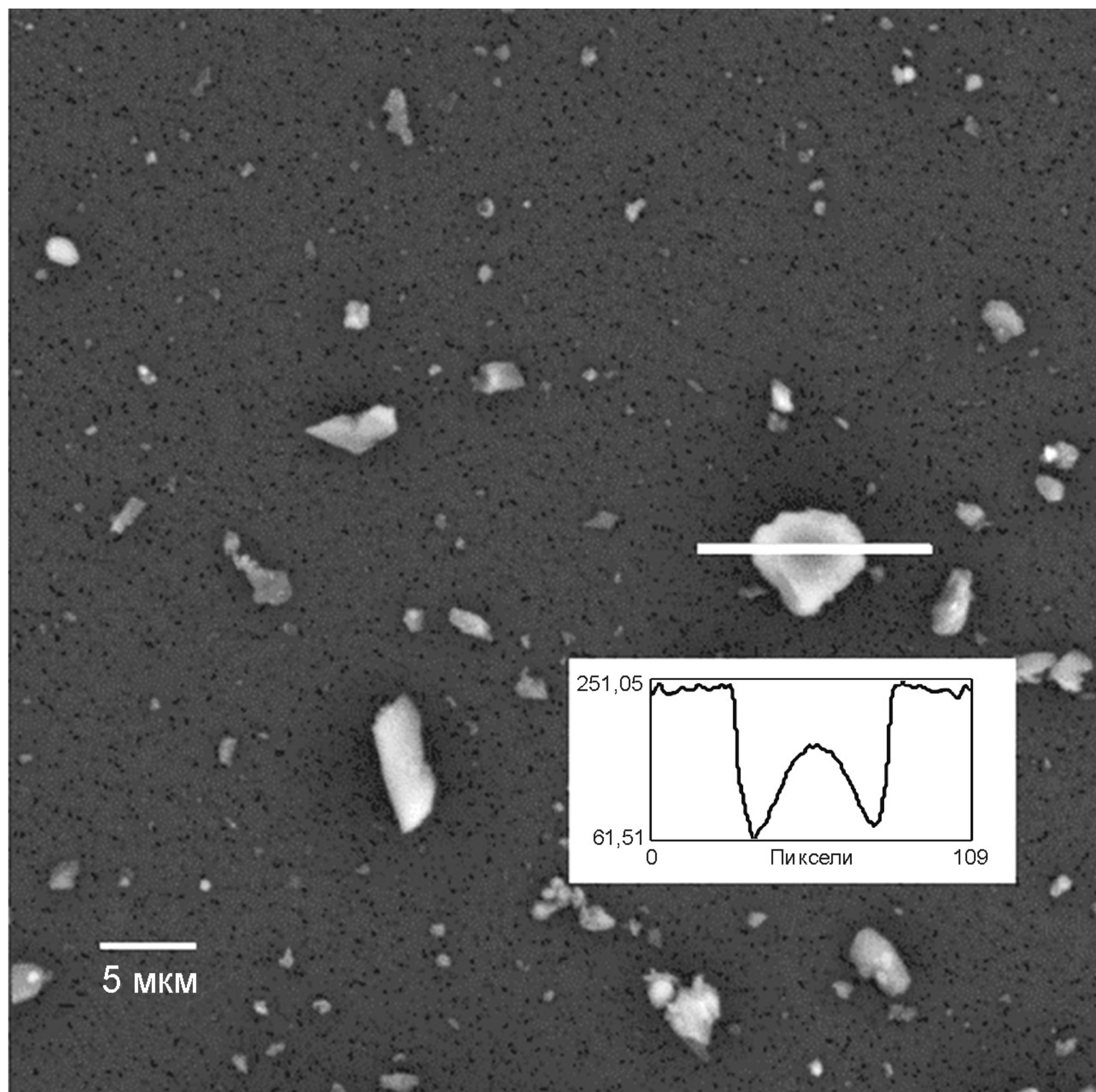
П р и м е ч а н и е — Уровень серого для фильтра составляет 251, для контура — от 60 до 70, а для центральной части частицы — приблизительно от 150 до 180. Изображение было получено с помощью NIH Image, общедоступного пакета программ с инвертированной настройкой уровня серого, отсутствующей у программы Lispix.
