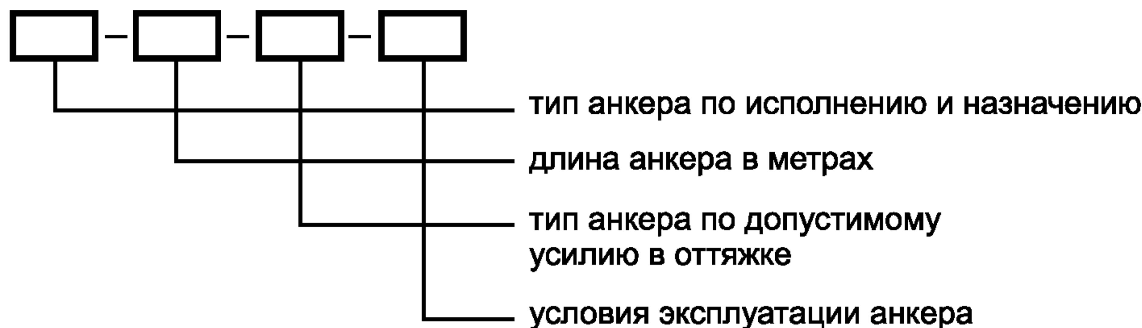
Условия эксплуатации анкеров железобетонных:
