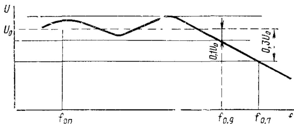
Рис 3. Параметры амплитудно-частотной характеристики
