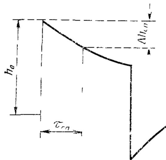
Рис. 2 Параметры переходной характеристики при закрытом входе
