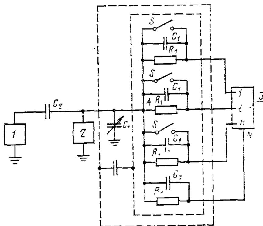
Рис. 4. Схема определения коэффициента ослабления синфазных сигналов:
