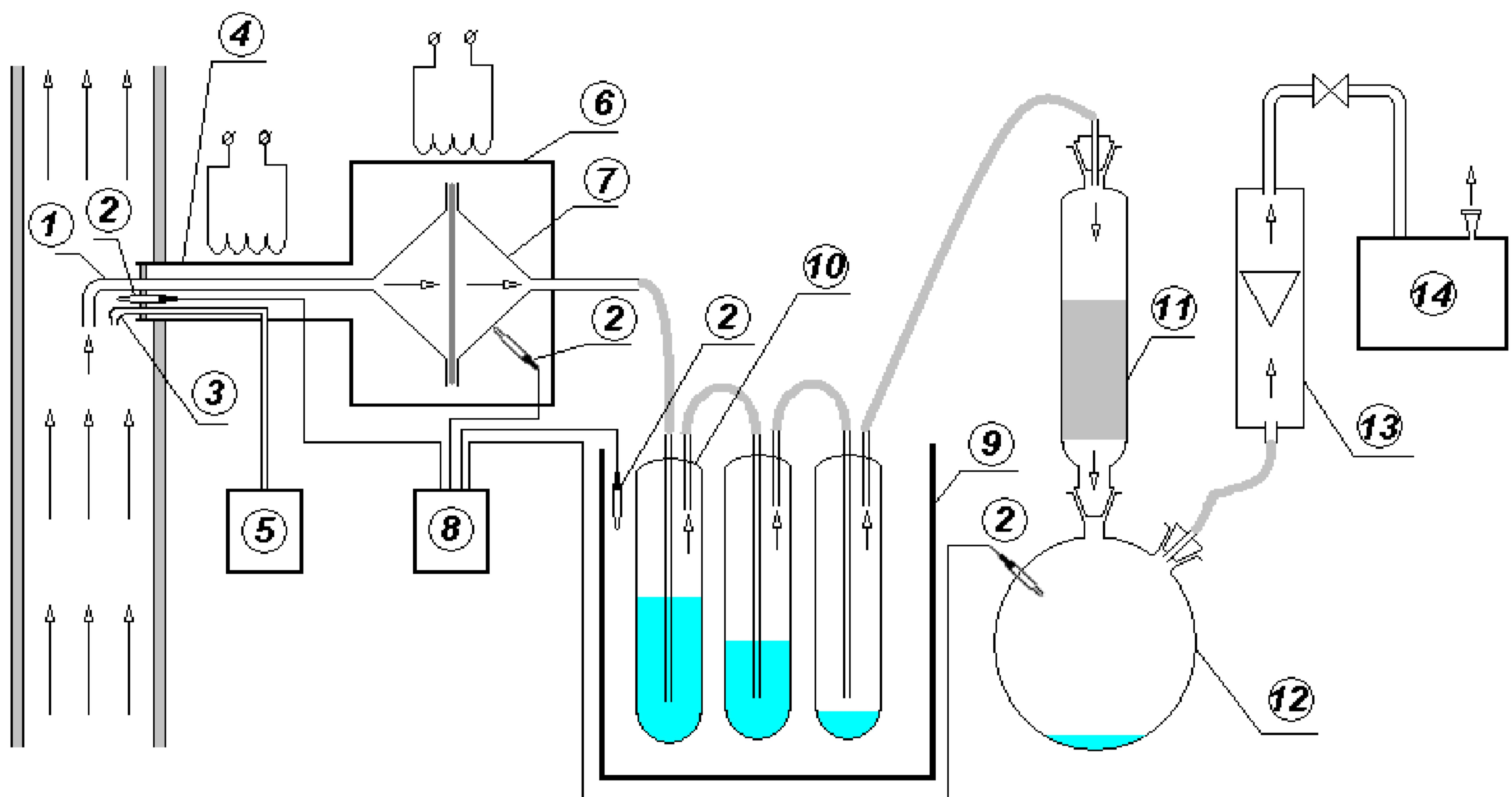
Рисунок Б1: Пробоотборное устройство
