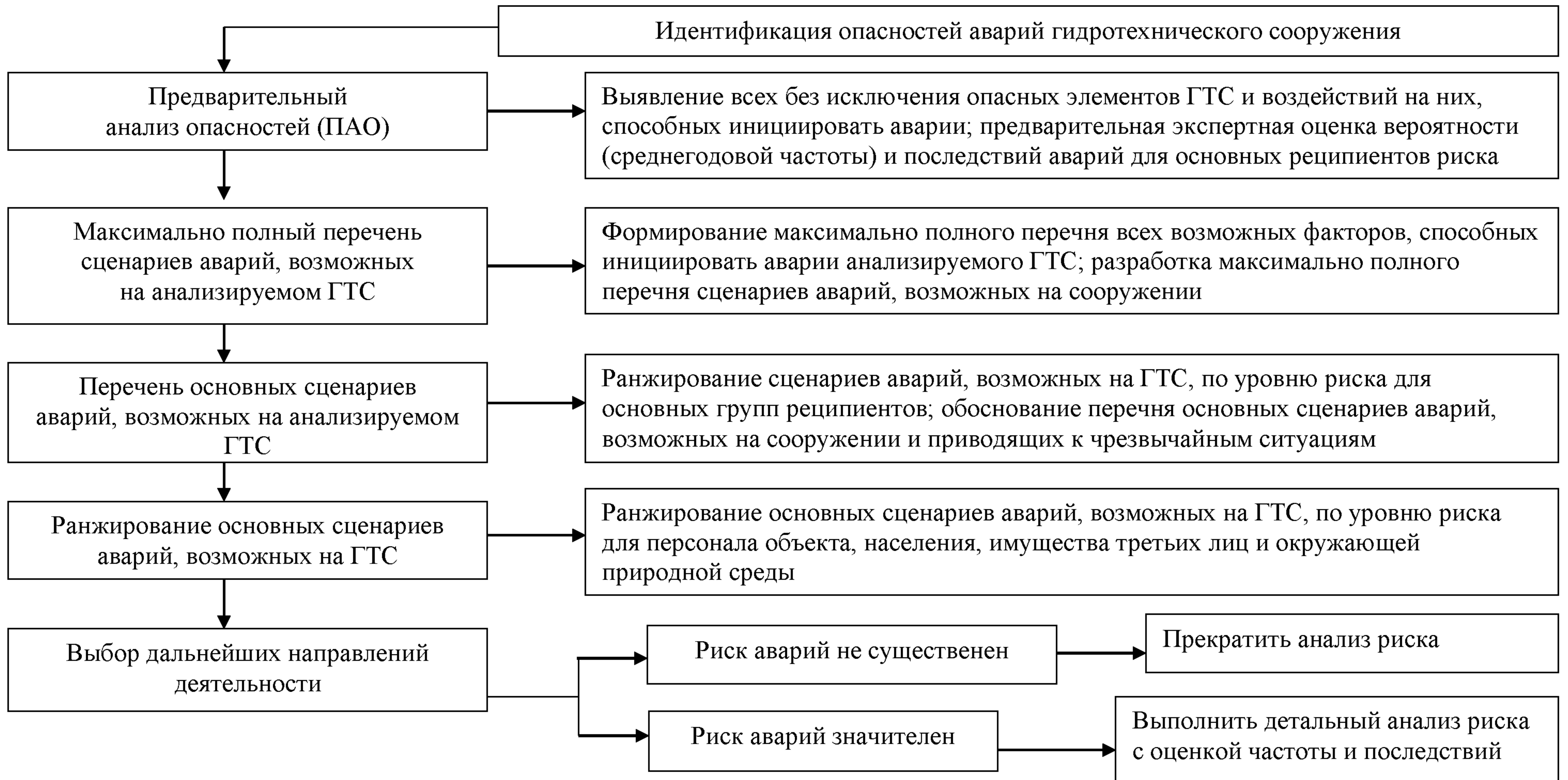
Рисунок 1 - Основные шаги процедуры анализа риска аварий гидротехнических сооружений
