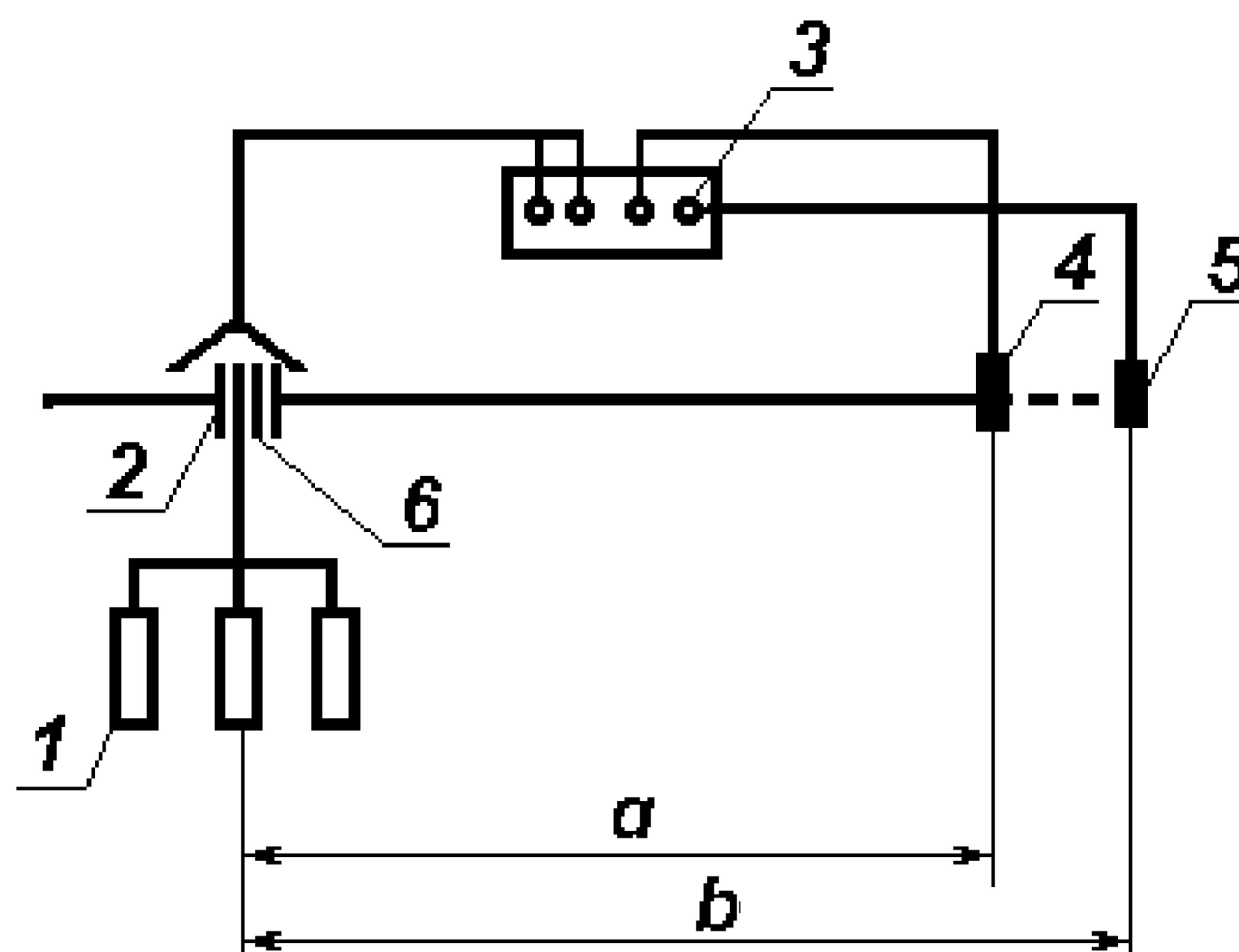
1 – анодные заземлители; 2 – контрольно-измерительный пункт; 3 – измерительный прибор; 4 – вспомогательный электрод; 5 – питающий электрод; 6 – дренажный провод.
