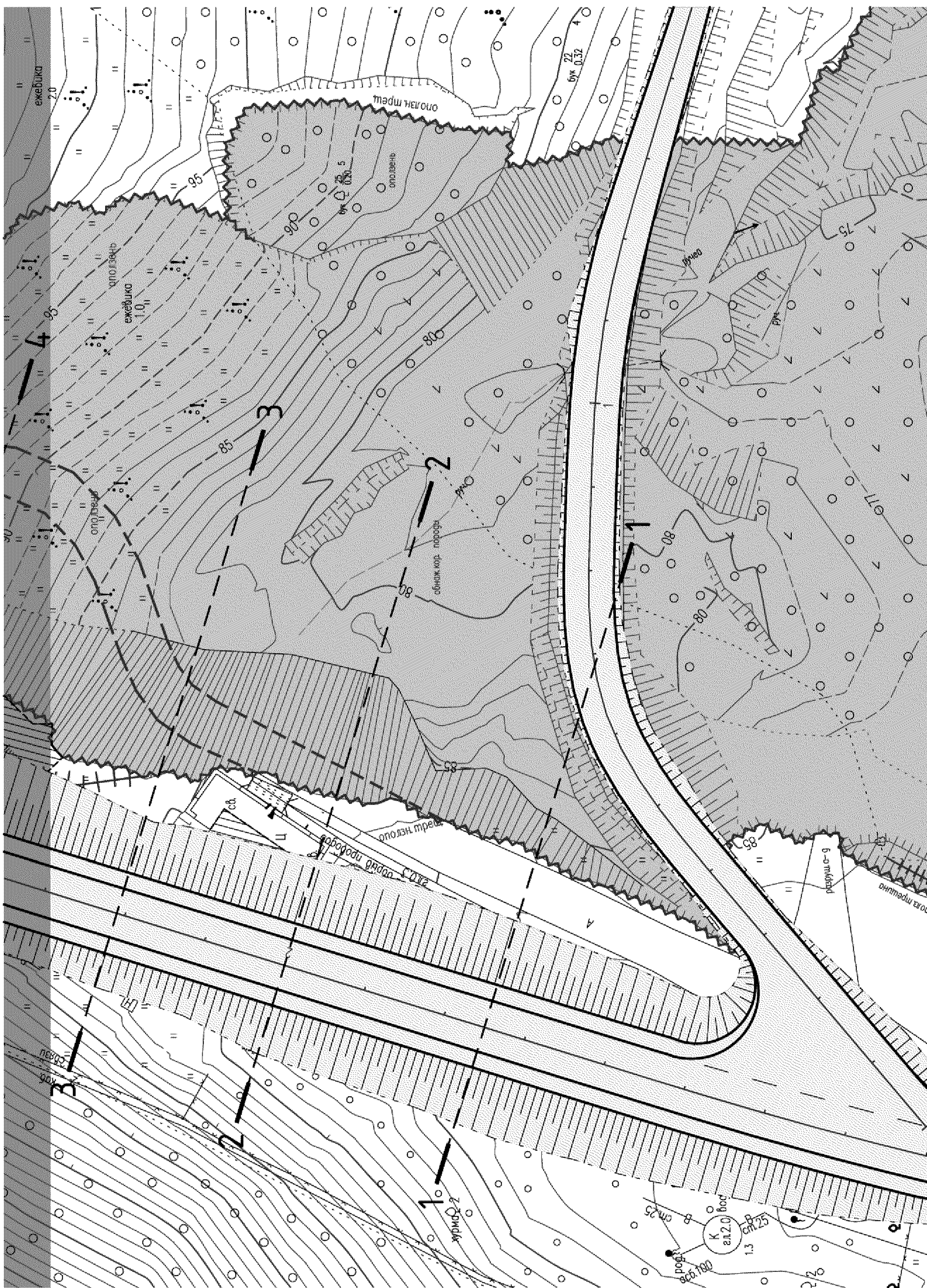
Рисунок А.3 – Проект вертикальной планировки защищаемого участка авто- дороги (конец)
