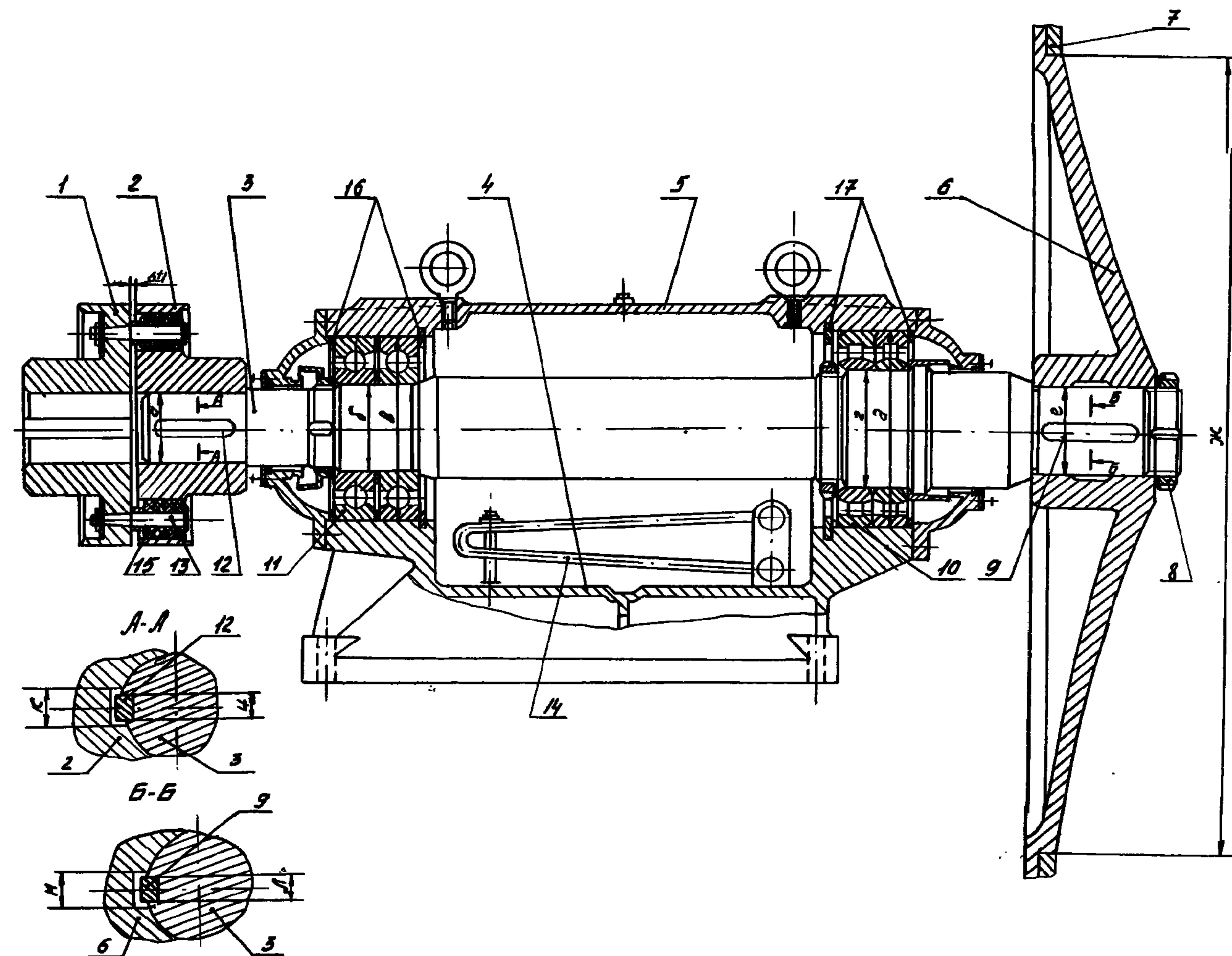
1 – полумуфта ведущая; 2 – полумуфта ведомая; 3 – вал; 4 – корпус; 5 – крышка корпуса; 6 – ступица; 7 – крыльчатка; 8 – гайка круглая; 9 – шпонка; 10 – роликоподшипник радиальный № 32244; 11 – шарикоподшипник радиально–упорный № 66432; 12 – шпонка; 13 – палец; 14 – змеевик; 15 – кольцо резиновое; 16 – 17 – кольцо компенсирующее
