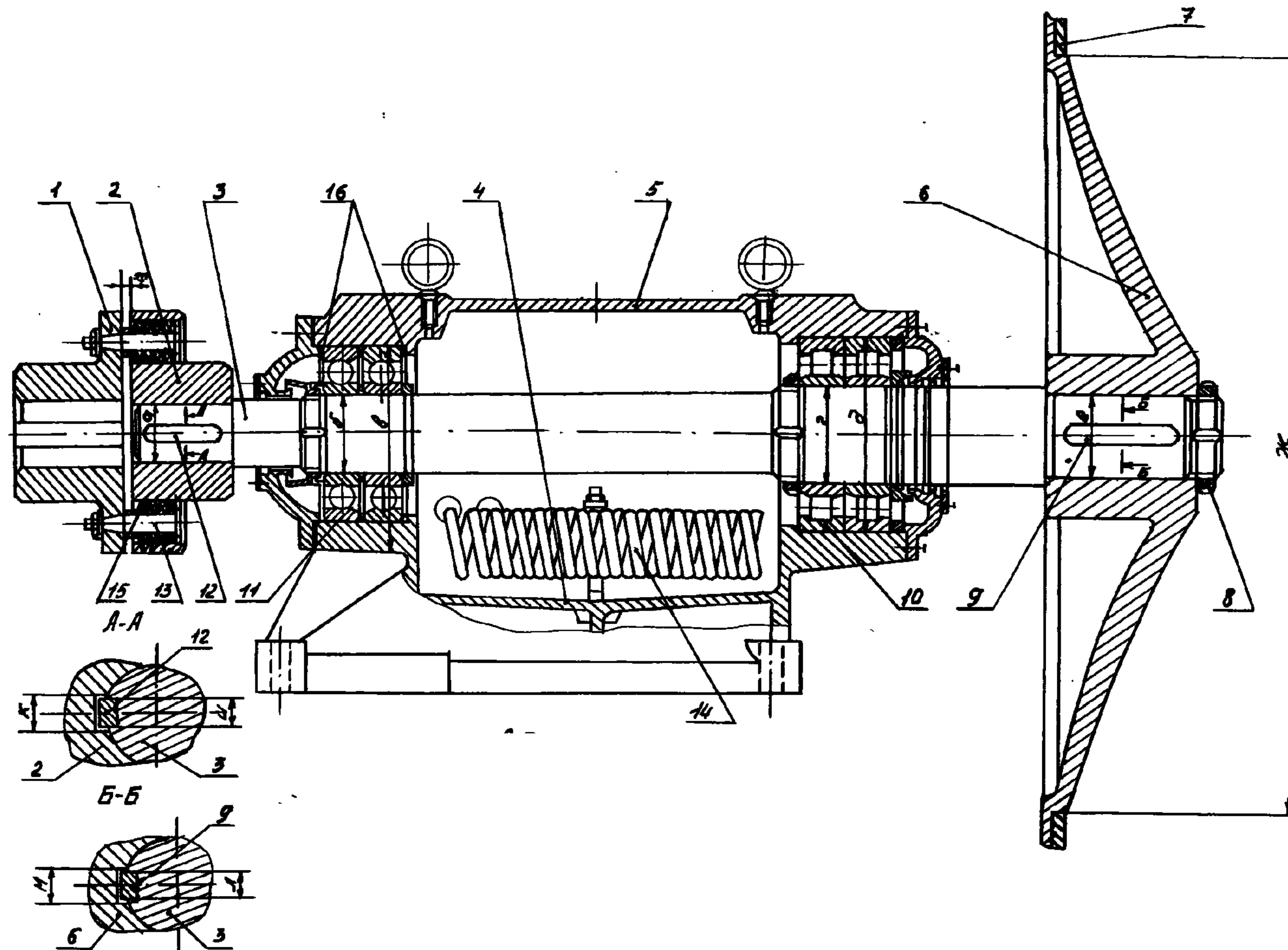
1 – полумуфта ведущая; 2 – полумуфта ведомая; 3 – вал; 4 – корпус; 5 – крышка корпуса; 6 – ступица; 7 – крыльчатка; 8 – гайка круглая;
