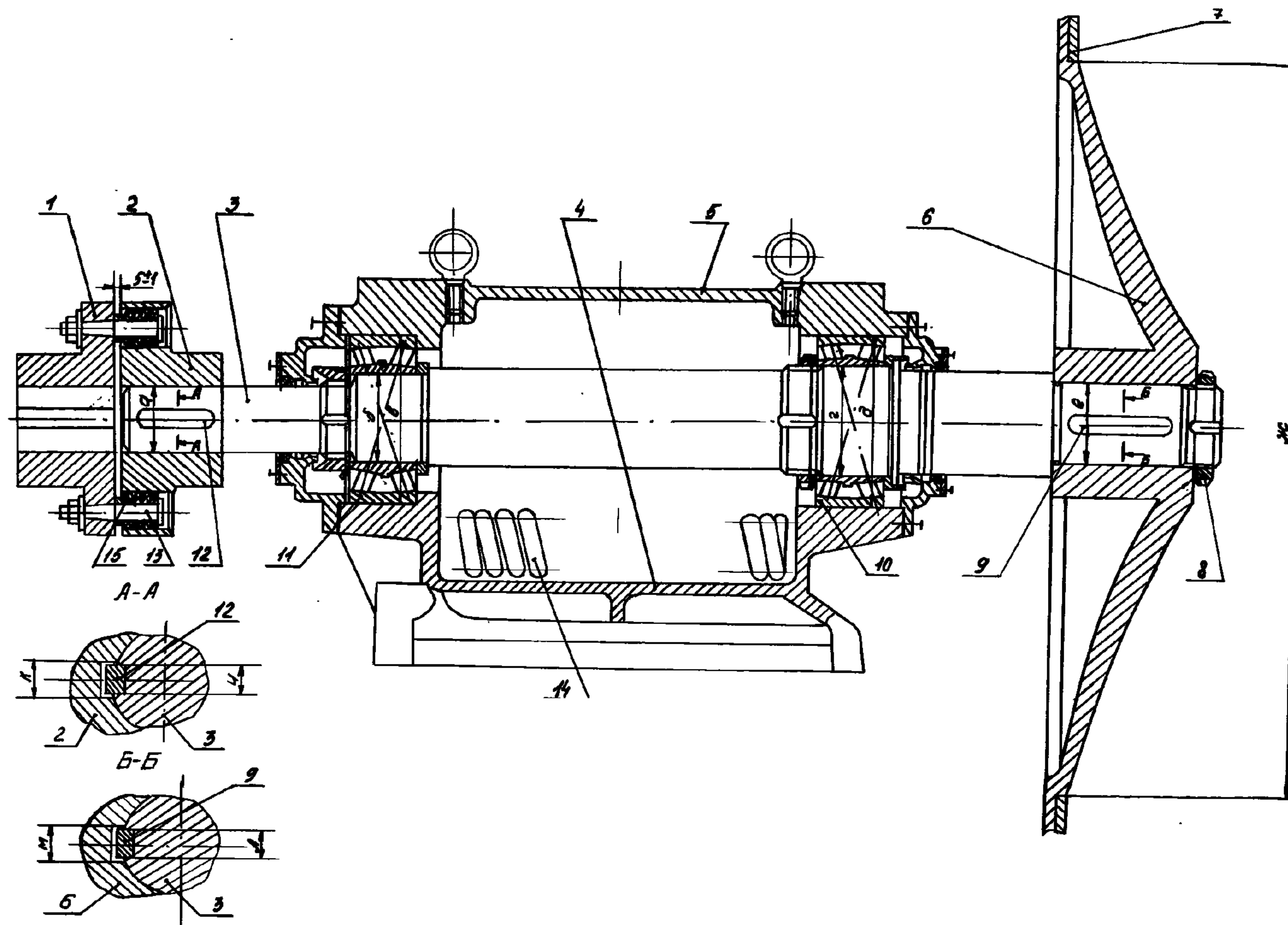
1 – полумуфта ведущая; 2 – полумуфта ведомая; 3 – вал; 4 – корпус; 5 – крышка корпуса; 6 – ступица; 7 – крыльчатка; 8 – гайка круглая; 9 – шпонка; 10 – роликоподшипник радиальный сферический № 3530; 11 – роликоподшипник радиальный сферический № 3626; 12 – шпонка; 13 – палец; 14 – змеевик; 15 – кольцо резиновое
