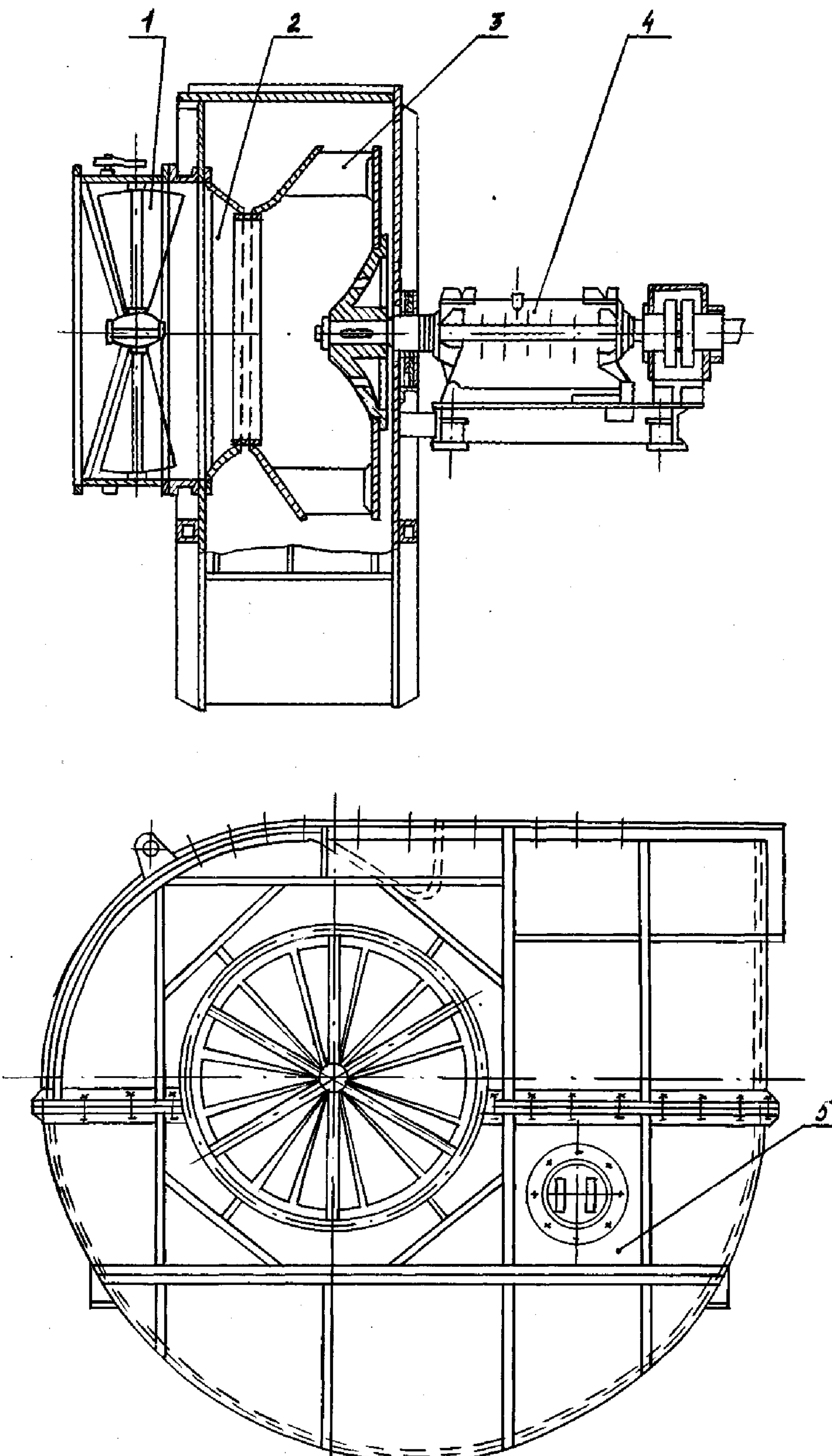
1 – направляющий аппарат; 2 – воронка всасывающая; 3 – колесо рабочее; 4 – ходовая часть;
