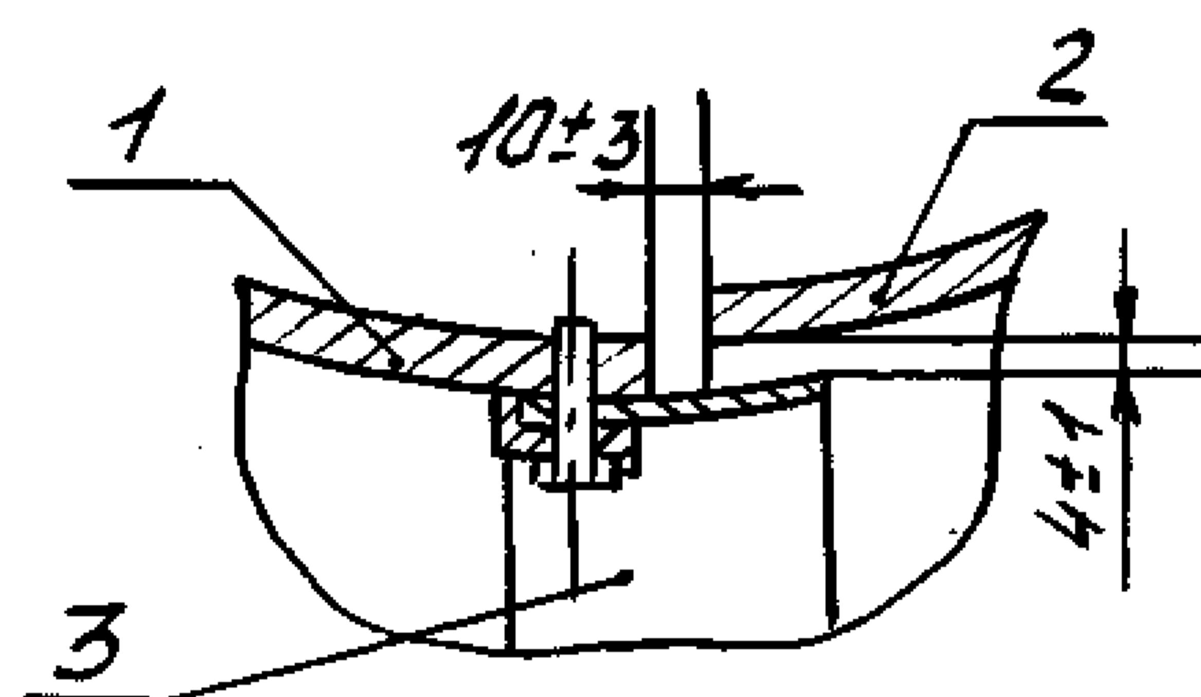
1 – воронка всасывающая; 2 – рабочее колесо; 3 – полоса уплотнительная
