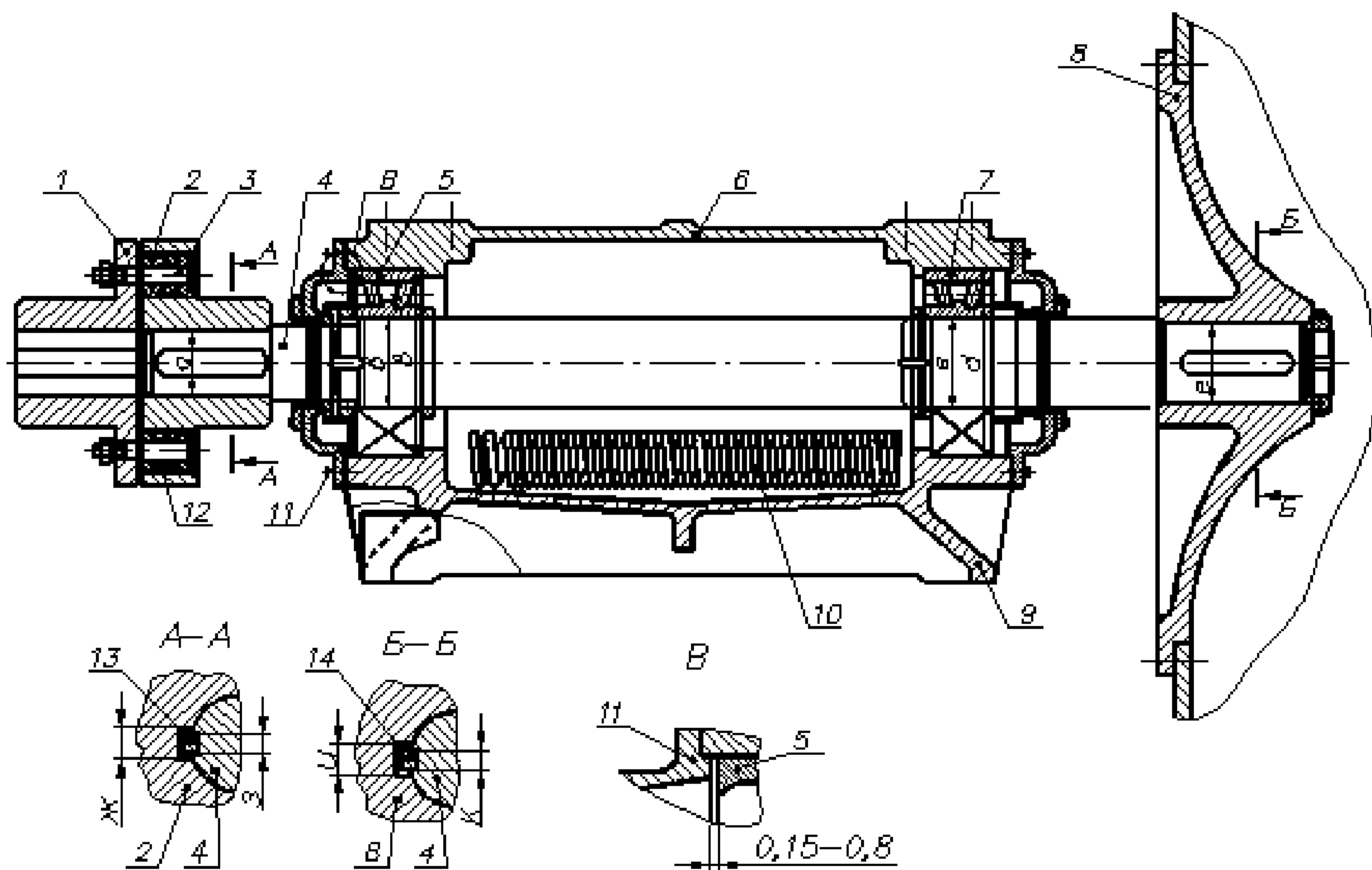
1 – полумуфта моторная; 2 – полумуфта ведомая; 3 – палец 38; 4 – вал;
