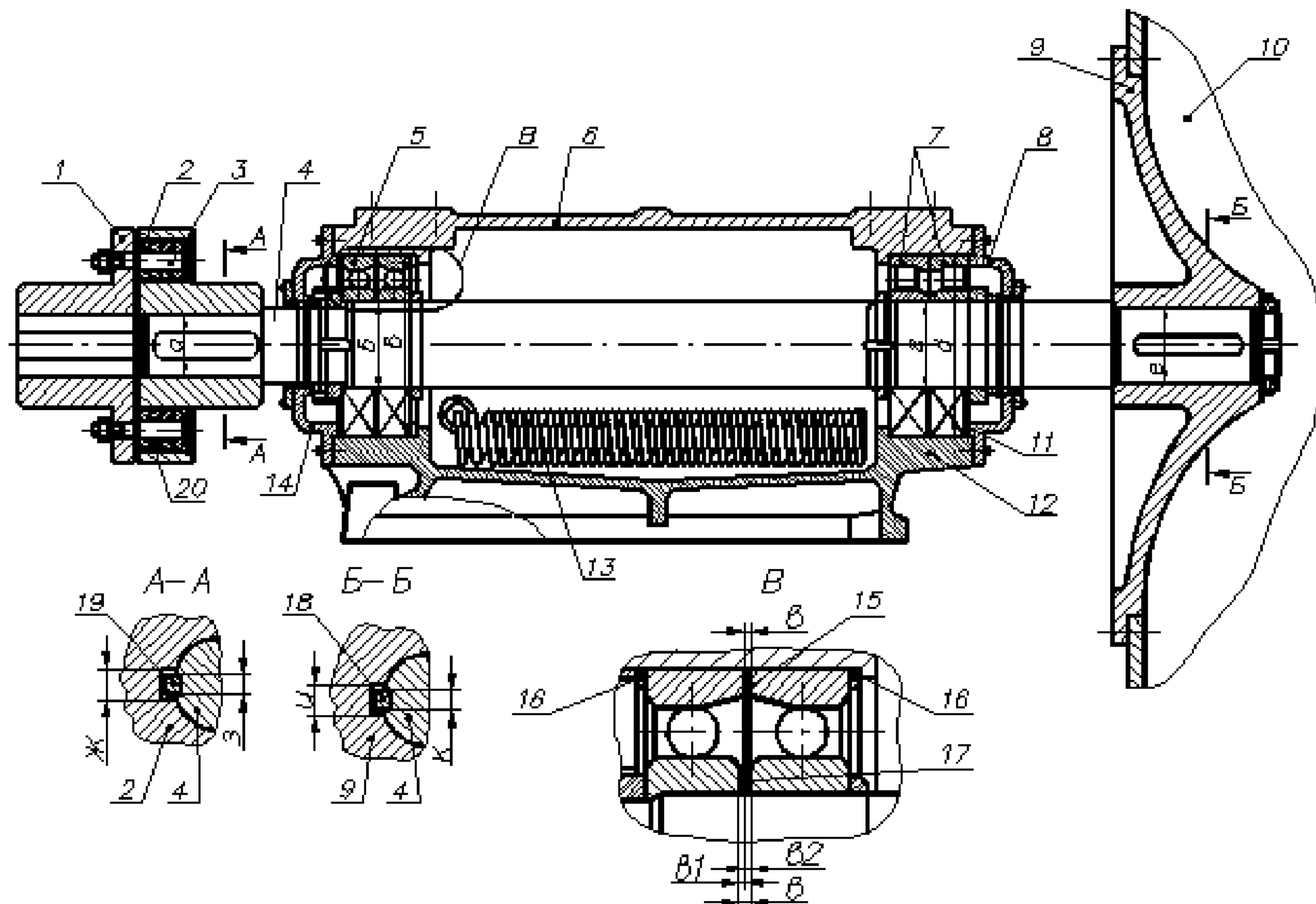
1 – полумуфта моторная; 2 – полумуфта ведомая; 3 – палец 38; 4 – вал;
