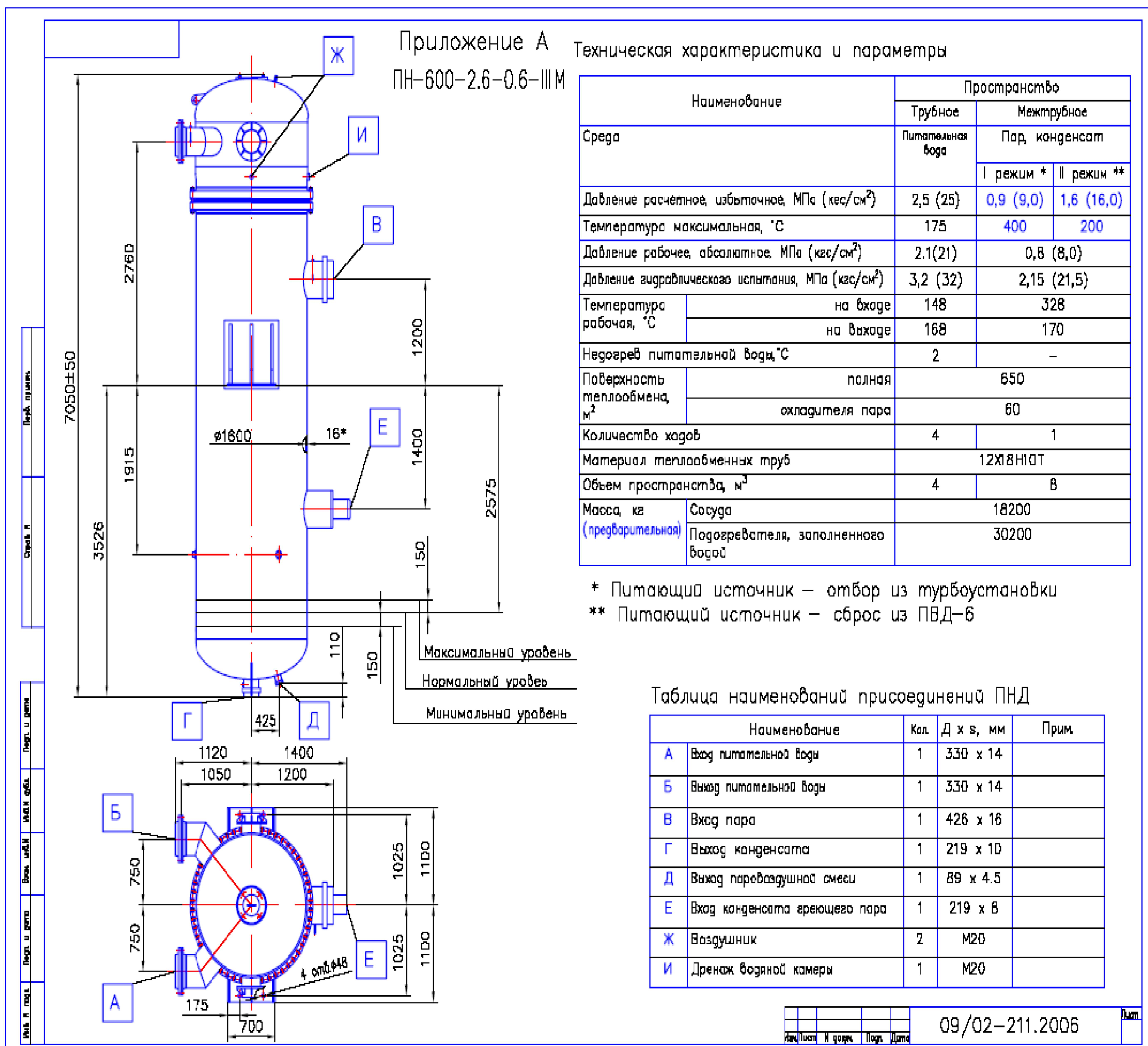
Рисунок Г.1. Технические характеристики и параметры ПН-600-2.6-0.6-IIIМ
