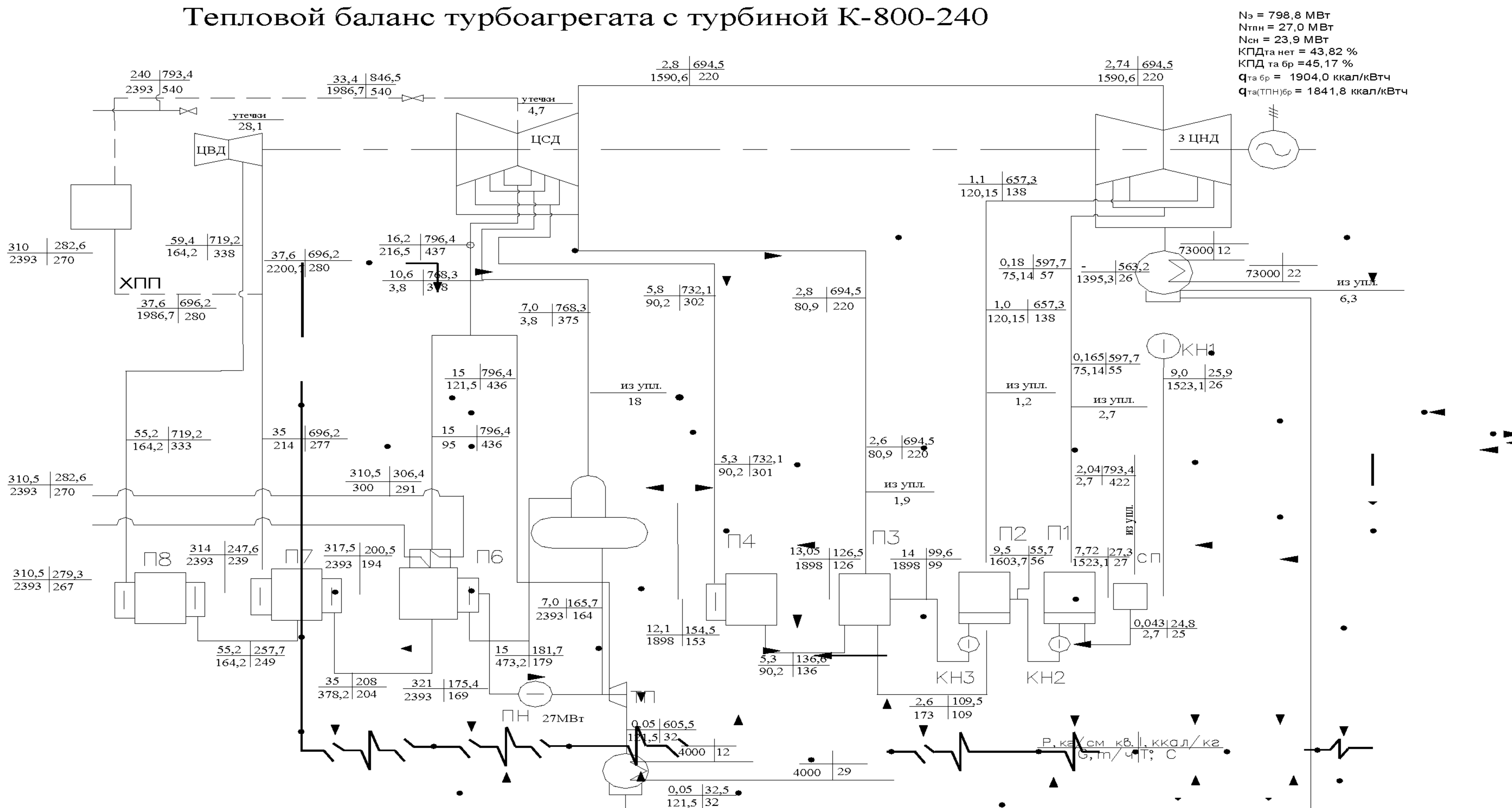
Рисунок А.1. Пример теплового баланса ПТУ
