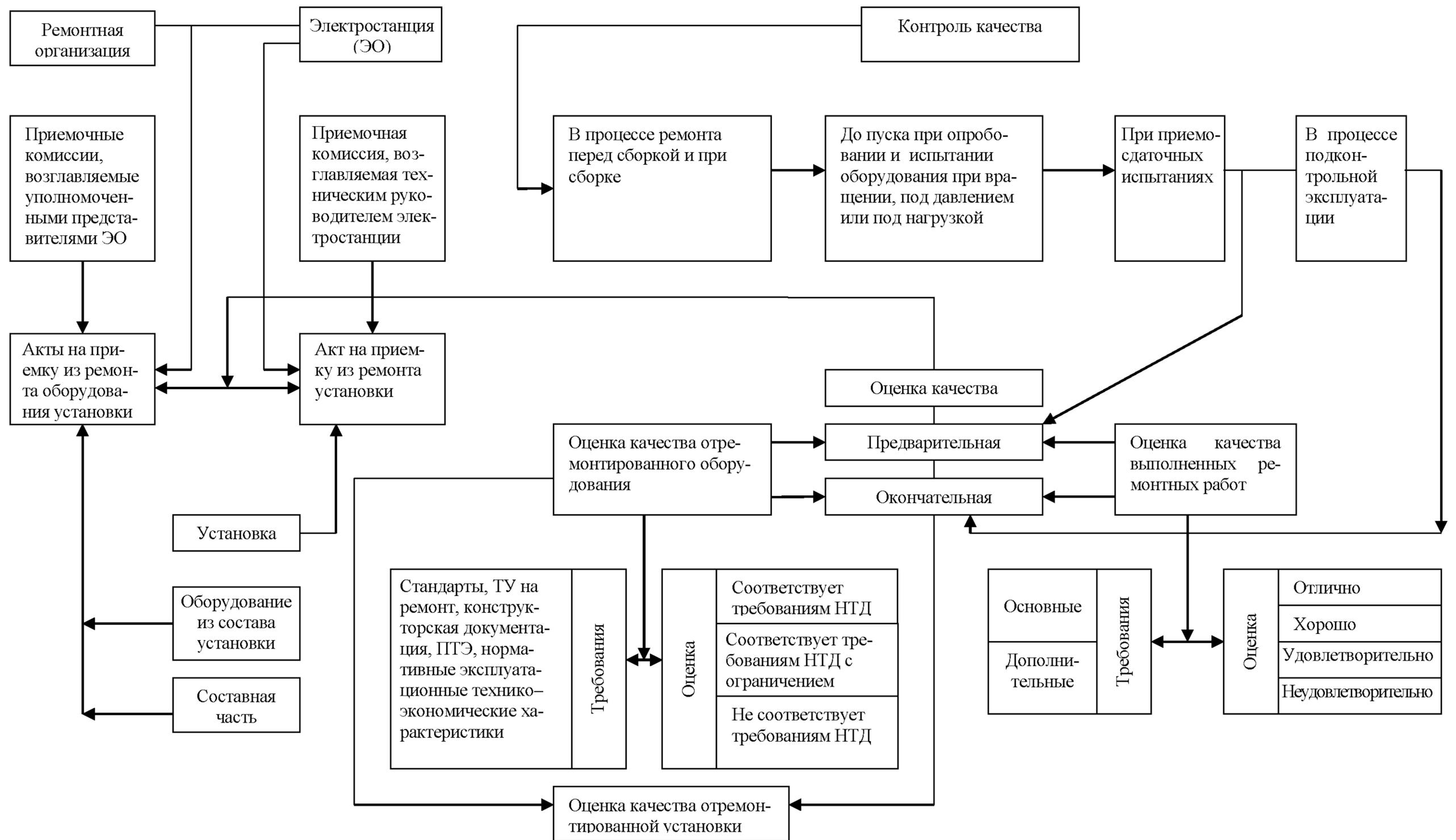
Рисунок 1 – Принципиальная схема оценки качества ремонта
