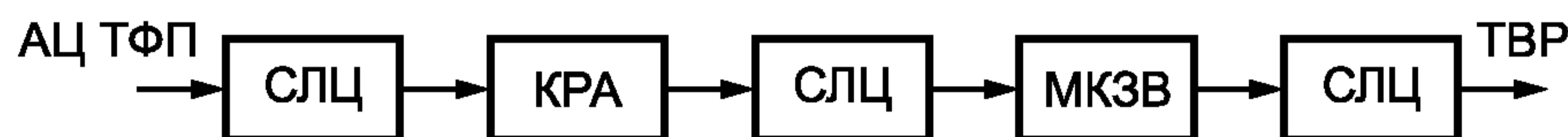
Рисунок 2 — Тркт первичного распределения программ звукового вещания с оптоволоконными и кабельными системами передачи
