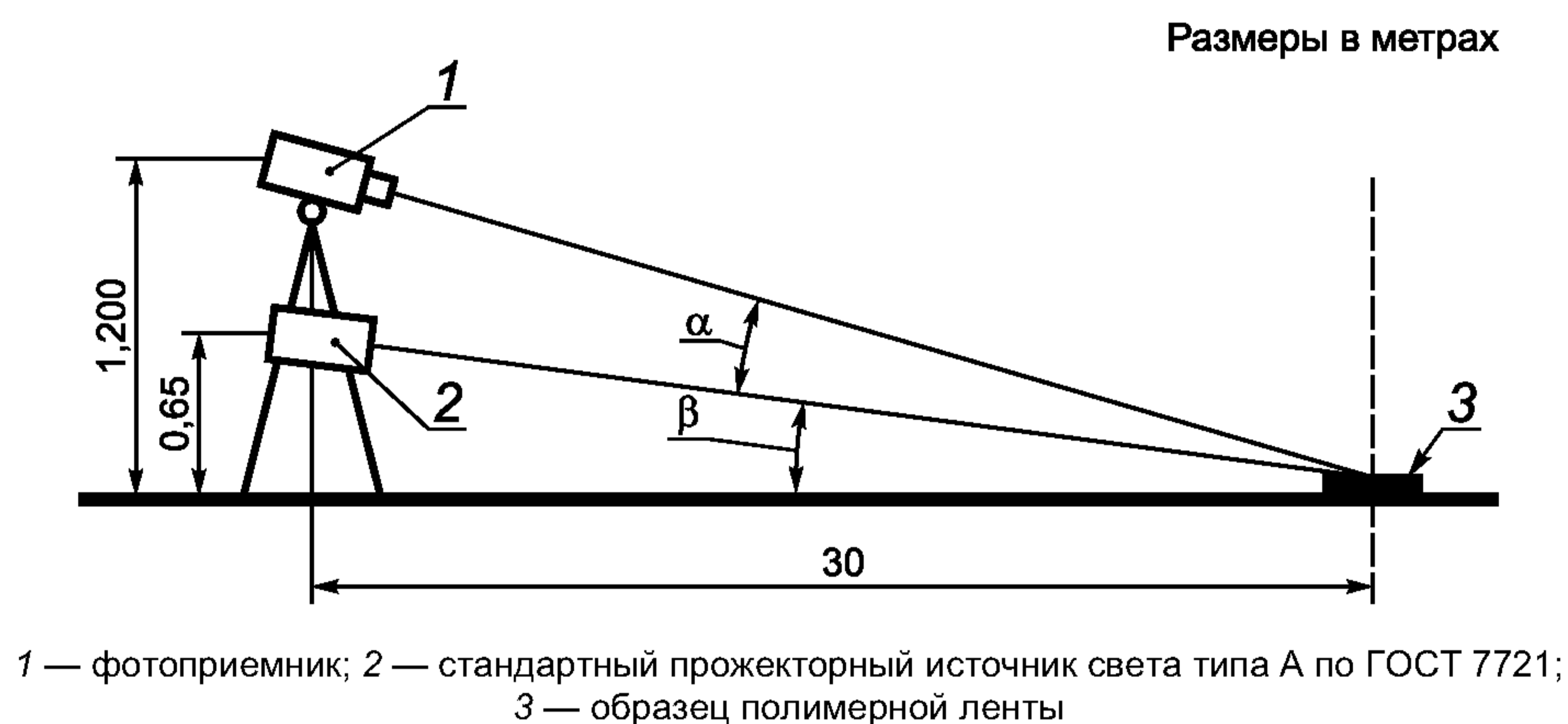
Рисунок 3 — Условия определения углов для измерения коэффициента световозвращения полимерных лент для условий темного времени суток при освещении фарами автомобиля
