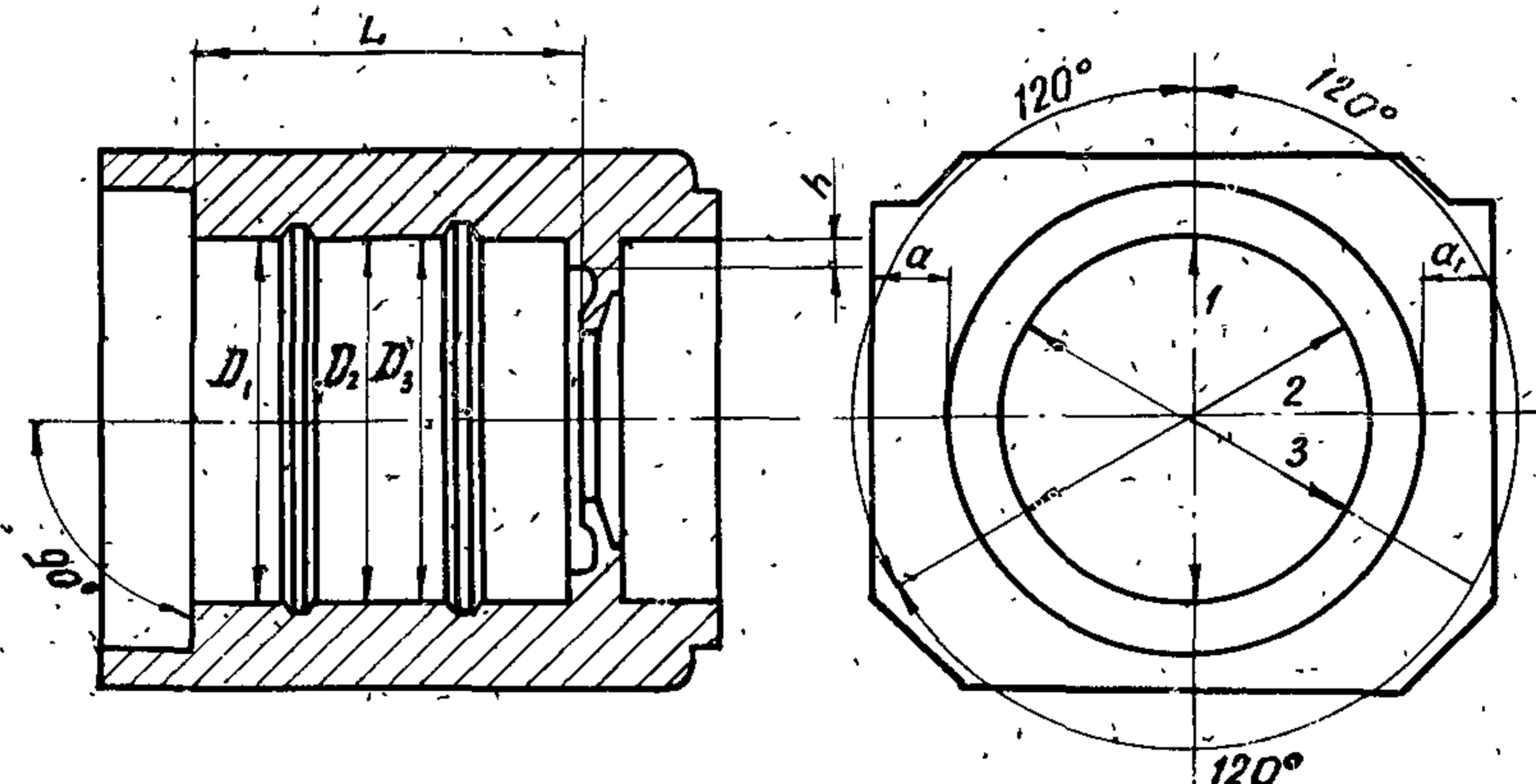
Рис. 4. Схема измерения посадочных мест в корпусе: I, 2, 3 – замеры диаметра по окружности посадочного места в корпусе;  $D_1 - D_3$  – замеры диаметра по длине посадочного места;  $L, a, a_1, h$  – замеры для контроля размеров
