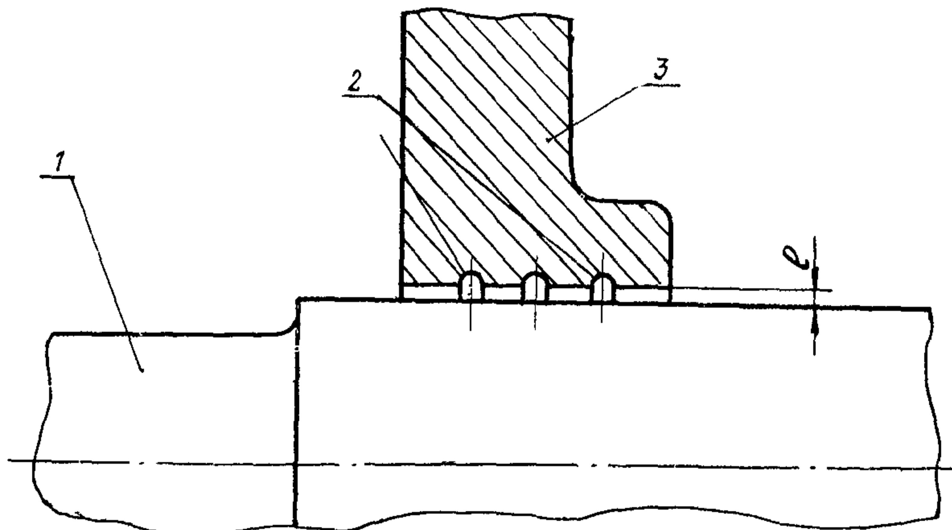
Рис. 6. Уплотнение подшипника кольцевыми проточками:
