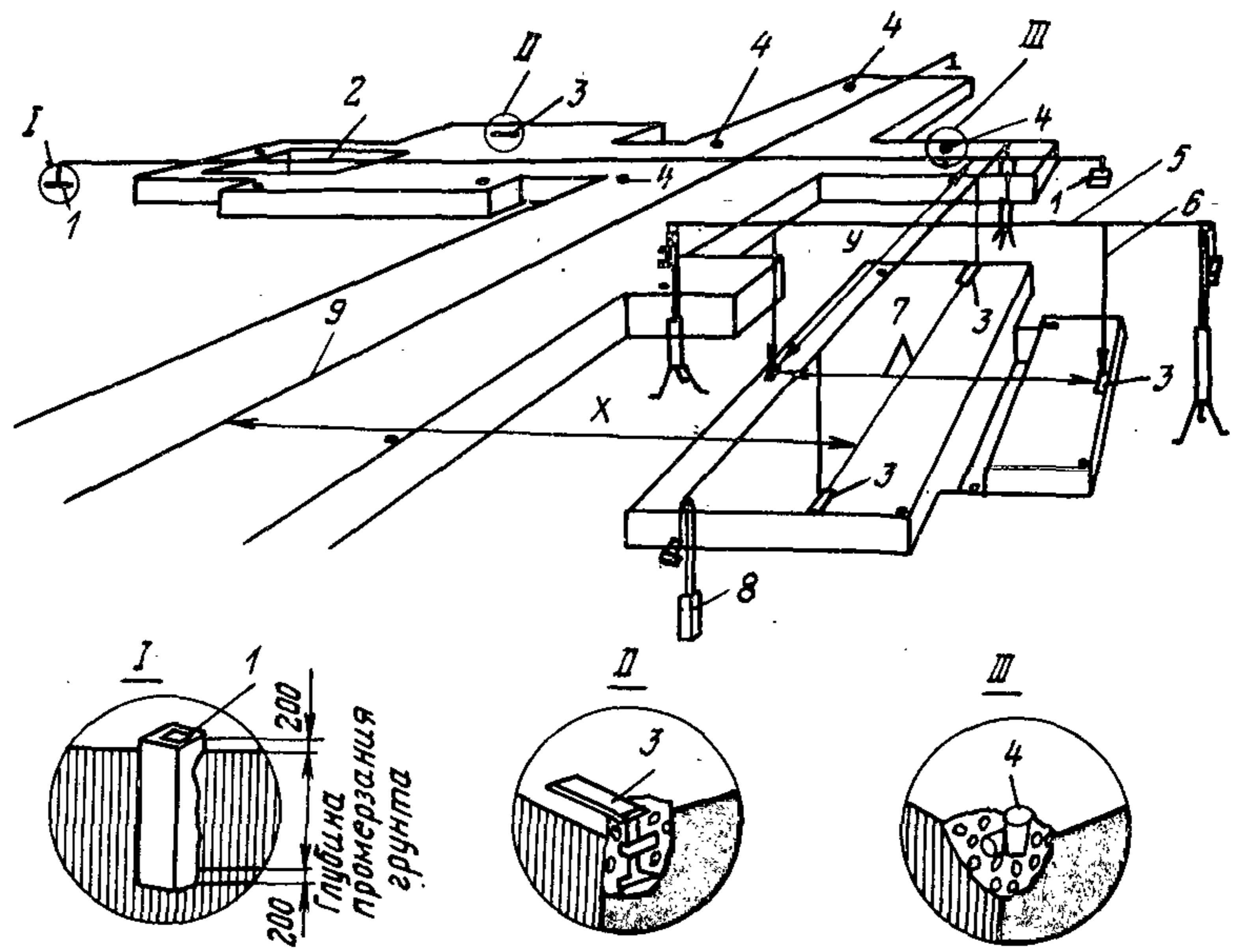
Рис. I. Схема геодезического обоснования монтажа оборудования прокатного стана: I – репер для закрепления основных осей; 2 – ось рабочей линии; 3 – осевая плашка; 4 – репер; 5 – струна; 6 – отвес; 7 – рабочие оси; 8 – оседержатель; 9 – ось проката; х, у – расстояния между рабочими и основными осями
