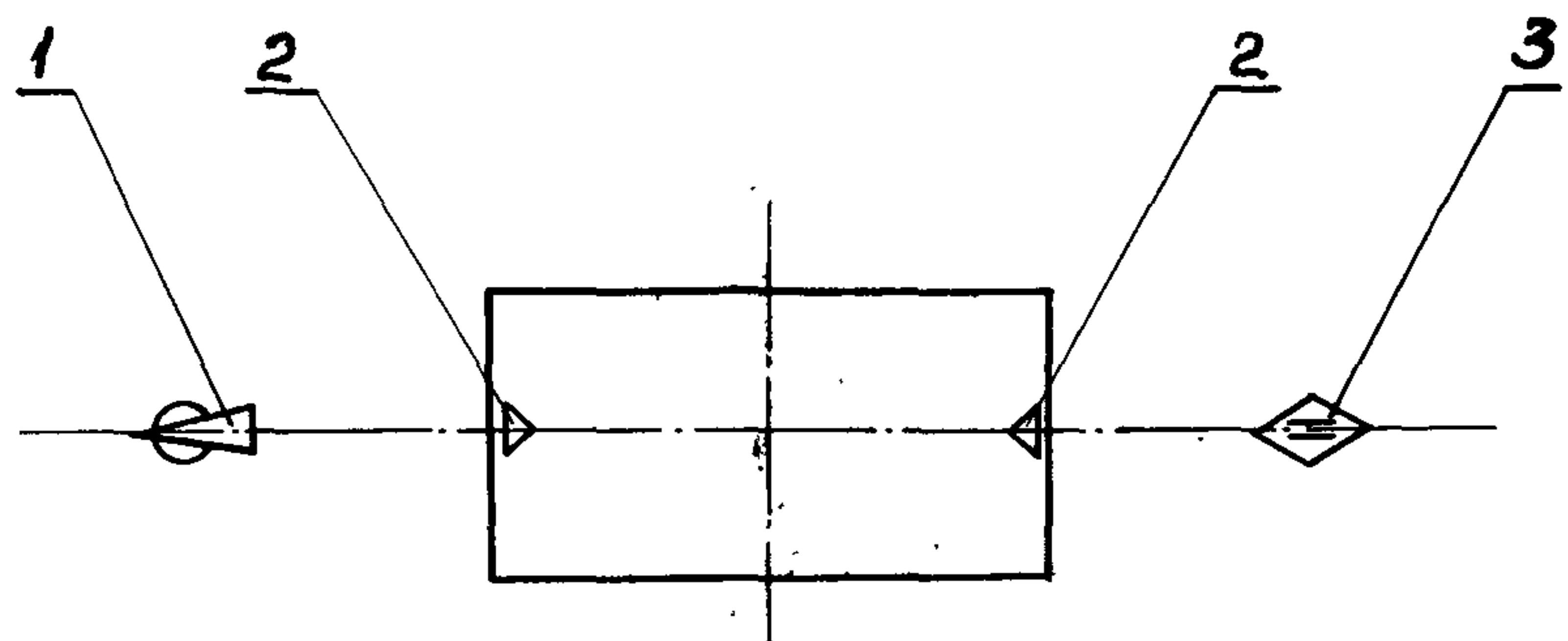
Рис. I. Схема выверки оборудования в плане способом "прямого визирования": 1 - теодолит; 2 - осевые знаки машины; 3 - стационарная визирная марка
