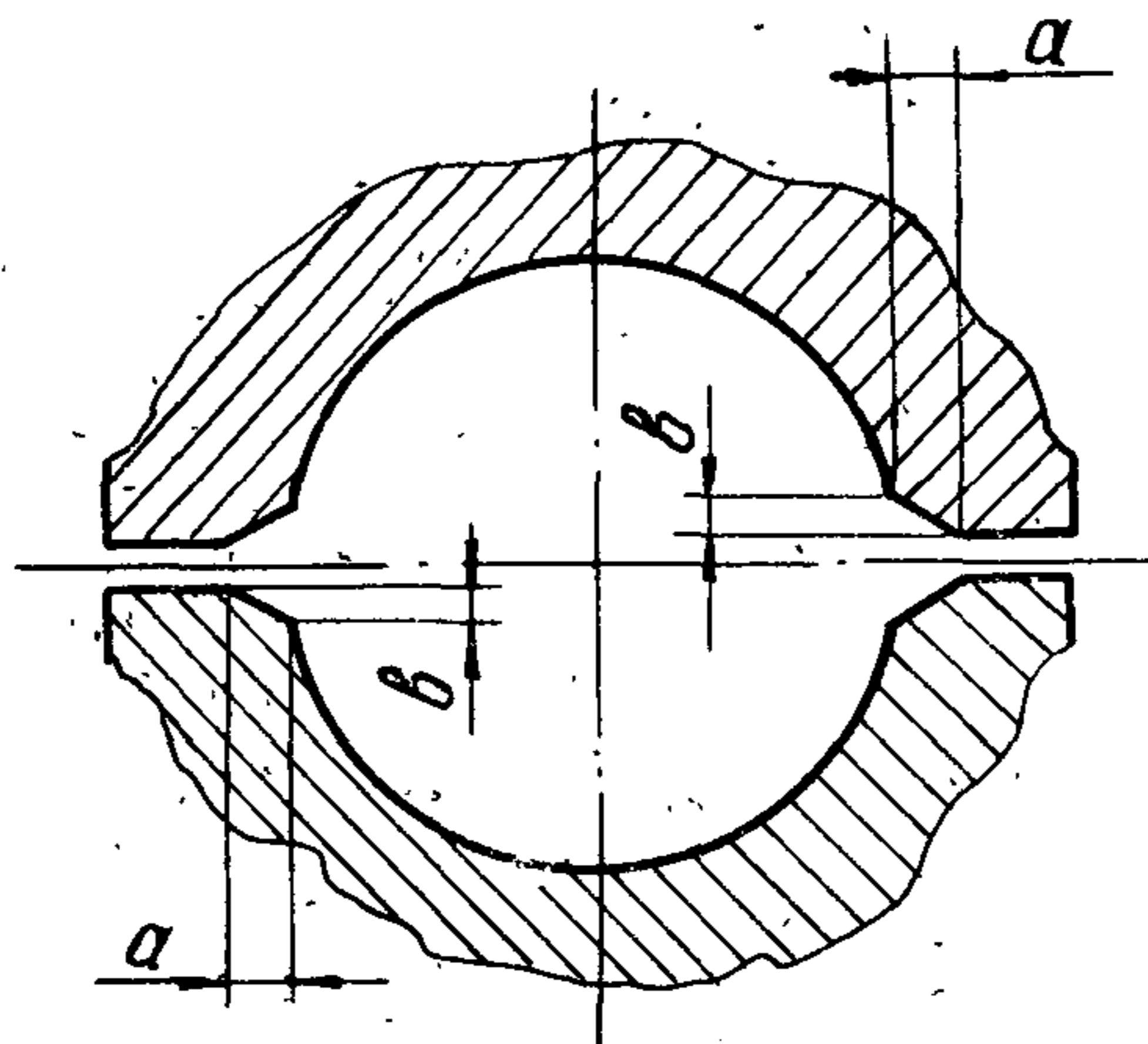
Рис. 5. Развалка посадочных поверхностей разъемных корпусов и зазор между корпусом и крышкой:
