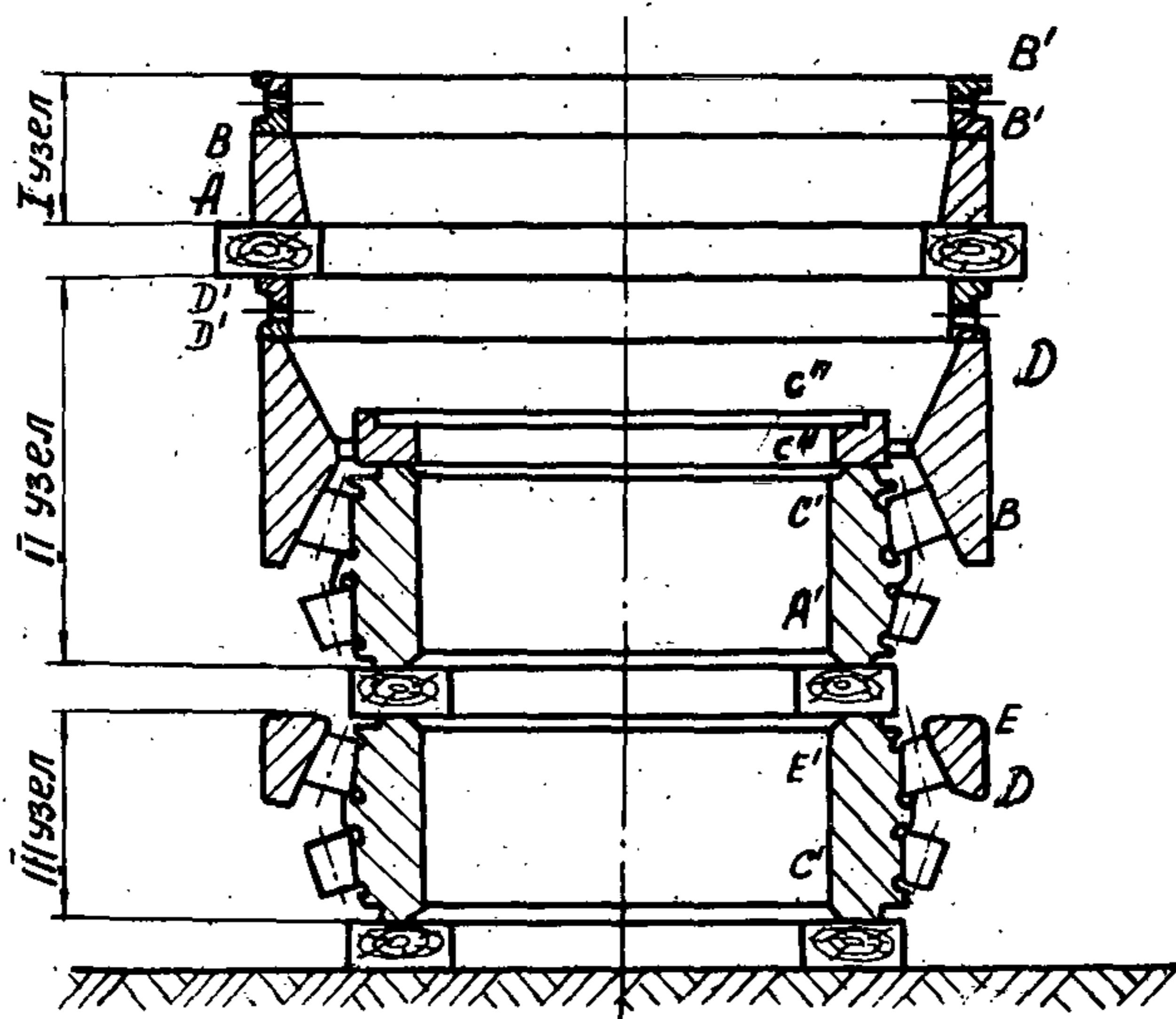
Рис. 9. Порядок укладки четырехрядного конического роликоподшипника перед монтажом:  $A'B'$ ,  $B'D'$ ,  $D'E'$  — наружные кольца;  $A'C'$ ,  $C'E'$  — внутренние кольца;  $B'B'$ ,  $D'D'$ ,  $C''C''$  — дистанционные кольца
