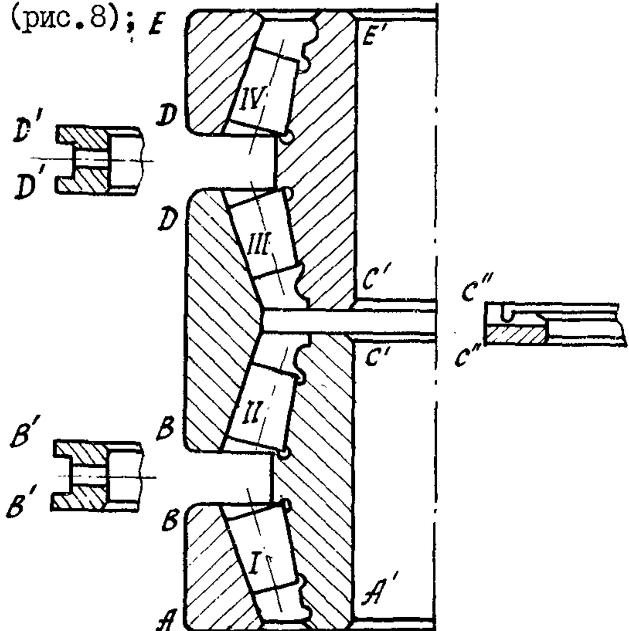
Рис. 8. Сборочная маркировка четырехрядного роликоподшипника:  $A, B, C, D, E$  - наружные кольца;  $A', C', C'E', B', D'$  - внутренние кольца;  $B'B', C''C'', D'D'$  - дистанционные кольца; I, II, III, IV - ролики
