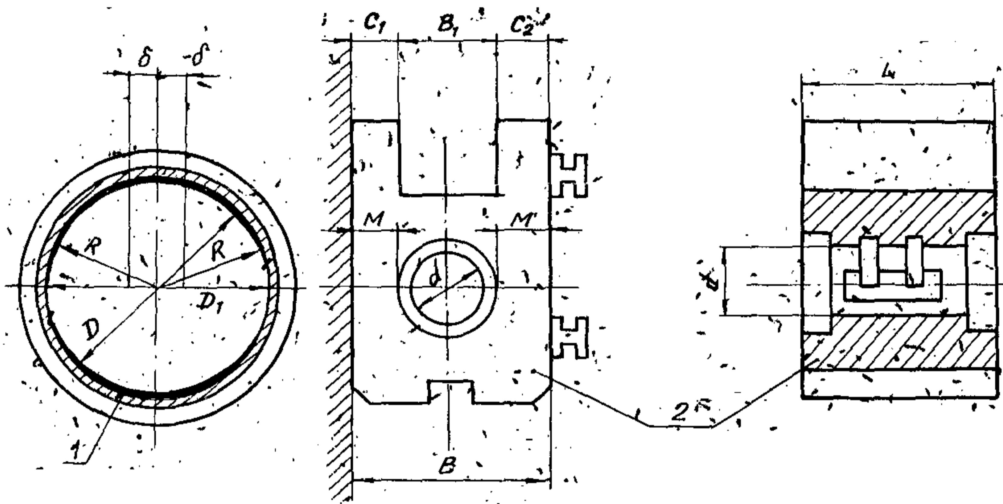
Рис. II. Схема проверки размеров деталей подшипников жидкостного трения: 1 - втулка-вкладыш; 2 - подушка;  $\delta$ ,  $R$ ,  $D$ ,  $D_1$  - размеры, контролируемые на втулке-вкладыше;  $C_1$ ,  $C_2$ ,  $B_1$ ,  $B_2$ ,  $M$ ,  $L$ ,  $d$  - размеры, контролируемые на подушке.
