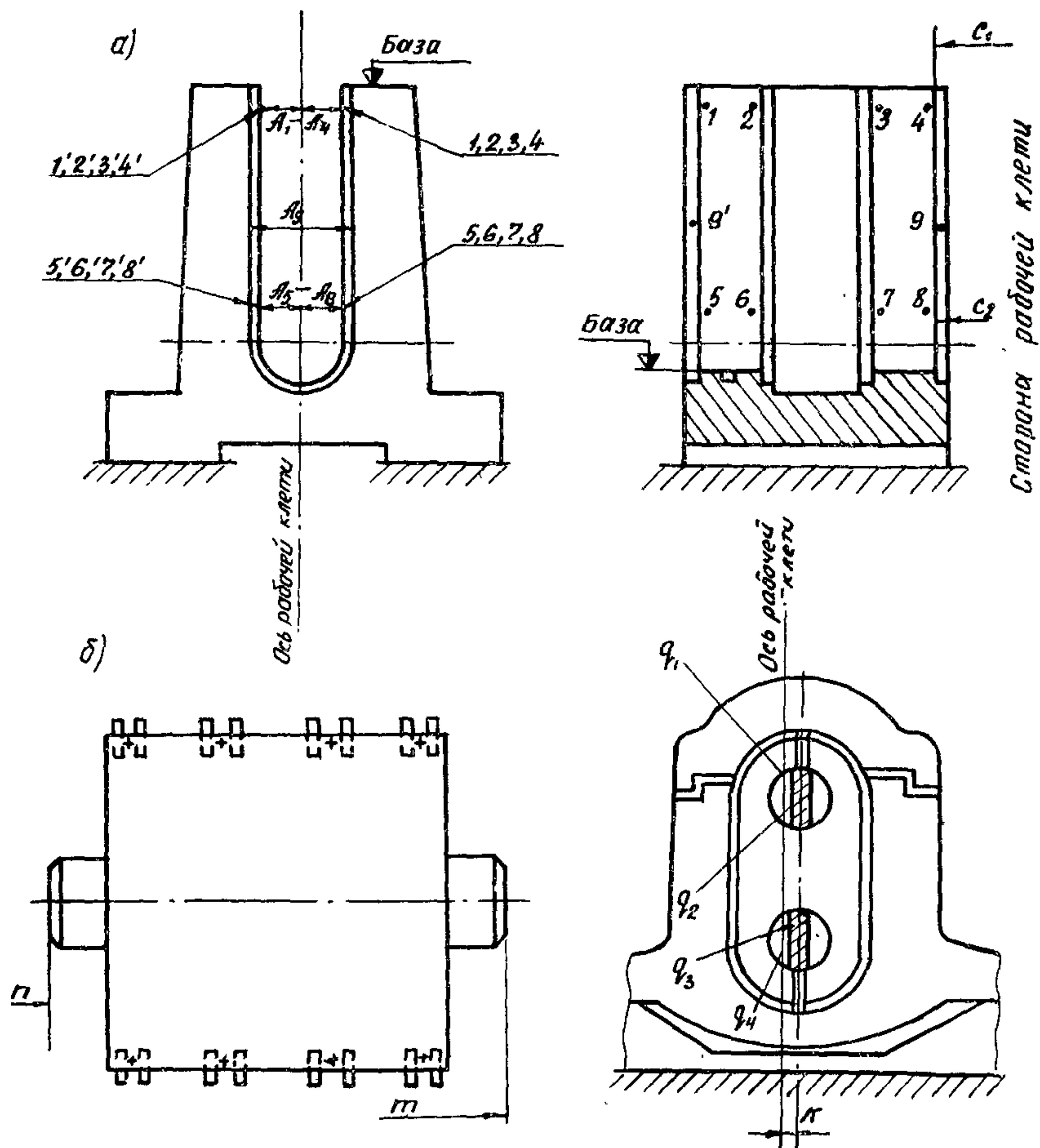
а - выверка станины; б - выверка клети в сборе;  $I - I'$  и  $I' - I'$  - точки измерения размеров  $A_1 - A_9$  окон станины;  $C_1$ ,  $C_2$  - размеры от оси рабочей клети;  $n$ ,  $m$  - размеры от оси прокатки;  $q_1$  -  $q_4$  - размеры от оси рабочей клети до стенки лопасти;  $k$  - размер между осями рабочей и шестеренной клетей
