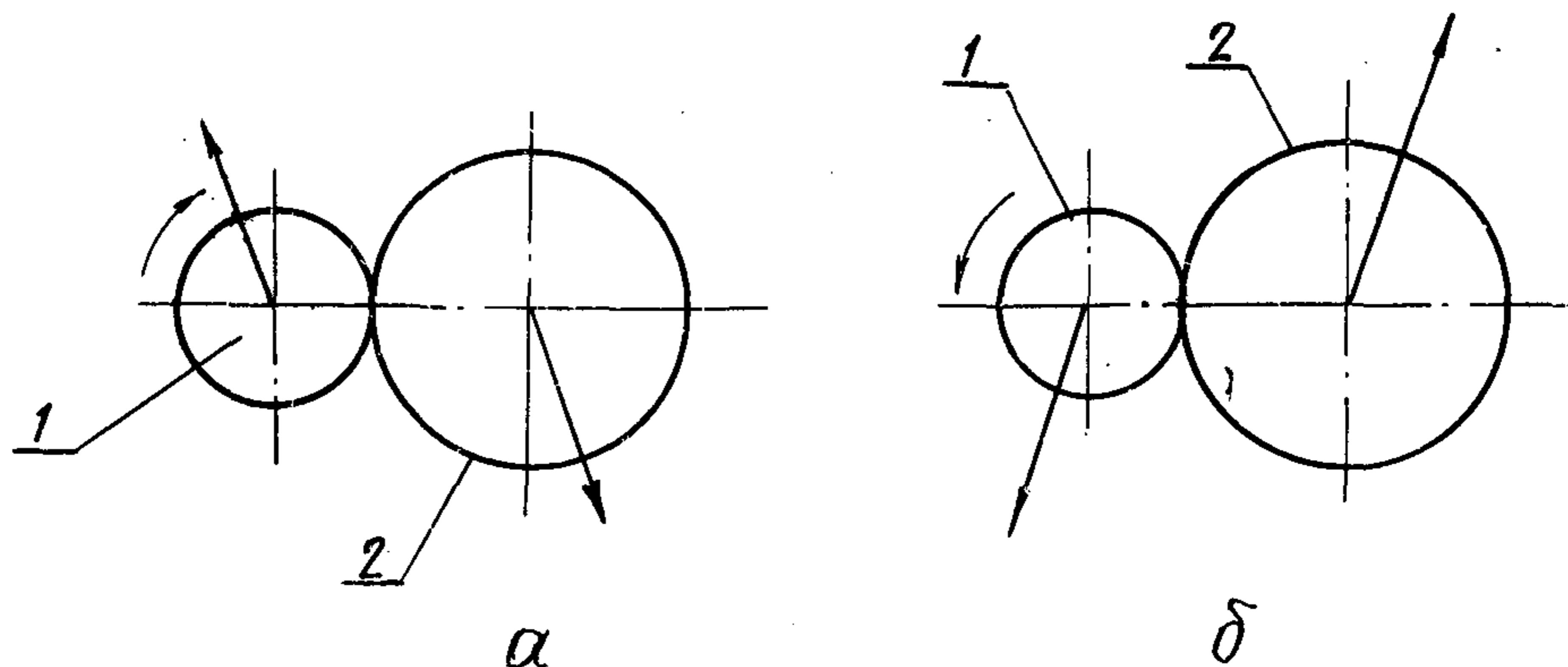
Рис. 2. Определение направления действия нагрузки в нереверсивных передачах: а - при вращении ведущего вала по часовой стрелке; б - при вращении ведущего вала против часовой стрелки; 1,2 - соответственно ведущий и ведомый валы
