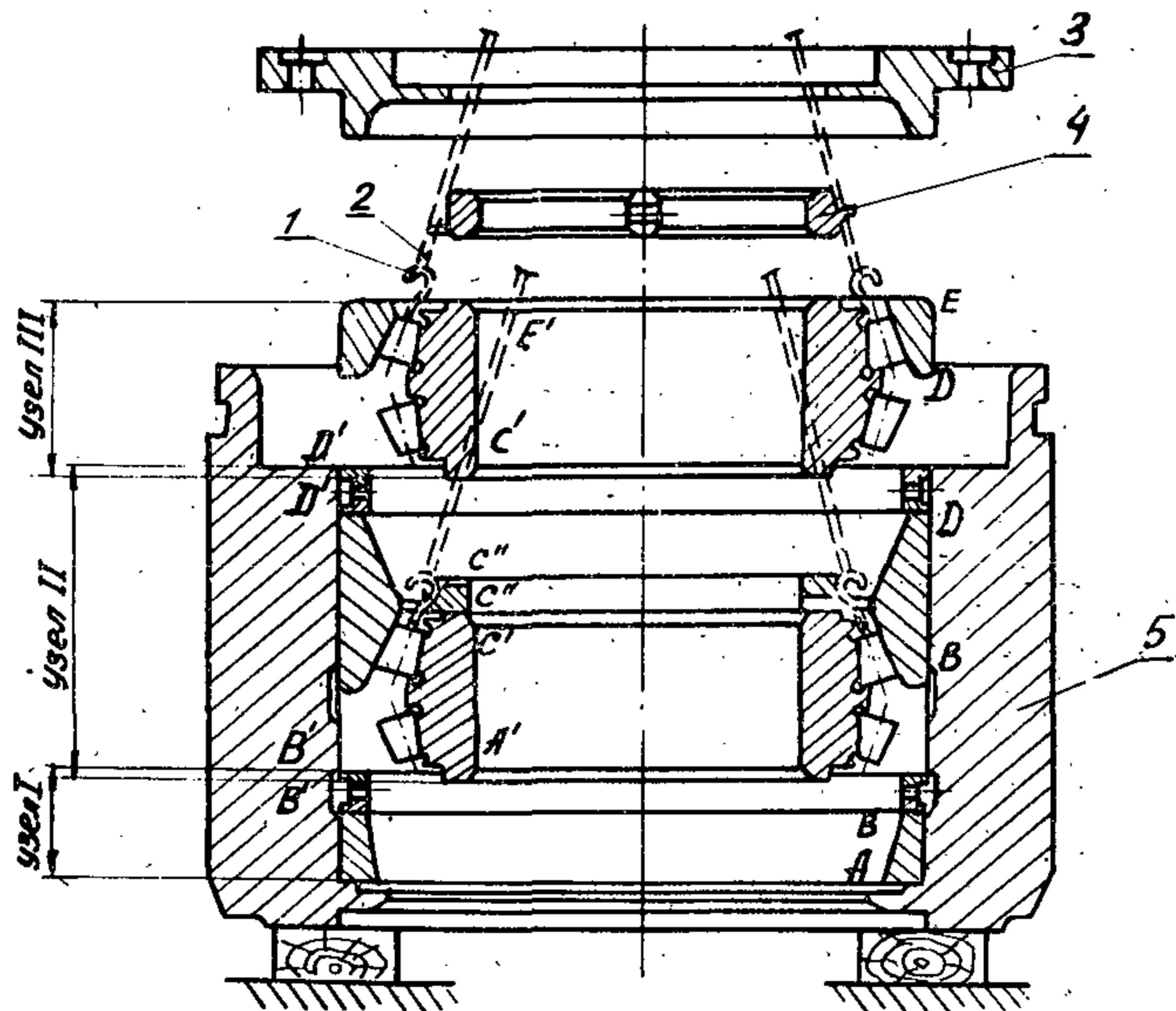
Рис. 10. Монтаж четырехрядного подшипника в подушку:
