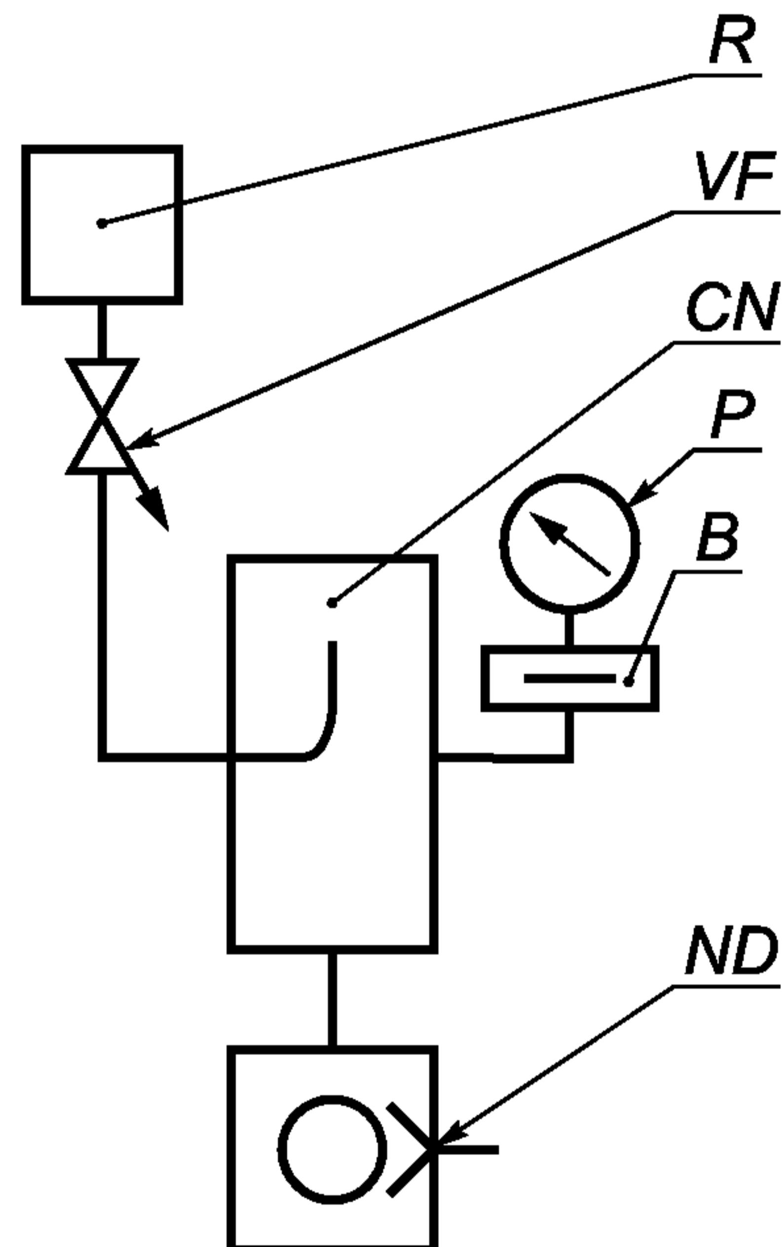
*R — устройство для измерения потока; VF — клапан-натекатель; CN — измерительная камера;
