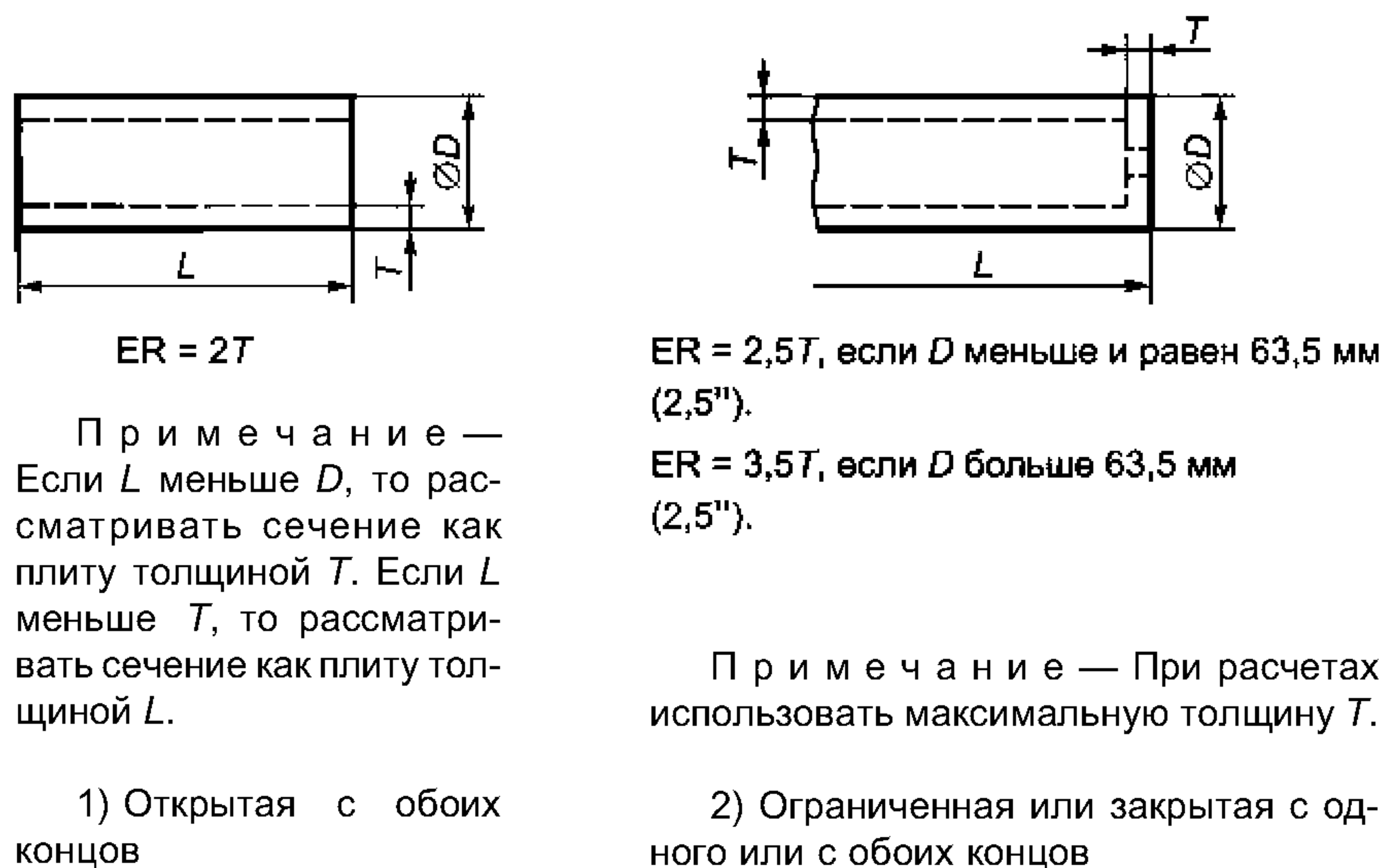
Рисунок 5 — Модели эквивалентного круга. Труба (любого сечения)
