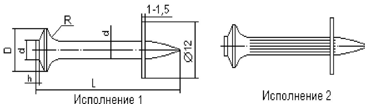
1.3.1. Дюбели должны изготавливаться обыкновенного и повышенного качества из катанки класса ВК или КК из стали марки 70 по DOT 14-15-37-85 или катанки класса ВД из стали марки 70 по ТУ 14.15-113-82. Допускается изготавливать дюбели из стали марки ст70 по ГОСТ 14959-79 подгруппы "в".
