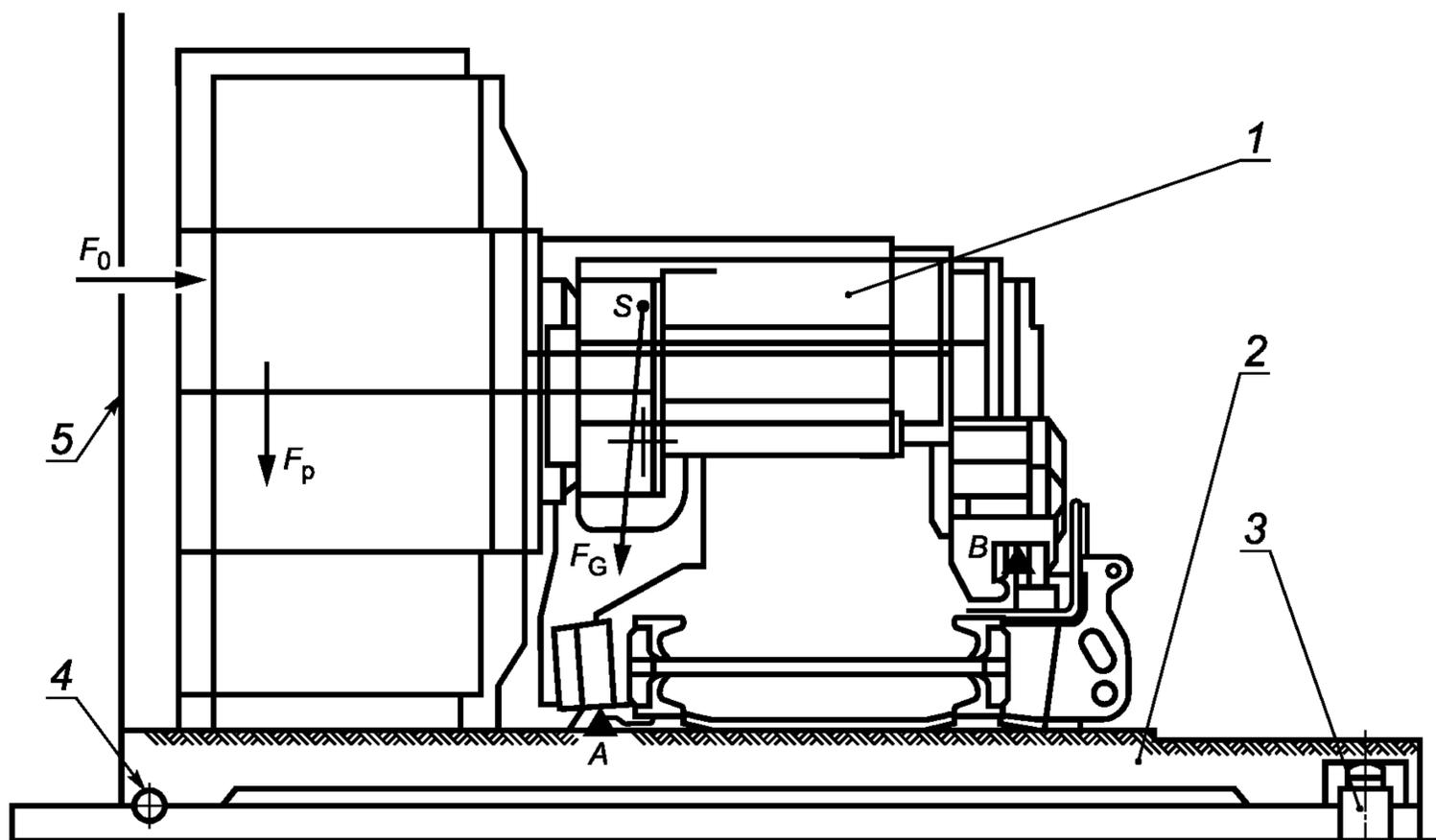
$A, B$  — усилия на опоры комбайна;  $S$  — центр тяжести комбайна;  $F_G$  — сумма массы комбайна  $M$  и сил на исполнительных органах радиальных  $F_p$  и осевых  $F_0$ ; 1 — испытательный комбайн; 2 — платформа для испытаний; 3 — гидродомкрат (гидродомкраты); 4 — шарнир; 5 — оградительный щит
