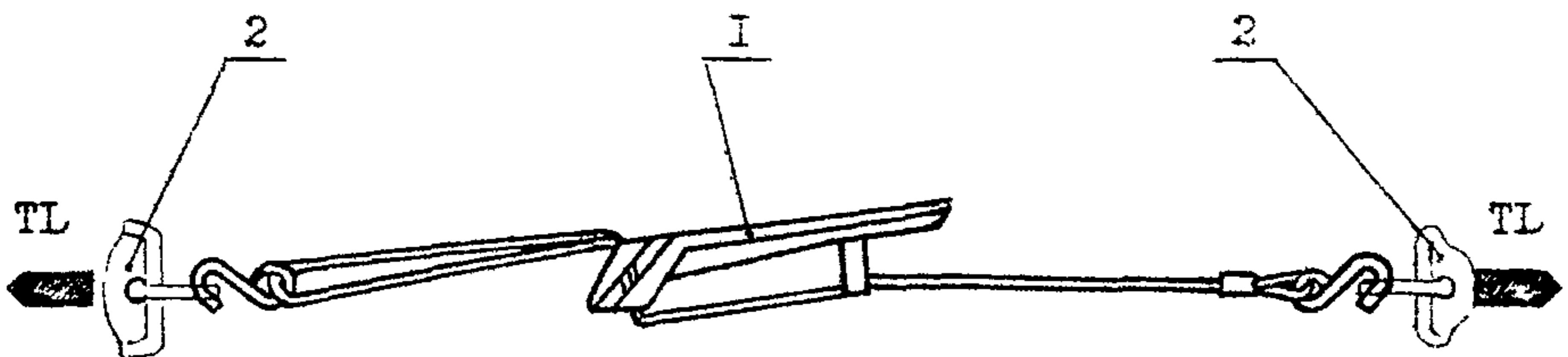
I-устройство для крепления автомашин, 2-элементы стендса
