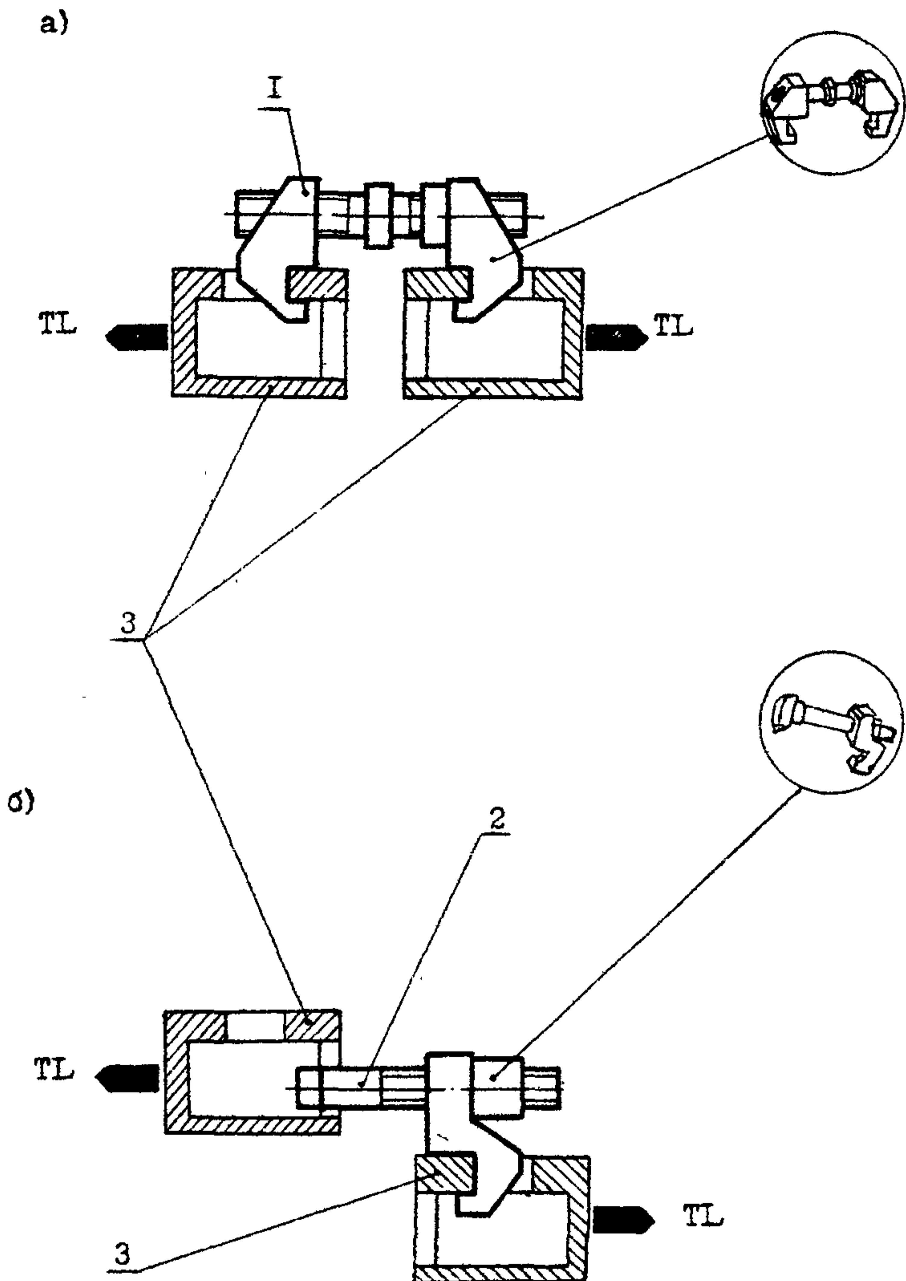
1-стяжка винтовая, 2-стяжка винтовая для разновысотких контейнеров, 3-элементы Стенда
