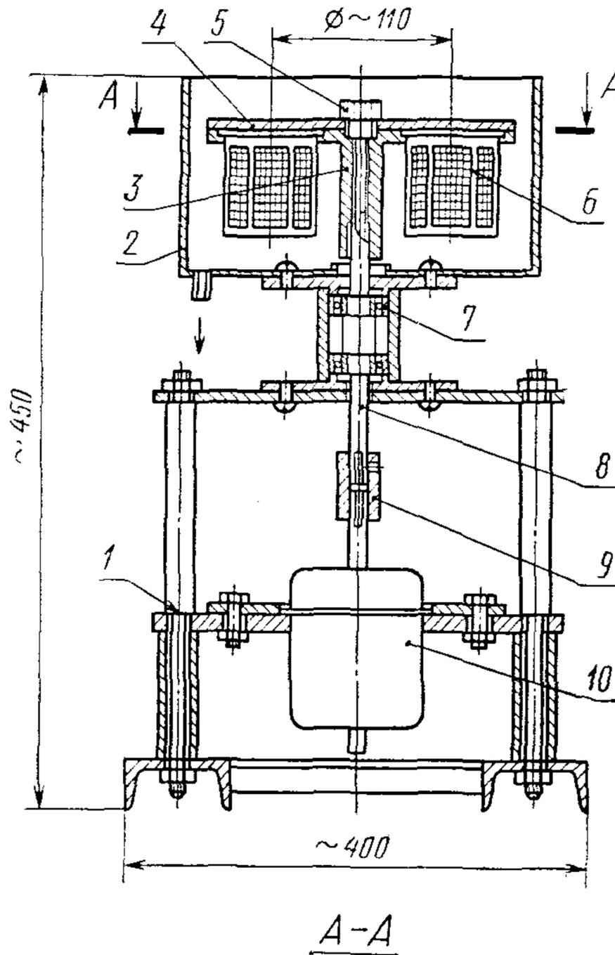
1 — рама; 2 — кожух; 3 — держатель корзинок; 4 — крышка; 5 — прижимной болт; 6 — корзинка; 7 — узел подшипника; 8 — вал; 9 — муфта; 10 — электродвигатель постоянного тока СЛ-369 У/А.
