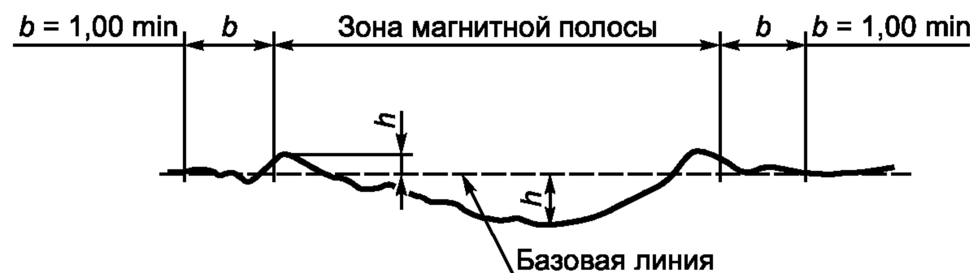
Рисунок 8 — Вогнутый профиль полосы
