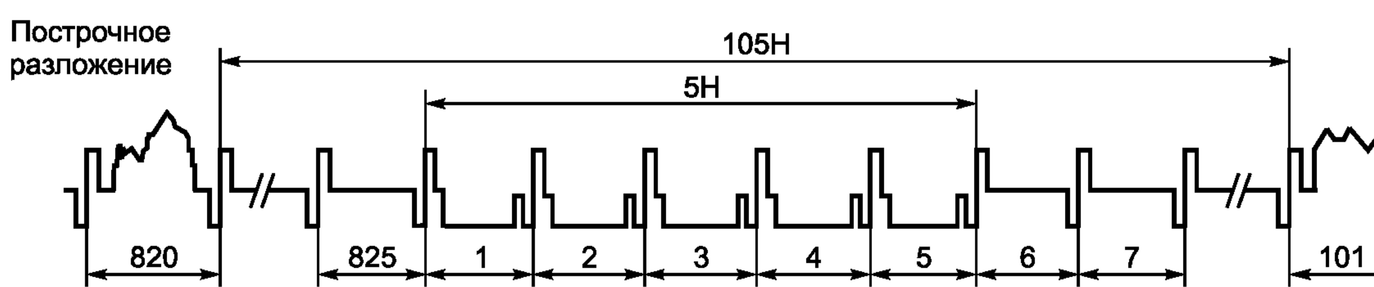
Рисунок 3 — Структура синхросигнала на интервале гашения поля
