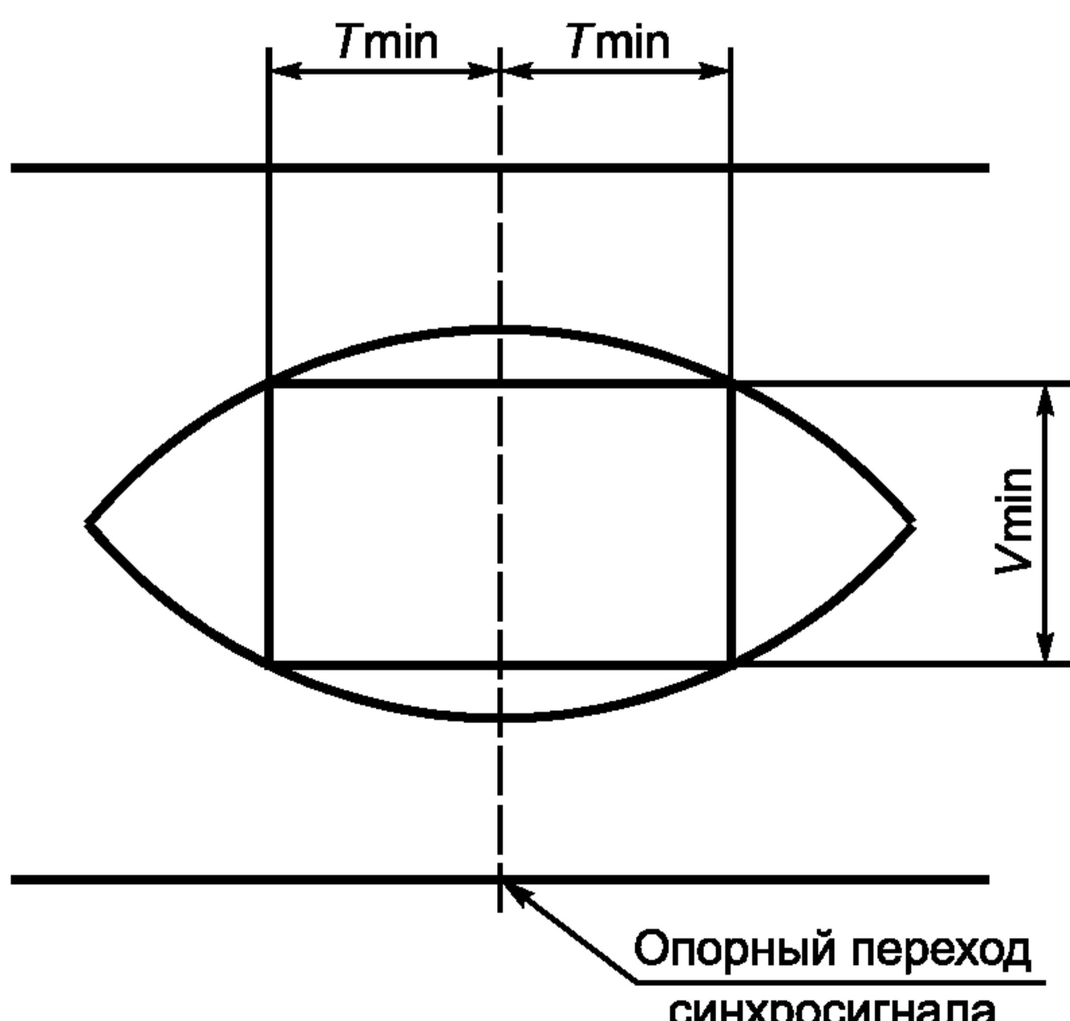
Примечание — Ширина окна глазковой диаграммы, в пределах которого данные должны быть правильно детектированы, включает в себя фазовое дрожание тактовой частоты ± 0,4 T, синхронизацию данных ± 0,075 T и скос за счет распространения в проводящих парах ± 0,18 T.  $T_{min} = 0,3T$ ;  $V_{min} = 100$  мВ.
