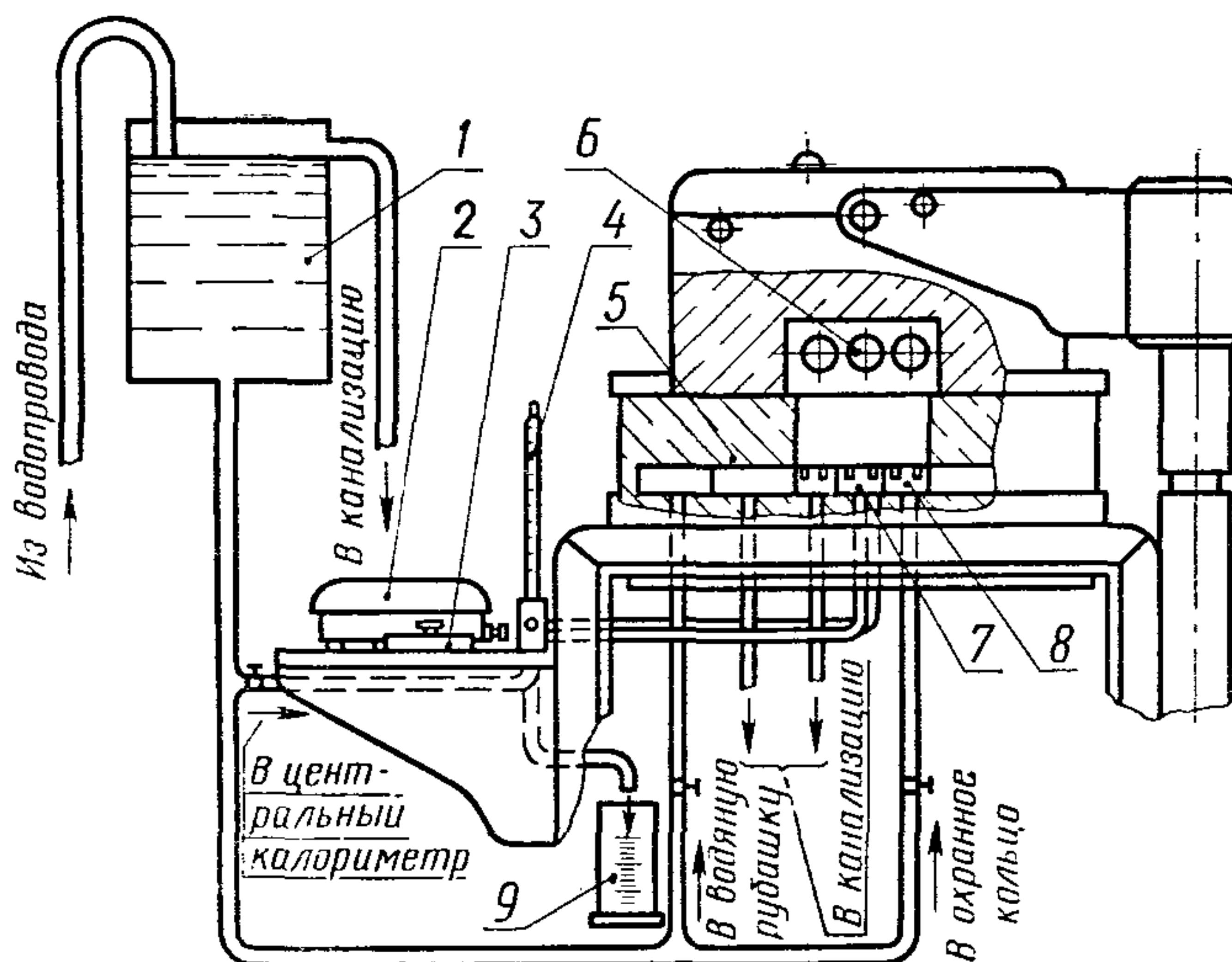
1 — водонапорный бак; 2 — милливольтметр; 3 — переключатель; 4 — термометр Б-IV № 2; 5 — водяная рубашка; 6 — электронагреватели; 7 — калориметр; 8 — охранное кольцо; 9 — измерительный цилиндр.
