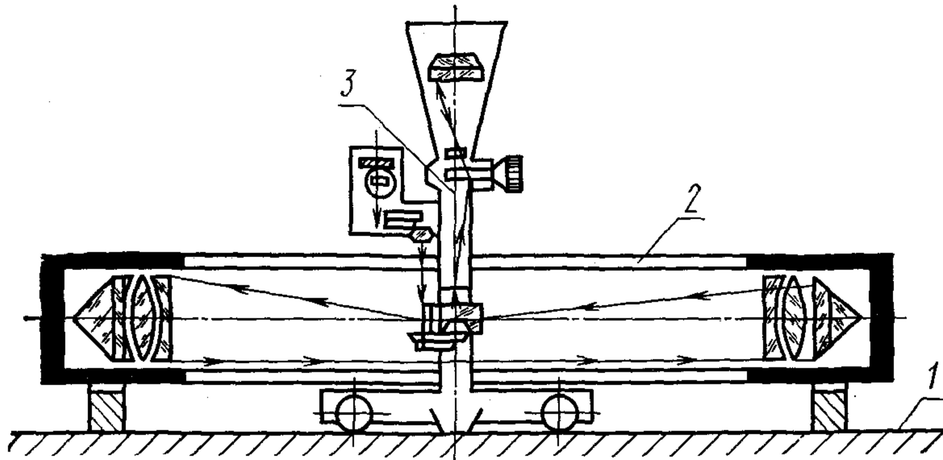
На рабочей горизонтальной поверхности каждой направляющей 1 станины в заданном направлении устанавливают оптическую линейку 2, служащую оптической прямой сравнения, и измерительную каретку 3, оптически связанную с линейкой.
