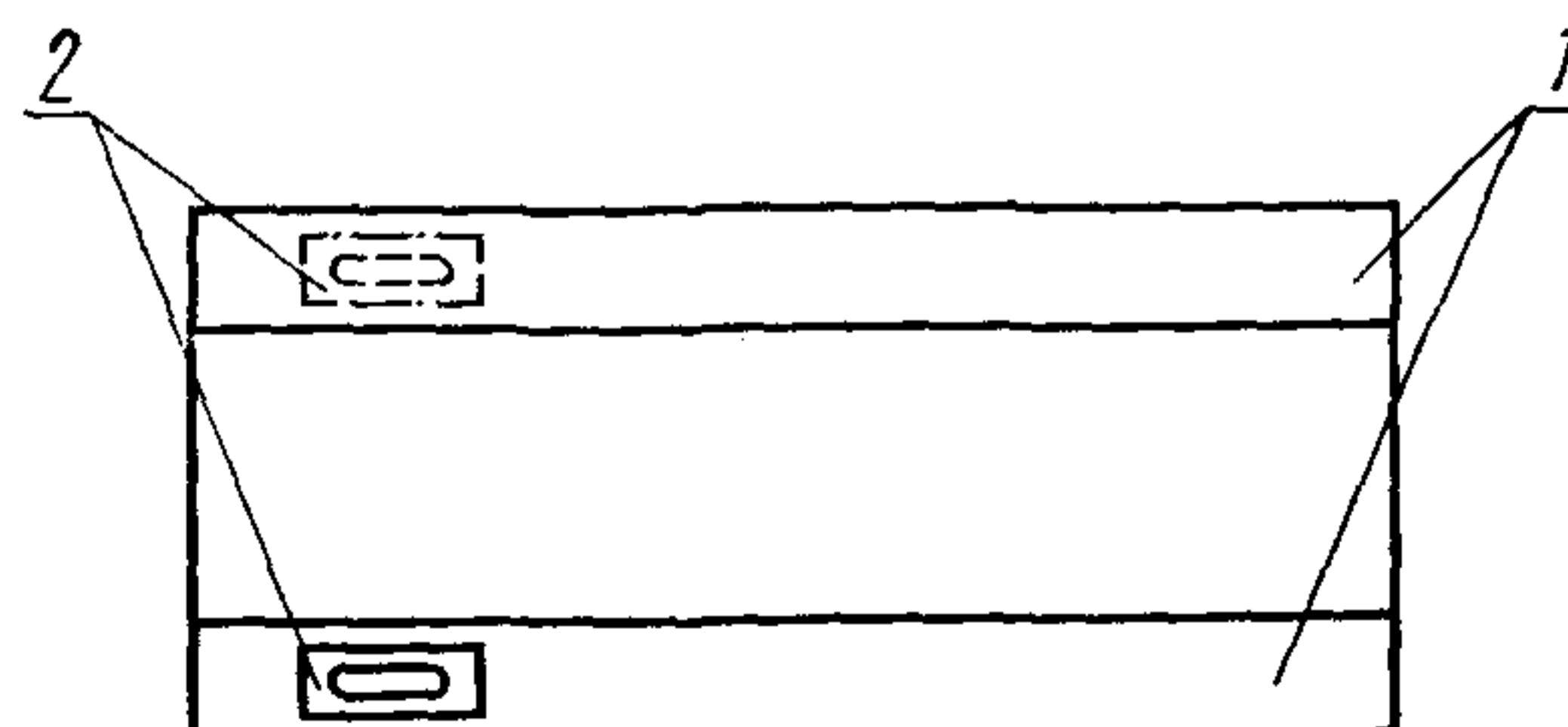
На рабочей горизонтальной поверхности направляющей 1 станины в заданном направлении устанавливают уровень 2.
